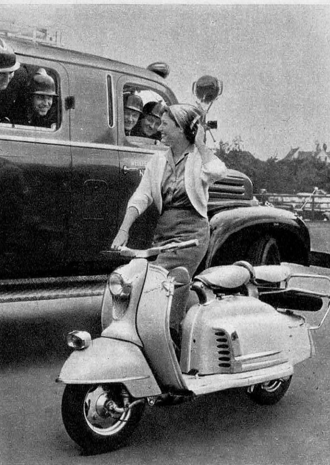
← Les prima NSU, « 3 étoiles » et « 5 étoiles », sont deux scooters de technique et d'aspect bien particuliers présentés en 150 et 175 cm 3 . On notera la disposition assez spéciale du cylindre mis à plat et la boîte de vitesse qui fait corps avec le bloc-moteur.
