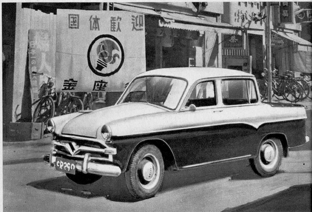
La « Prince Skyline » est la plus moderne des voitures qui soient produites au Japon dans la catégorie 1 500 cm 3 à roues indépendantes, essieu arrière rigide type de Dion, moteur à 7,5 de compression développant 60 ch, vitesse m
