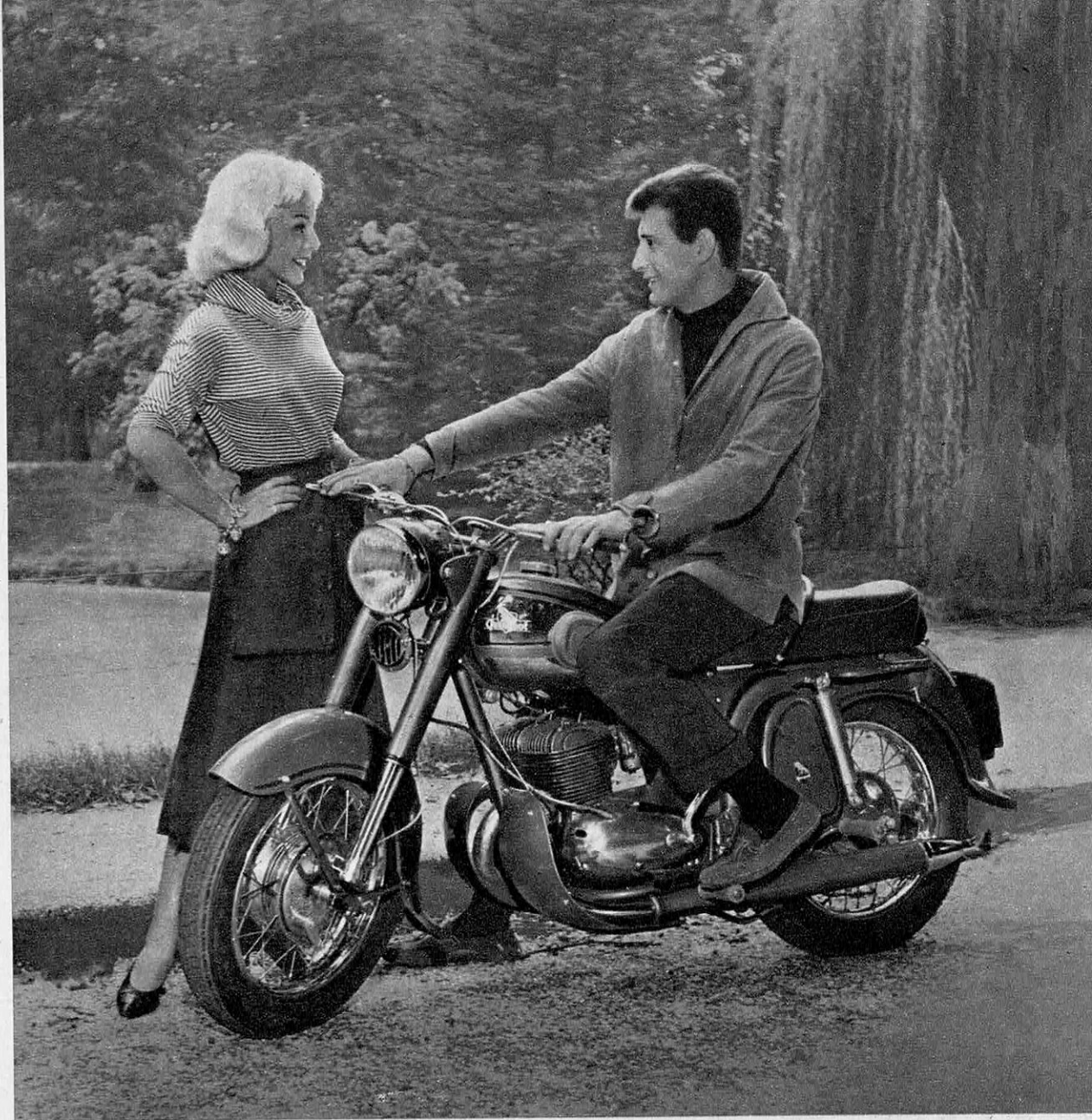
Cette 350 cm 3 Peugeot, type 356 TB, 2 cylindres, 2 temps, à chambres de combustion séparées, extrapolation de la 250 cm 3 de la même marque, convient particulièrement au tourisme en montagne. Avec la 350 cm 3 Motobécane, c'est pratiquement la plus forte moto française.
