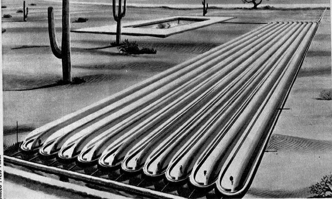
UN DISTILLATEUR SOLAIRE pour l'obtention d'eau douce à partir d'eau saumâtre ou d'eau de mer. Chaque élément mesure 60 cm de large et 30 m de long. La vapeur d'eau se condense sur le film de tétrafluore d'éthylène (téflon) et l'eau douce est recueillie dans le bassin. La batterie fournirait 800 l par jour.
