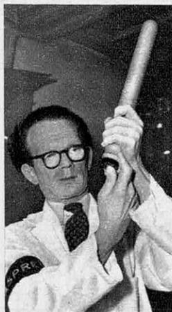
Un petit poste émetteur à transistors dans le manche du « night-stick »; un bouton à presser. C'est la trouvaille d'une société londonienne de surveillance. Ses veilleurs de nuit n'auront plus à manier la matraque en cas de cambriolage. Ils s'en serviront comme antenne: le radiosignal émis est capté et localisé au siège de la société, qui n'a plus qu'à appeler la police sur le lieu ainsi exactement repéré du cambriolage. Riposte possible des cambrioleurs: la radiocassette brouilleuse.
