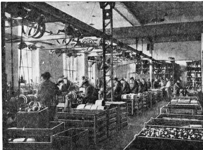
FABRICATION DES USTENSILES DE CUISINE EN ALUMINIUM Vue de l'atelier de repoussage à la manufacture de Tournus.
