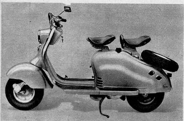
La Lambretta 150 LD, à 3 vitesses, développe 6 ch et autorise une vitesse maximum de 80 km/h. Suspension et transmission sont celles de la 125 LD.
