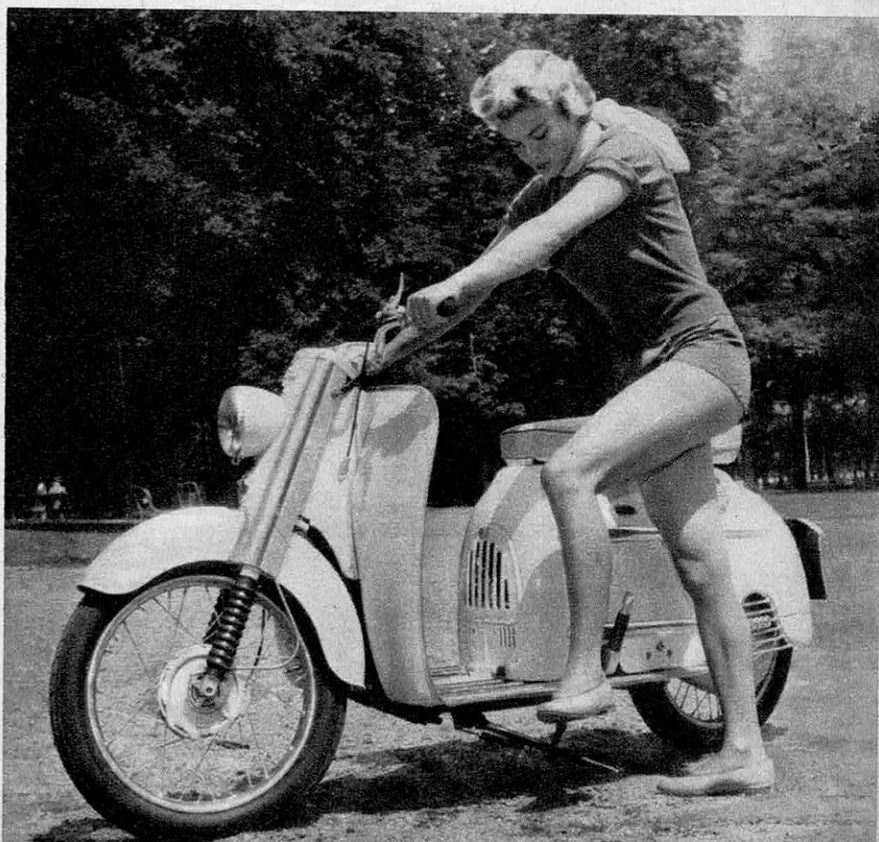
Le Zündapp Bella 200 cm 3 est à selle biplace et suspension oscillante. Le tunnel de refroidissement se voit nettement entre les jambes du conducteur.
