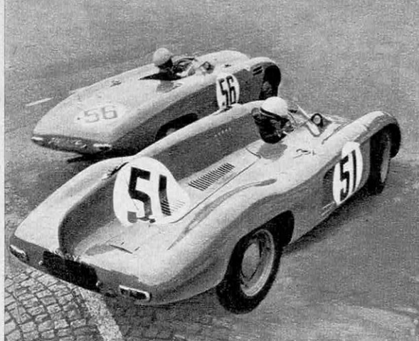
● Deux versions des 750 cm 3 légères DB aux essais : tank à moteur arrière 4 CV Renault modifié (51) et barquette profilée DB Panhard à traction avant (56).
