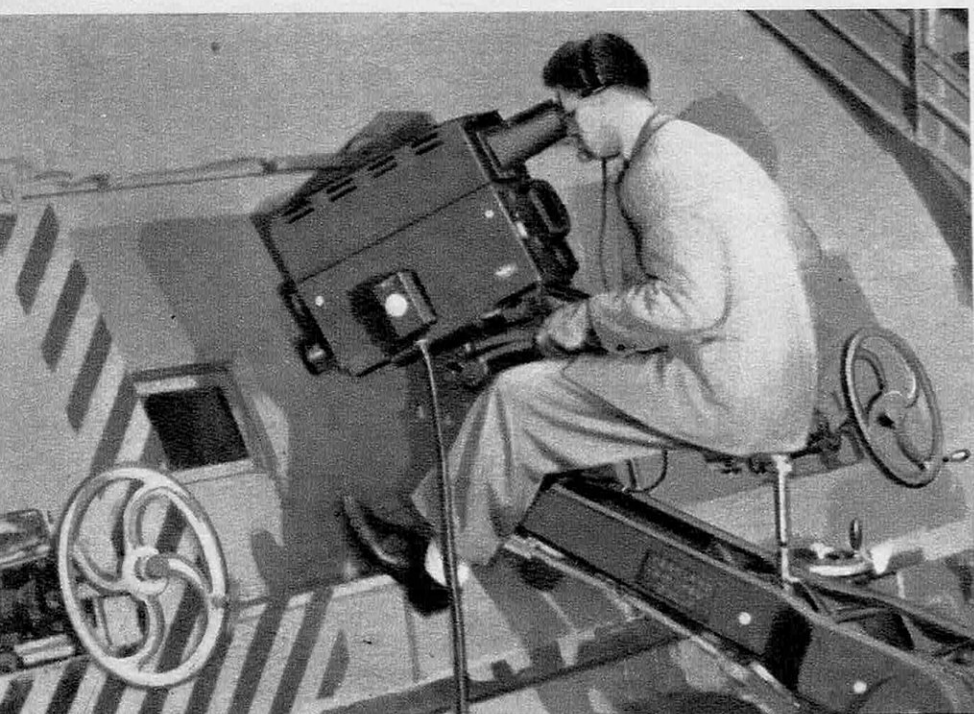
● Par la vitre d'une soufflerie la caméra observe le jet de gaz d'un réacteur à postcombustion. Un grand nombre d'ingénieurs peuvent suivre les expériences.
