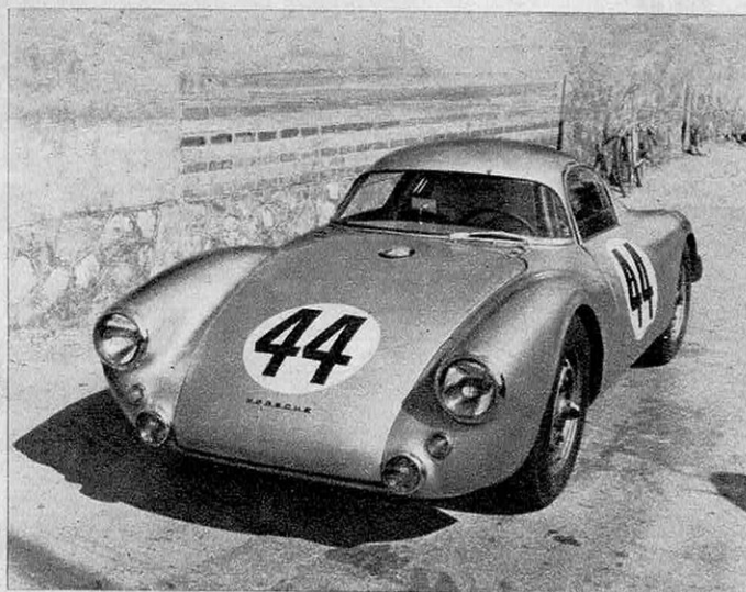
● La tenue de route des prototypes Porsche a été sensiblement améliorée en plaçant le moteur devant l'essieu arrière. Très basses, ces voitures tournèrent sans aucun incident à plus de 138 km/h.
