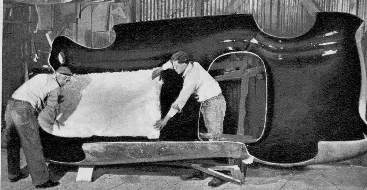
L'APPLICATION DU TISSU DE VERRE SUR LA FORME EN CREUX D'UNE CARROSSERIE ROADSTER.
