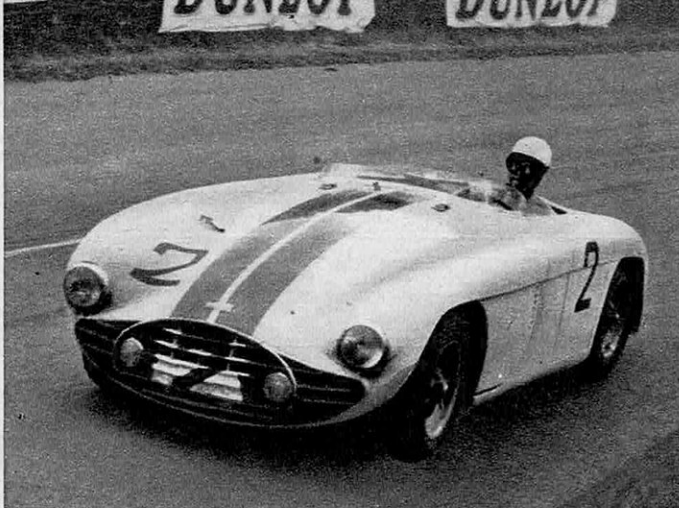
● La nouvelle Cunningham, type C5R, qui fut l'une des voitures les plus remarquées, possédait un châssis apparenté à celui des Kurtis-Kraft. Elle atteignit la vitesse de 249 km/h en ligne droite.
