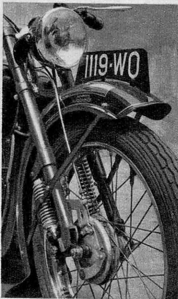
● La suspension avant oscillante à roue poussée due à Grégoire comporte deux ressorts dissymétriques.
