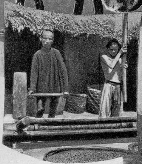
● Une presse primitive pour l'extraction de l'huile dans le Tonkin.
