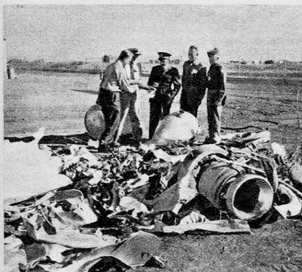
● L'examen minutieux des débris de la fusée fournira des renseignements sur le comportement de ses divers organes et suggérera les améliorations à y apporter.
