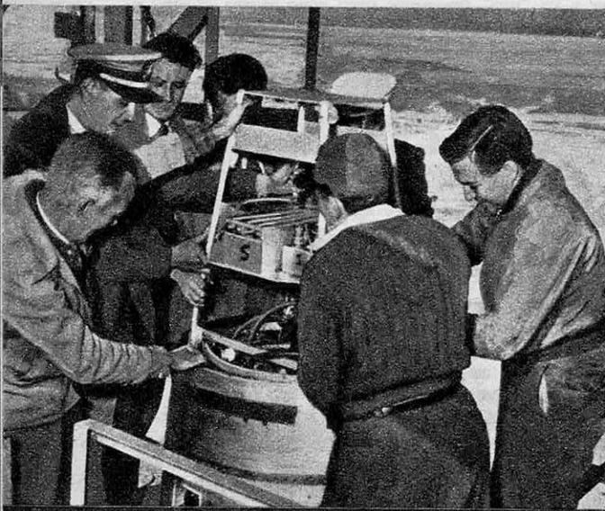
● A bord du navire américain « Norton Sound », des techniciens mettent en place les instruments d'exploration de l'ionosphère qu'emportera une fusée « Viking ».
