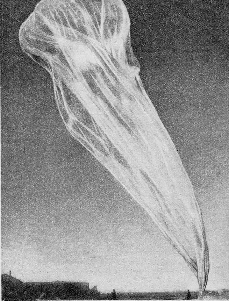
● Lancement d'un ballon sonde à la base de Holloman (Nouveau Mexique). L'enveloppe en matière plastique n'est qu'à demi-gonflée pour permettre l'expansion du gaz.
