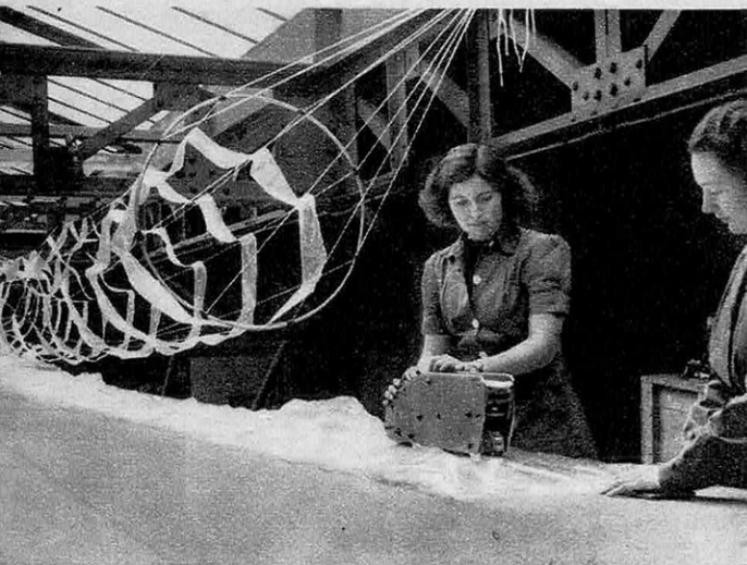
● Ces ouvrières soudent les feuilles de plastique constituant l'enveloppe du ballon. Au-dessus de la table, on voit le dispositif de protection de la manche à gaz.
