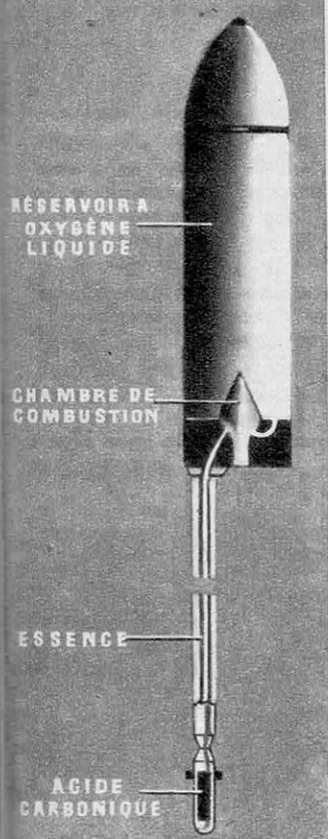
● La chambre de combustion de la Mirak était fortement refroidie par l'oxygène liquide.
