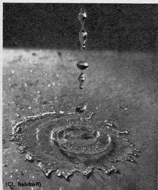
● Photo au 1/30 000 de seconde d'un jet d'eau tombant dans une cuvette. A l'œil le jet semble cylindrique.
