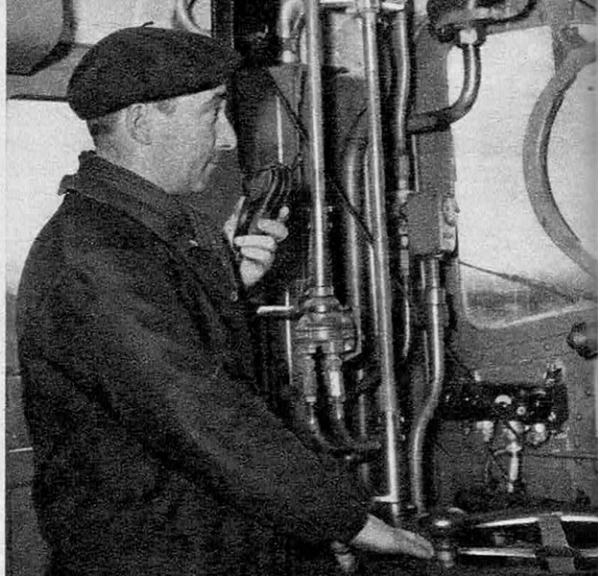
● La machine est équipée d'un bloc émetteur-récepteur alimenté par un groupe convertisseur.
