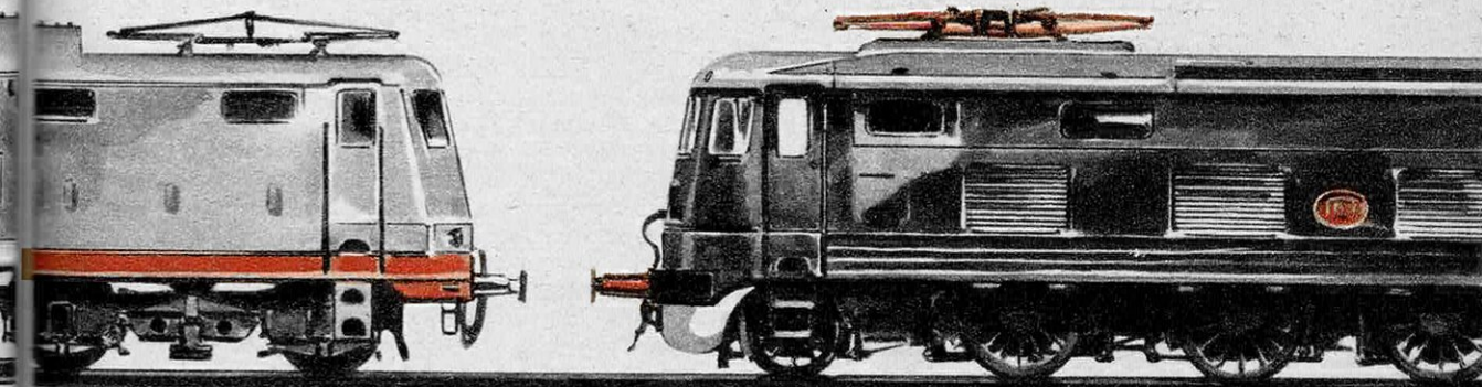
● Locomotive hollandaise 1A B A1 à courant continu. Poids adhérent : 72 t. Diamètre des roues motrices : 1,55 m. Puissance : 4 480 ch. Vitesse : 160 km/h.
