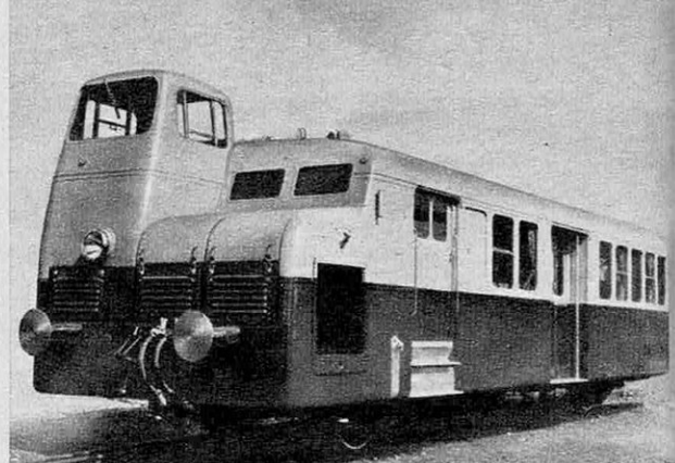
● L'autorail de 80 ch de la S. N. C. F. a deux essieux et peut tirer une remorque à deux essieux. Des capots extérieurs permettent de visiter facilement le moteur.
