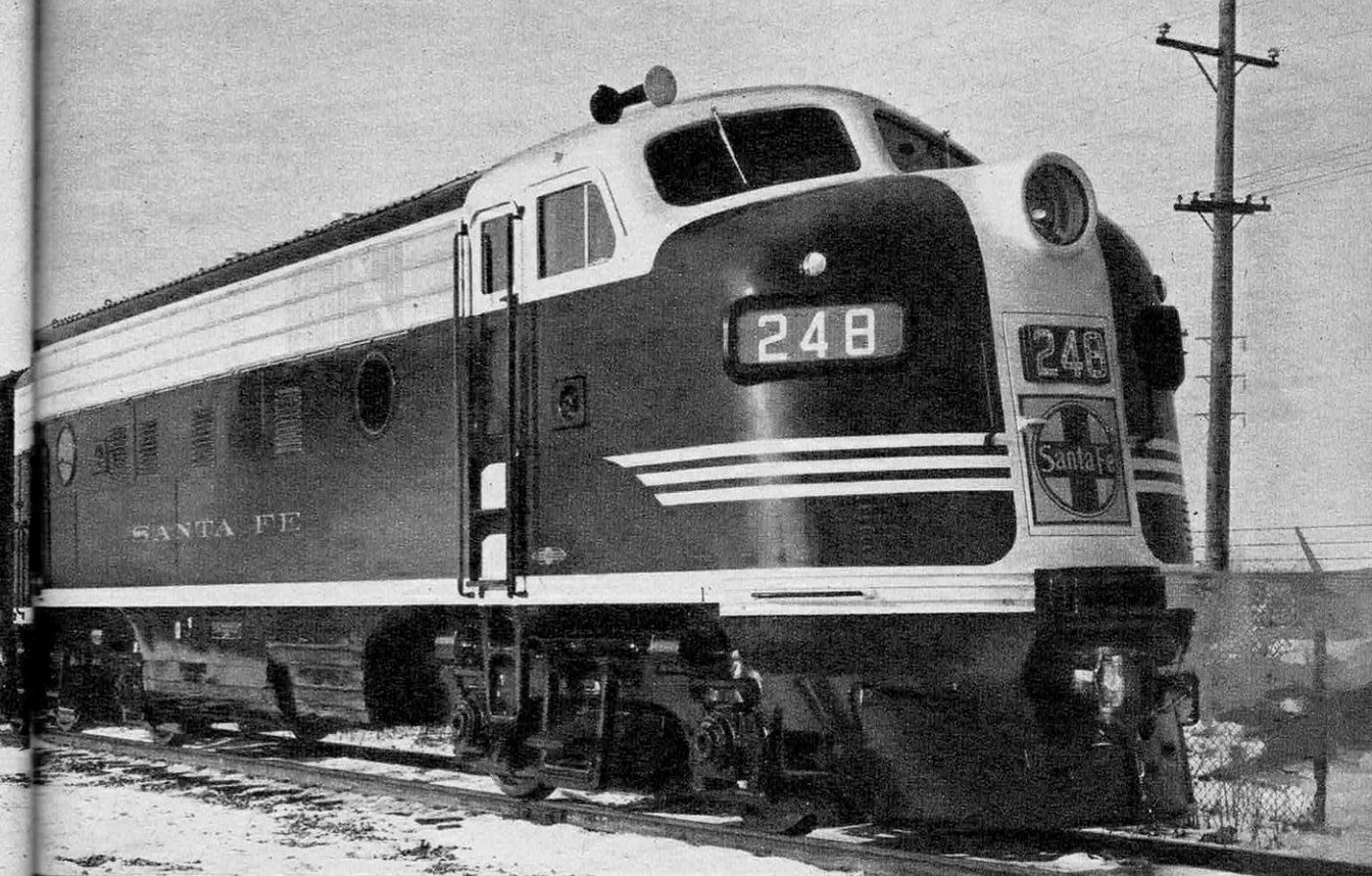
E AMÉRICAINNE (GENERAL MOTORS) FORMÉE DE QUATRE UNITÉS (PUISSANCE TOTALE 6 000 CH) POUR TRAINS LOURDS
