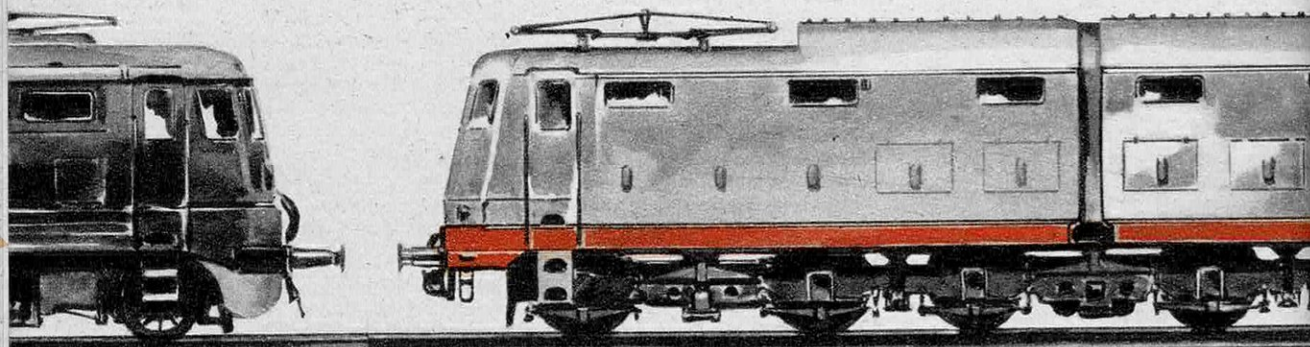
● Locomotive italienne BBB de 3 200 ch à courant continu 3 000 volts, pour lignes accidentées. Elle remorque aussi des trains de 1 500 t en palier.
