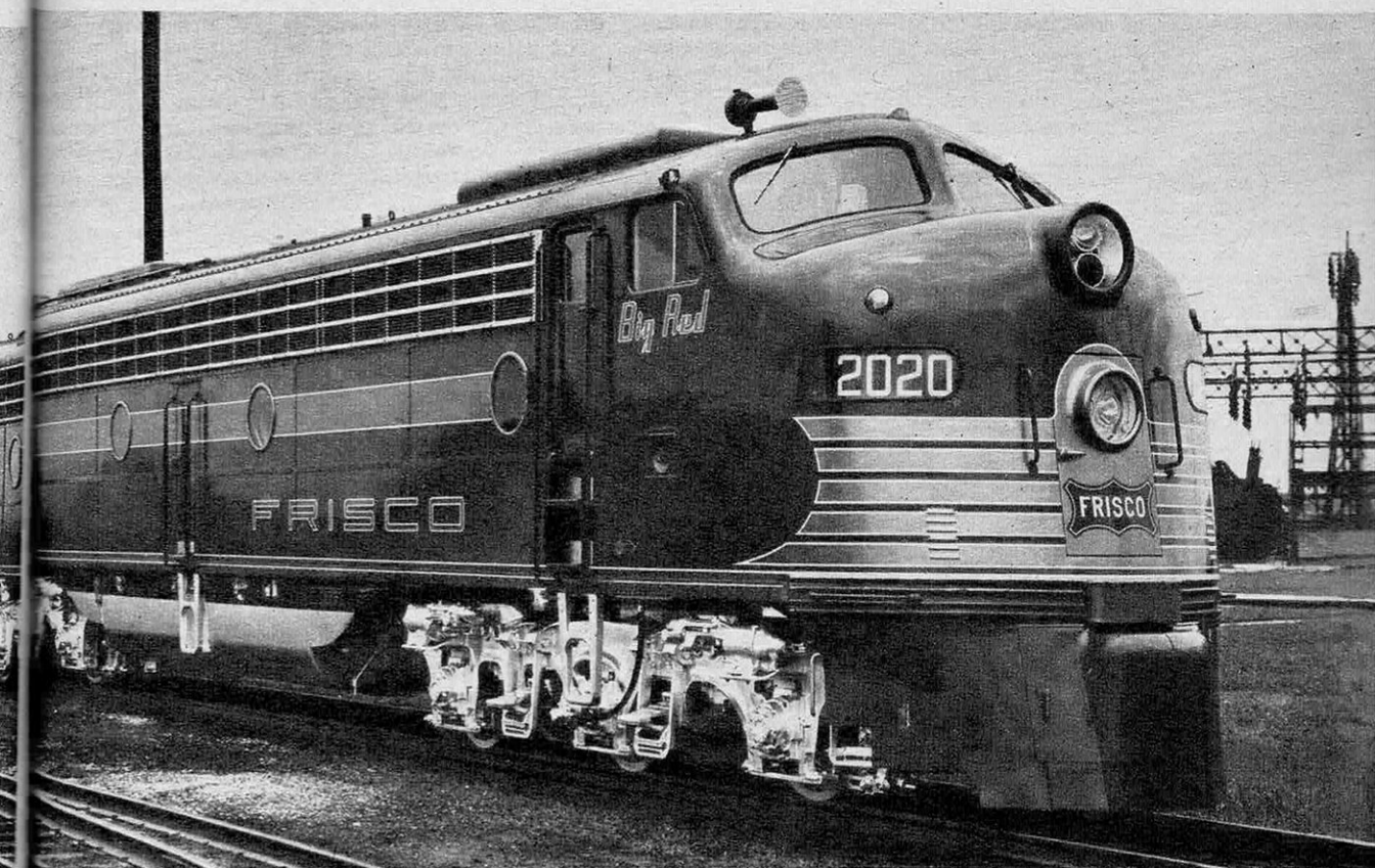
AMÉRICAINNE (GENERAL MOTORS), DE 2 250 CH, POUR TRAINS DE VOYAGEURS RAPIDES. ELLE PEUT ATTEINDRE 180 KM/H.
