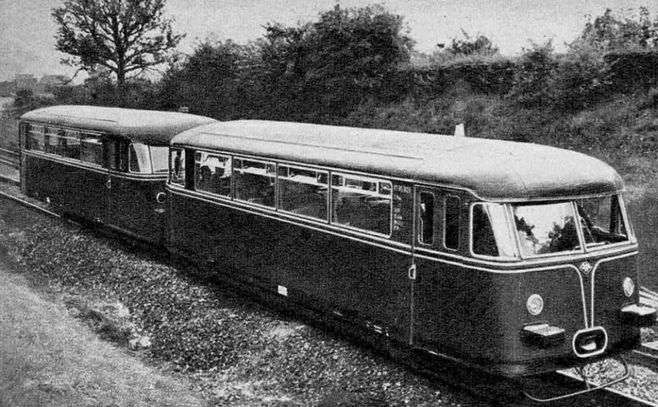
← L'autorail allemand à deux essieux, avec moteur de 110 ch sous la caisse et deux postes de conduite, peut transporter 54 personnes assises. Sa remorque comporte 34 places et un compartiment pour les bagages.
