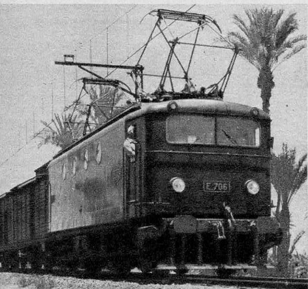
● Locomotive BB de 2 000 chevaux réalisée par Alstom pour les Chemins de fer du Maroc.
