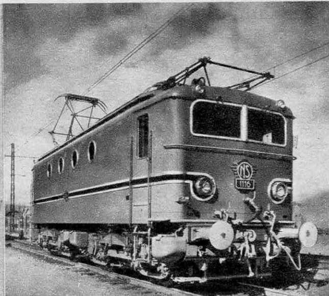
● Locomotive BB construite pour la Hollande par Alstom. Puissance : 2 900 ch sous 1 500 V.
