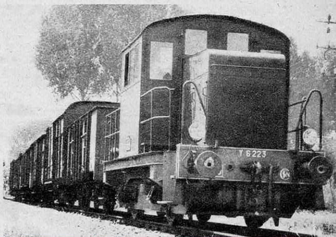
● Le locotracteur 6200 S. N. C. F., de 150 ch, poids 32 t, est très répandu sur l'ensemble du réseau.
