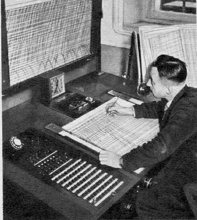
LE RÉGULATEUR DE LA CIRCULATION a devant lui, le graphique théorique et sous sa main le graphique réel ; à gauche, les clés d'appel des gares.
