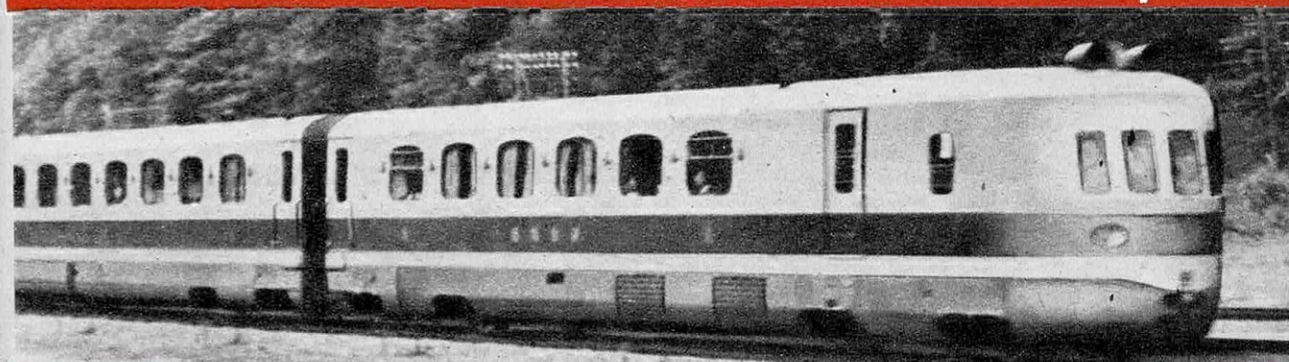
INFÉRIEUR A 22 T ↓ TRAIN AUTOMOTEUR RAPIDE DE 410 CH. VITESSE, 140 KM/H ↑
