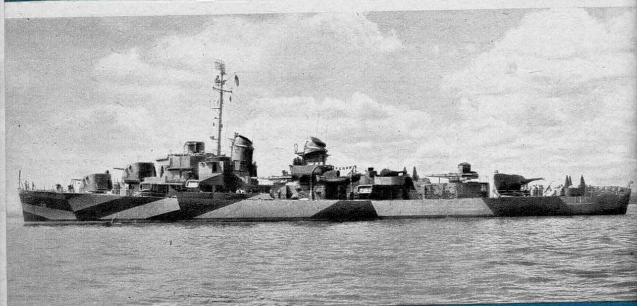
↑ Le « Hank » est un grand destroyer de 2 200 t W. Les U. S. A. envisagent de transformer certains de ces bâtiments en « tueurs » de sous-marins, groupés en formation de chasse autour d'un croiseur et d'un porte-avions léger, et d'en refondre d'autres en « escorteurs » océaniques pour la protection des convois.
