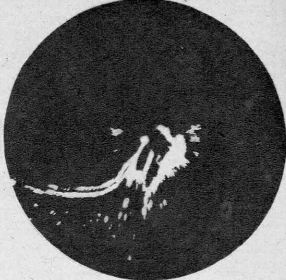
Le port de Douglas (Ile. de Man, G. B.), tel qu'il apparaît sur l'écran cathodique du radar de port et sur la carte. Les navires donnent sur l'écran des taches lumineuses, ce qui permet de les guider malgré la brume (Cossor).
