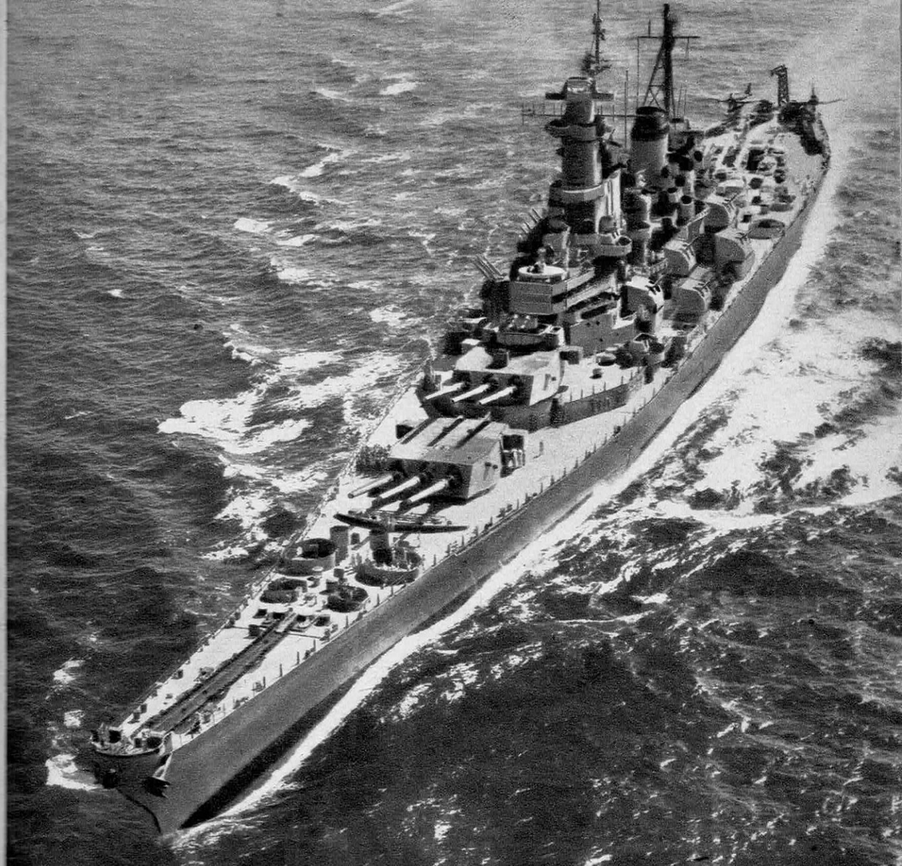
Le Missouri , un des quatre cuirassés américains de 45 000 t W, est armé de 9 canons de 406 en trois tourelles triples, de 16 canons de 127 AA et de 139 canons de 40 et de 20 AA. Propulsé par des turbines développant environ 210 000 chevaux, il peut filer 33 nœuds et son déplacement en pleine charge approche de 60 000 tonnes.
