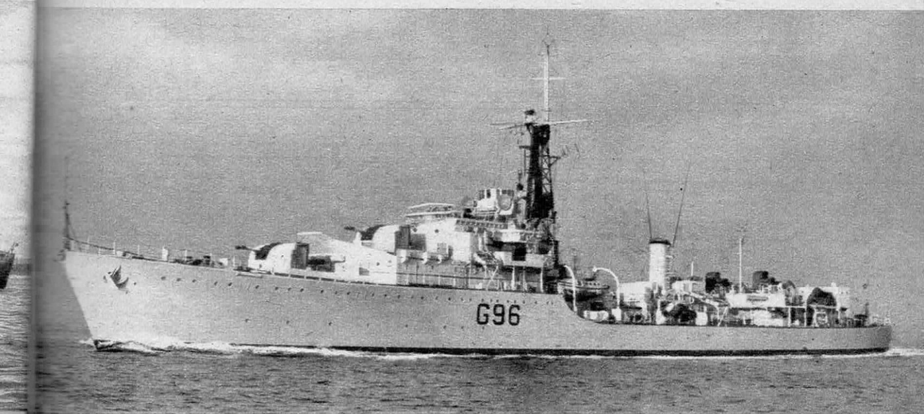
Le « Crossbow » est entré en service en octobre 1948. La cheminée avant est encagée dans le mât treillis apparu dans la marine anglaise depuis 1943 et qui donne aux bâtiments légers de cette flotte une silhouette très particulière. Son armement comprend 4 canons de 102, 6 canons de 40 AA et 10 tubes lance-torpilles.
