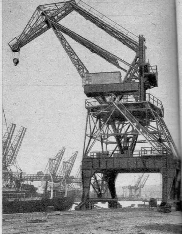
Une grue électrique, capable de soulever un chargement de 20 tonnes, sur un quai du port de Rouen.
