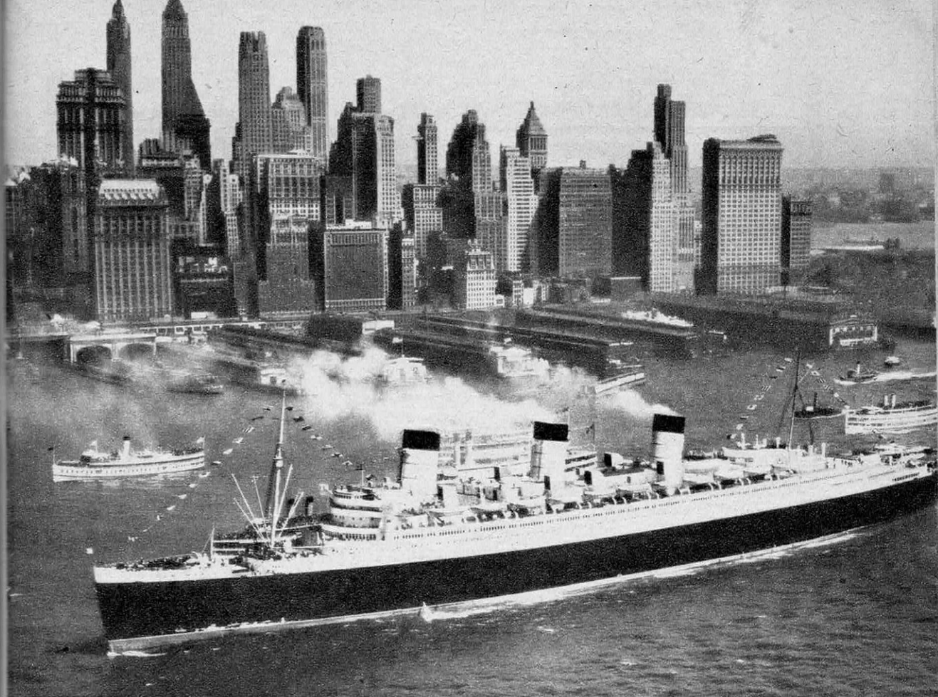
La QUEEN MARY (81 000 tx, 28 nd en service), comme la Queen Elizabeth (83 000 tx), est propulsée par des turbines à engrenages montées sur quatre lignes d'arbres et développant une puissance totale de 200 000 ch.
