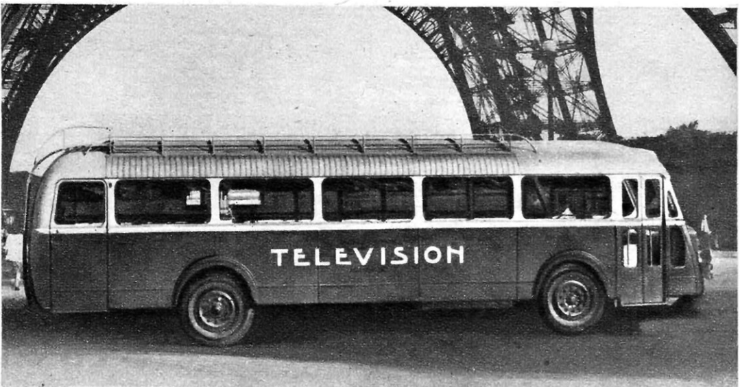
Le car de reportages de la Télévision française portant le matériel mobile de prises de vues et de son.
