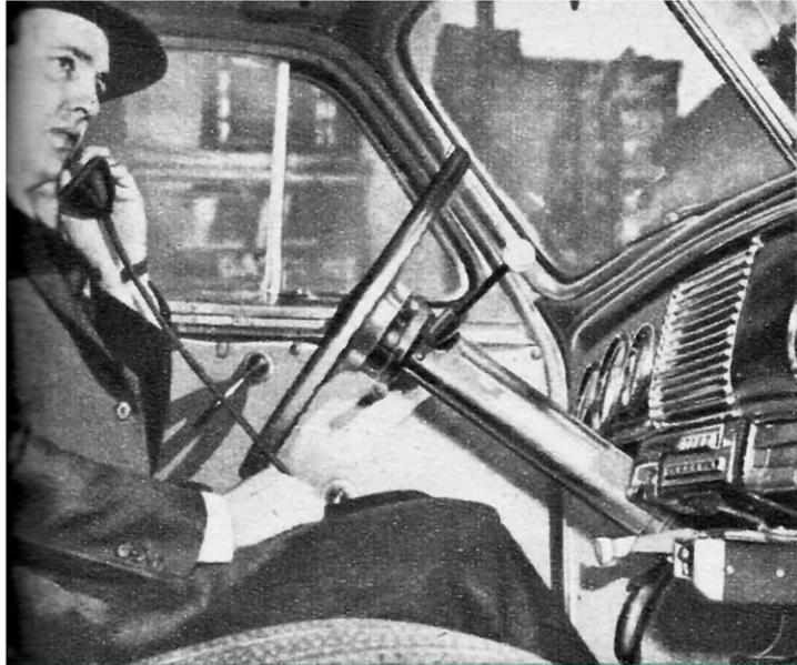
UNE CONVERSATION TÉLÉPHONIQUE À PARTIR D'UNE AUTOMOBILE Le logement du combiné téléphonique et le dispositif d'appel sont placés sous le tableau de bord de la voiture (Western Electric).
