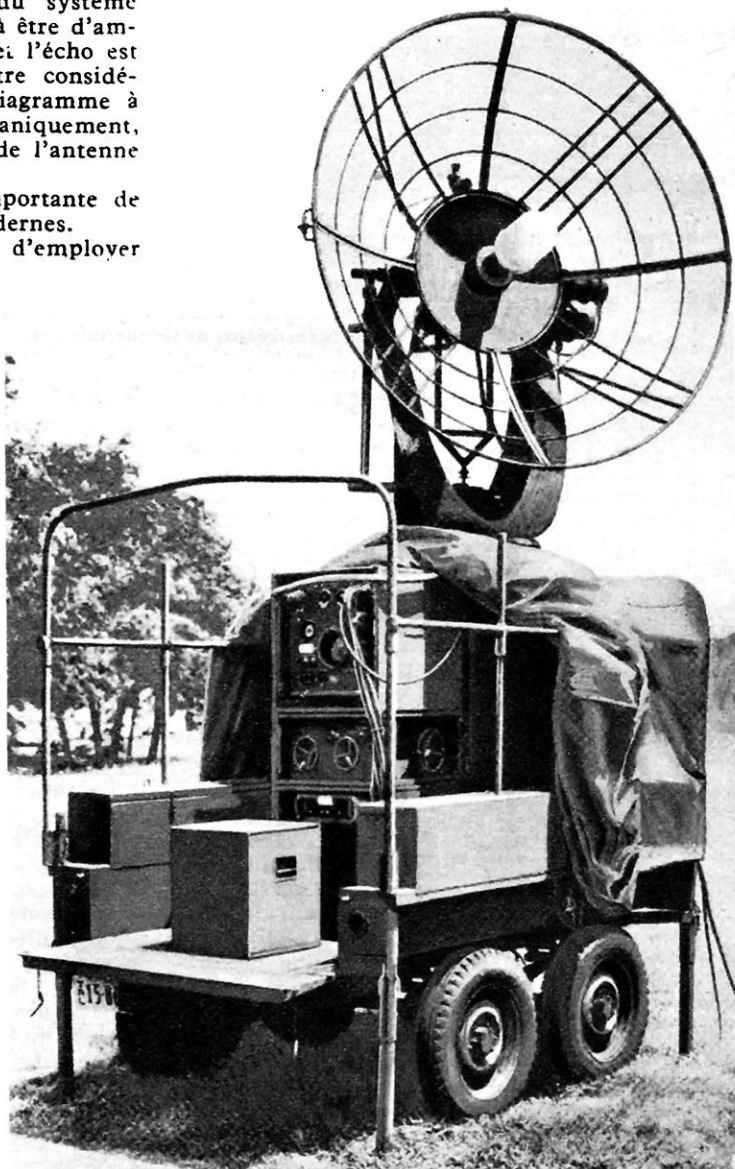
Équipement mobile de radar, Mark 20, fonctionnant sur 1000 mégacycles (30 cm de longueur d'onde), utilisé pour la commande des projecteurs.
