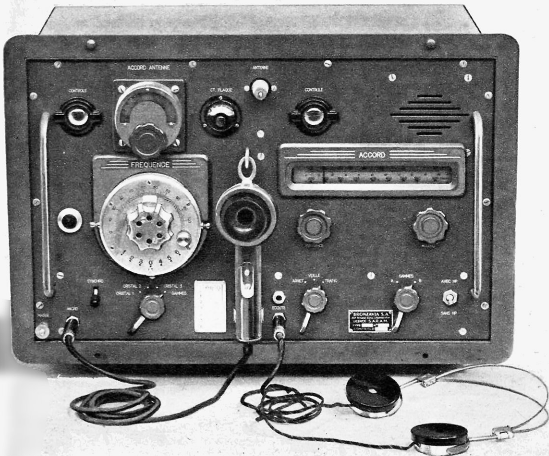
LE POSTE ÉMETTEUR-RÉCEPTEUR DE 40 W S.A.R.A.M., 5-25 POUR NAVIRES DE FAIBLE TONNAGE Ce poste fonctionne en téléphonie comme émetteur-récepteur dans la gamme 100-200 m, et comme récepteur seulement dans la gamme 200-600 m. On aperçoit à gauche le bouton qui permet de choisir pour l'émission l'une des 6 fréquences prérepérées, et sur le manche de l'écouteur la pédale qui commande le passage de la réception à l'émission et que l'opérateur presse pour parler ou pour écouter.
