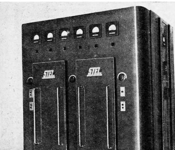
Face avant d'un générateur à induction de 20 kilowatts pour la trempe superficielle (STEL).
