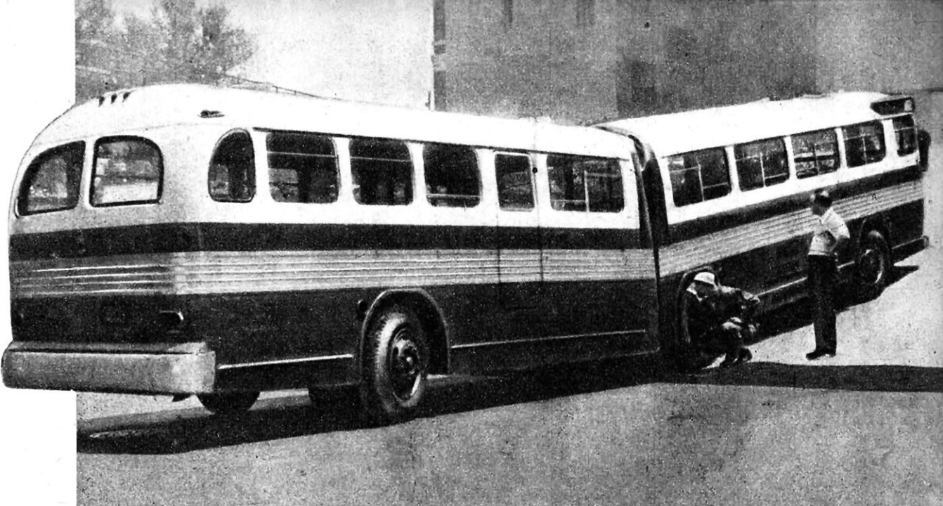
Autocar américain articulé TWIN-COACH. La partie avant est motrice et la partie arrière est une semi-remorque reposant sur l'arrière de l'élément moteur. La liaison centrale est élastique.
