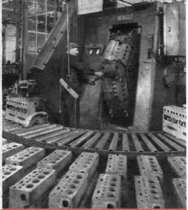
Régie Renault : fraisage continu des blocs cylindres sur machine spéciale à plateau vertical.
