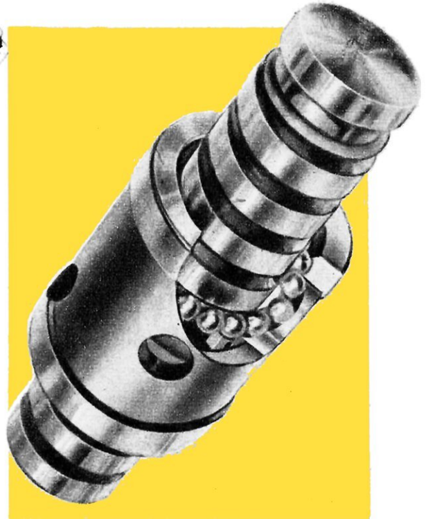
Détail de la direction de camion Berliet (licence Mill) : vis à écrou et circulation de billes.
