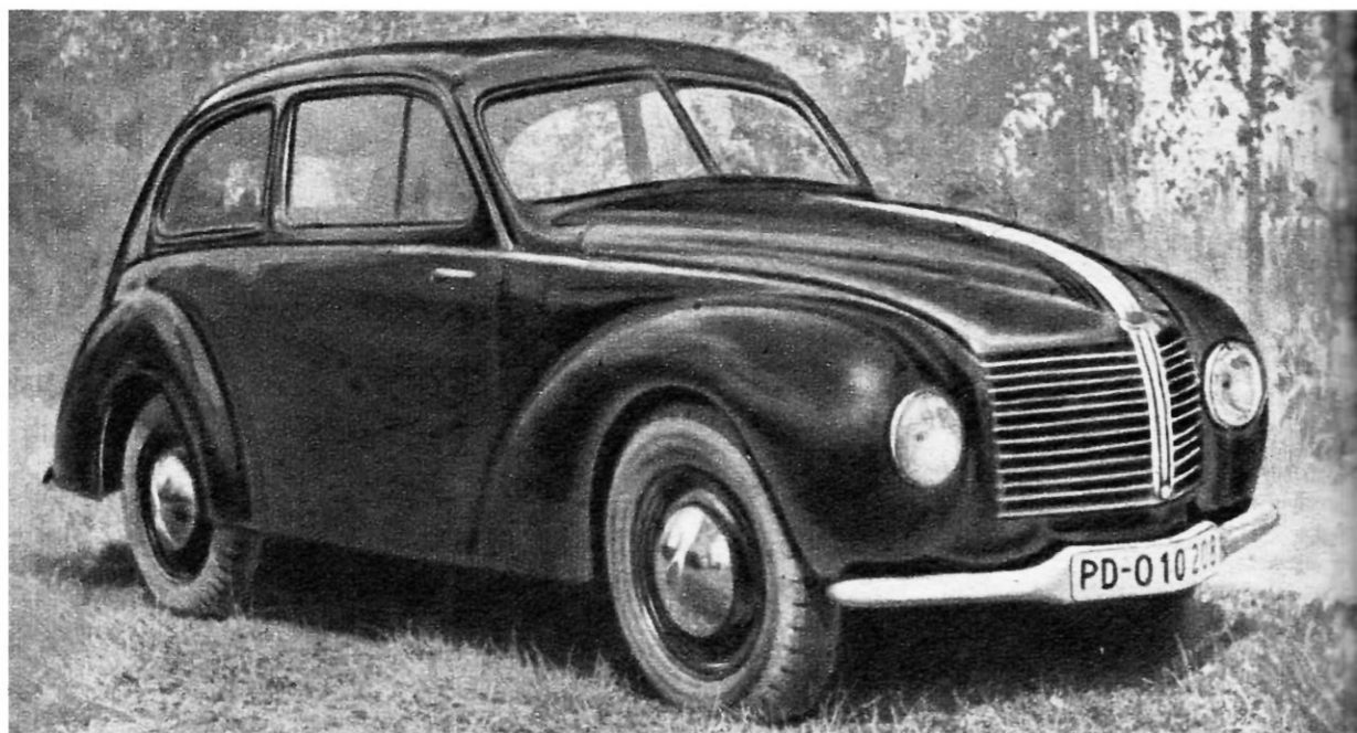
MINOR « 2 ». CONDUITE INT. 2 PORTES, 2 CYL. EN LIG., 70 x 80 MM, 615 CM 3 , 2 TEMPS. VIT. MAX.. 95 KM/H.
