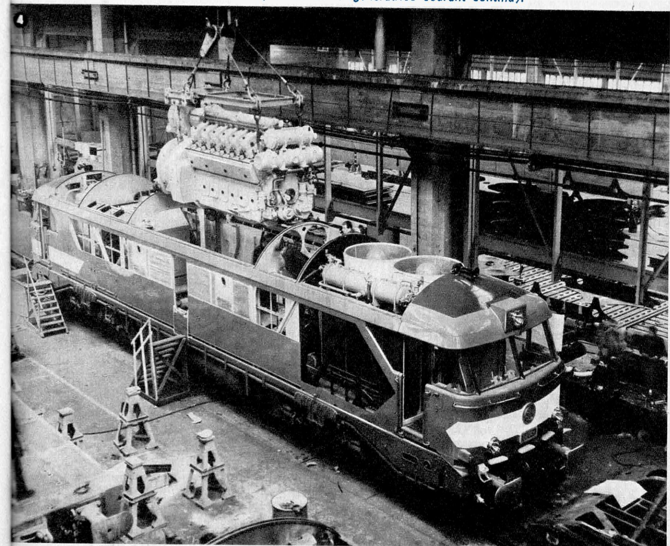
1 - groupe électrogène de la CC 72 000 : moteur SACM, V 16 à 50°, injection directe, 3 600 ch, 22 ch/l + alternateur ; 2 - groupe électrogène de la BB 67 000 : moteur SEMT V 16 à 90°, préchambre, 2 400 ch, 26,5 ch/l + génératrice courant continu ; 3 - moteur de la CC 72 075 : V 12 SEMT à 60°, injection directe, 4 200 ch, 19,6 ch/l ; 4 - Installation du groupe électrogène à bord d'une A1A A1A 68 000 (V 12 à 50°, 2 700 ch + génératrice courant continu).
