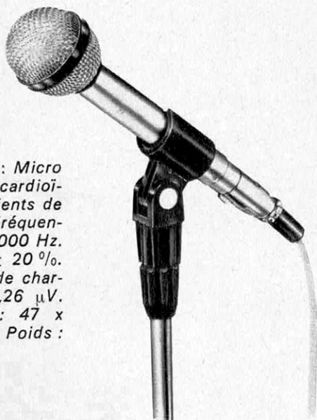
SHURE 548 S : Micro unidyne possédant la suppression du feed-back et des « booms ». Convient pour la voix et la musique. Cellule renforcée. Gamme de fréquence : 40 à 15 000 Hz. Impédance : basses, 57 dB ; 0,131 mV/ \mu bar. Hautes : — 55 dB ; 1,75 mV/ \mu bar.
