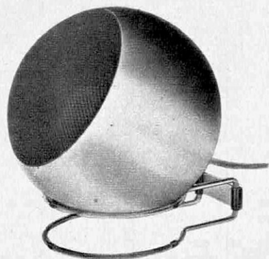
ENCEINTE GRUNDIG « HI-FI BOX 210 » : Forme sphérique ; 1 HP grave, 1 tweeter à calotte hémisphérique. Puissance musicale 20 W, nominale 15 W. Bande passante : 50 à 20 000 Hz. Présentation : grille noir mat, coque en aluminium brossé, socle chromé, hauteur : 19 cm.
