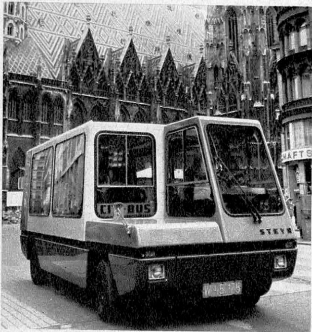
Pour réduire les émissions de « polluants », le Citybus de la firme autrichienne Puch roule au gaz (un mélange butane-propane), et il est, en plus, doté d'un épurateur d'échappement. En France, SAVIEM et Renault ont étudié les possibilités du méthane sur un moteur transformé.
