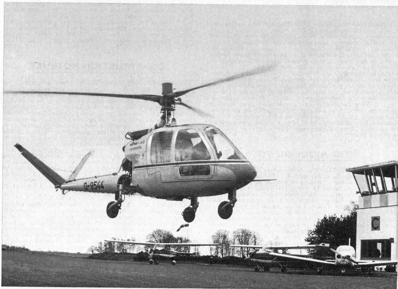
L'éjection de gaz en bouts de pales (dans ce cas, de l'air comprimé) est appliquée sur le petit hé-
