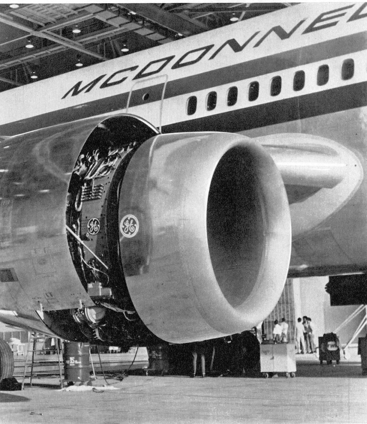
Le CF 6 - 6 D de General Electric (18 t de poussée) : l'ainé d'une respectable famille.
