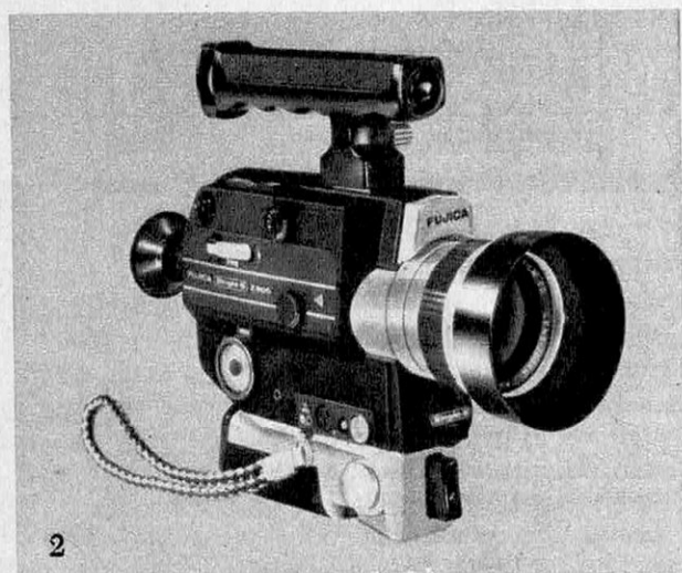
CAMERA SIMPLE 8 FUJI : 1) Fujica ZS 400 : le premier modèle à son optique enregistré dès la prise de vue ; zoom électrique et exposition automatique. — 2) Fujica Z 800 : à prise de son magnétique ; zoom 1,8, 8-64 mm ; 18 à 36 im/s.
