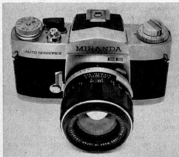
MIRANDA AUTO SENSOREX EE : appareil totalement automatique, la cellule commandant le diaphragme après choix de la vitesse (1-1/1000 s), mesure sélective ou sur tout le champ.
