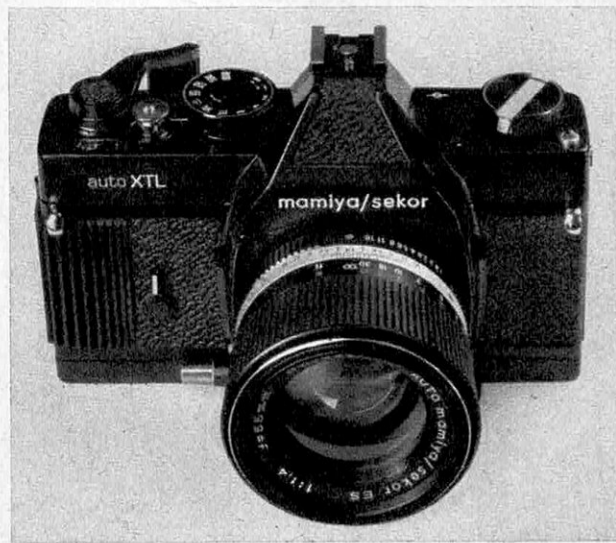
MAMIYA AUTO XTL : 24 x 36 automatique après sélection d'une vitesse entre 1 s et 1/1 000 s ; automatisme débrayable ; mesures spot ou plein champ ; objectifs de 21 à 800 mm.
