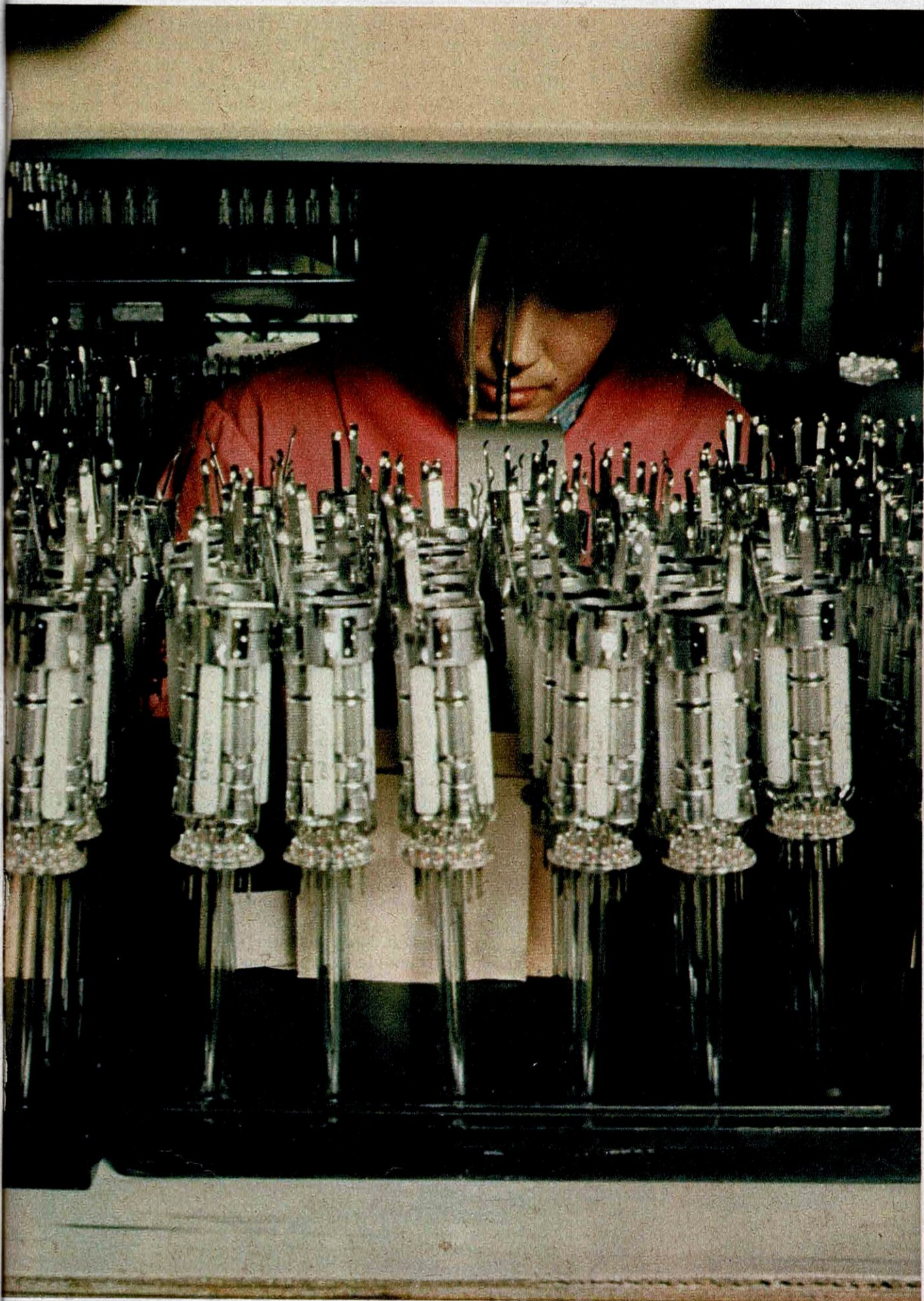
Trois canons à électrons fixés sur un manchon de verre introduit dans le col du tube...
