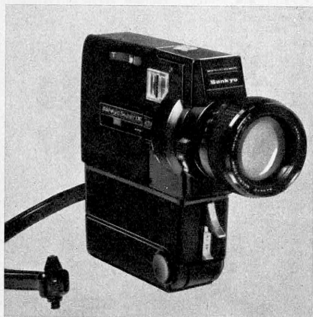
SANKYO SUPER LXL : un zoom macro 1:1,2 et un obturateur travaillant au 1/30 s permettent de filmer en éclairage médiocre sur Ektachrome 160. Réglage automatique de l'exposition.
