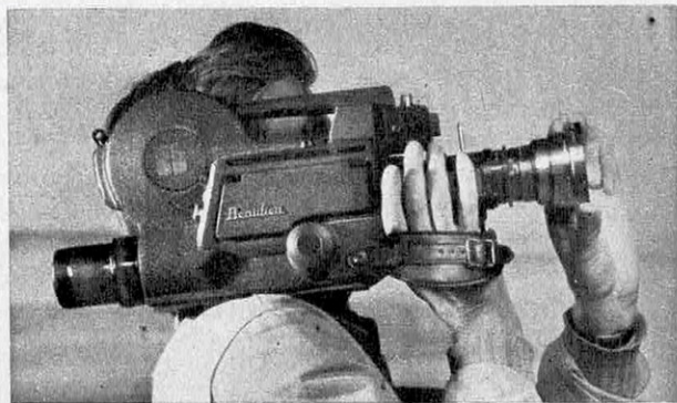
BEAULIEU NEW 16 : caméra 16 mm pour son synchrone, objectifs électriques interchangeables, cellule réglant le diaphragme (12-400 ASA), 12 à 40 im/s ; fonctionne avec des bobines de 60 m.
