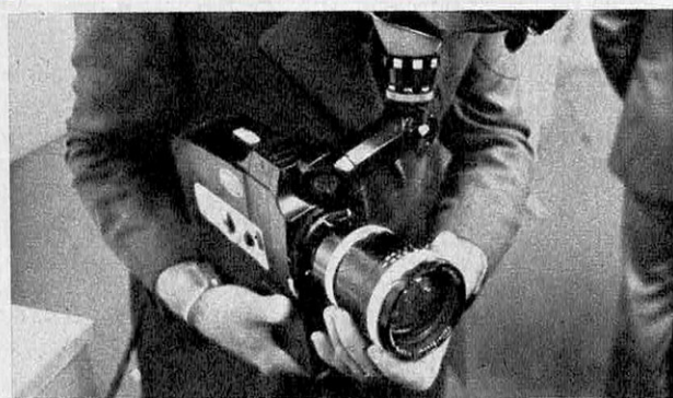
ARRIFLEX 16 SR : caméra 16 mm compacte et silencieuse ; objectifs interchangeables ; exposition automatique de 16 à 500 ASA ; son synchrone : fréquences : 24 ou 25 images/seconde.
