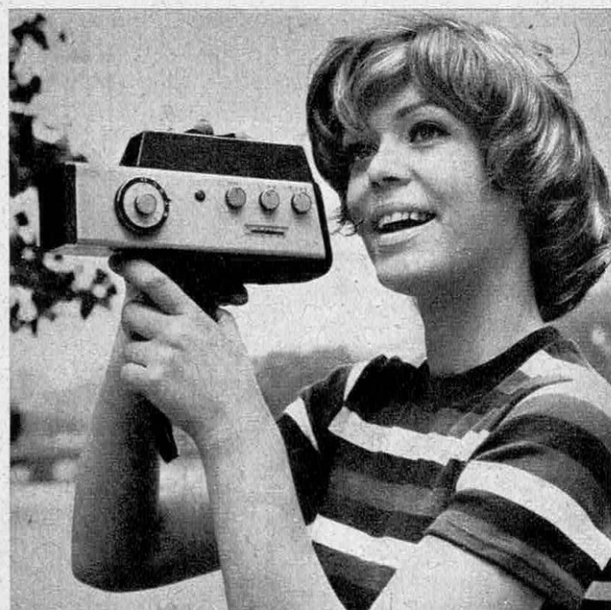
La dernière née des caméras Agfa : la Movexoom 3000. C'est aussi la plus perfectionnée : zoom 7-42 mm électrique et manuel, 9 à 50 images/seconde, diaphragme automatique et minuterie pour cinéma basse fréquence.
