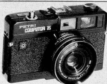
Pétri Computor 35 : 24 x 36 compact à obturateur électronique de 4 s au 1/250 réglé par cellule CdS. Objectif 2,8/40 mm.
