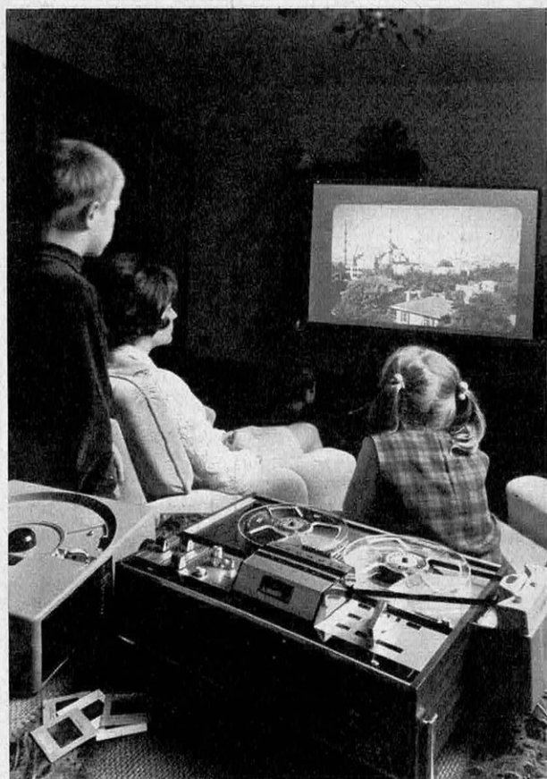
Le simple passage de photos en synchronisme avec le son s'obtient avec magnétophone, projecteur et synchroniseur (ici Sono-Dia-Grundig).
