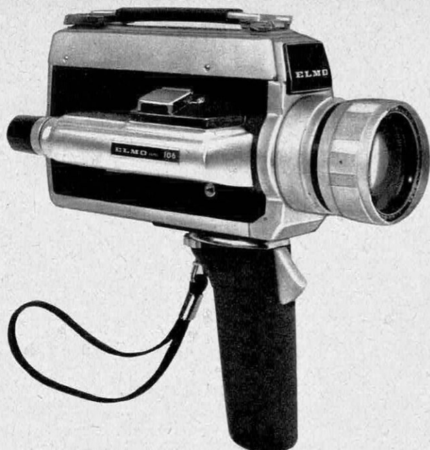
L'Elmo Super 106, une caméra classique : zoom électrique et manuel 8-50 mm, vue par vue, visée reflex, cellule CdS réglant le diaphragme.
