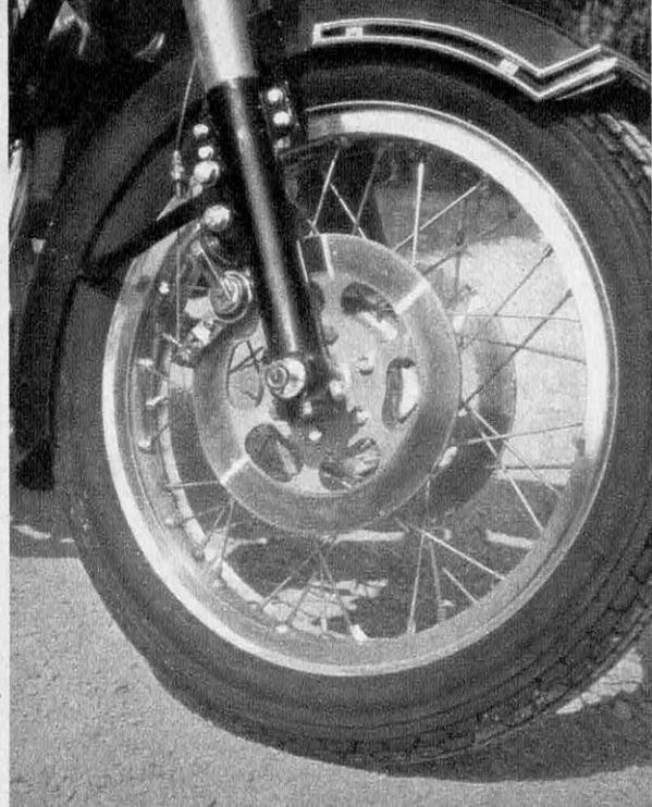
Une tentative de frein à commande mécanique, système Campagnola, monté sur la 600 MV « de transition ». La commande hydraulique est tout de même la seule vraiment valable.
