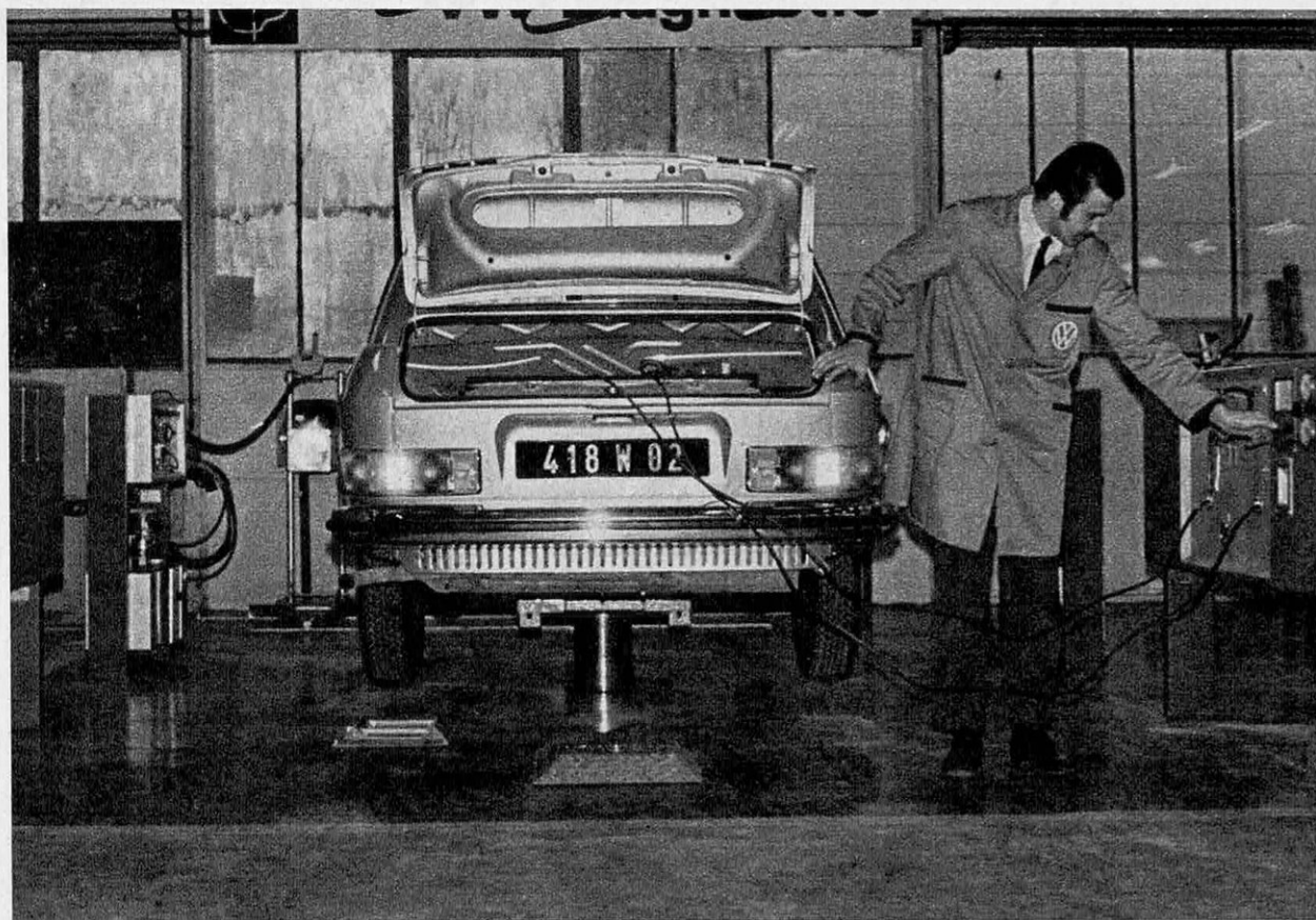
Quelques-uns des éléments d'un centre de diagnostic moderne. L'opérateur est en train de contrôler l'allumage et le régime du moteur. La station complète, assez perfectionnée, est vendue 7 500 francs aux agents Volkswagen.
