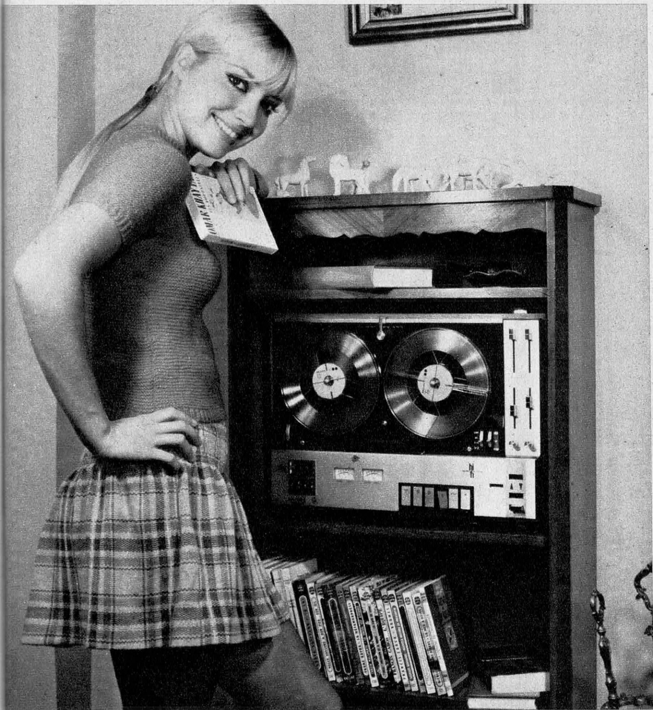
Magnétophone Philips « Stereo » N 4 500, quatre pistes, trois vitesses.
