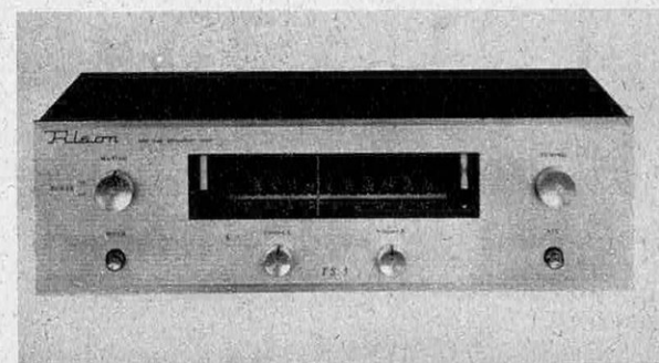
Filson TS 5, sensibilité 1 microvolt
