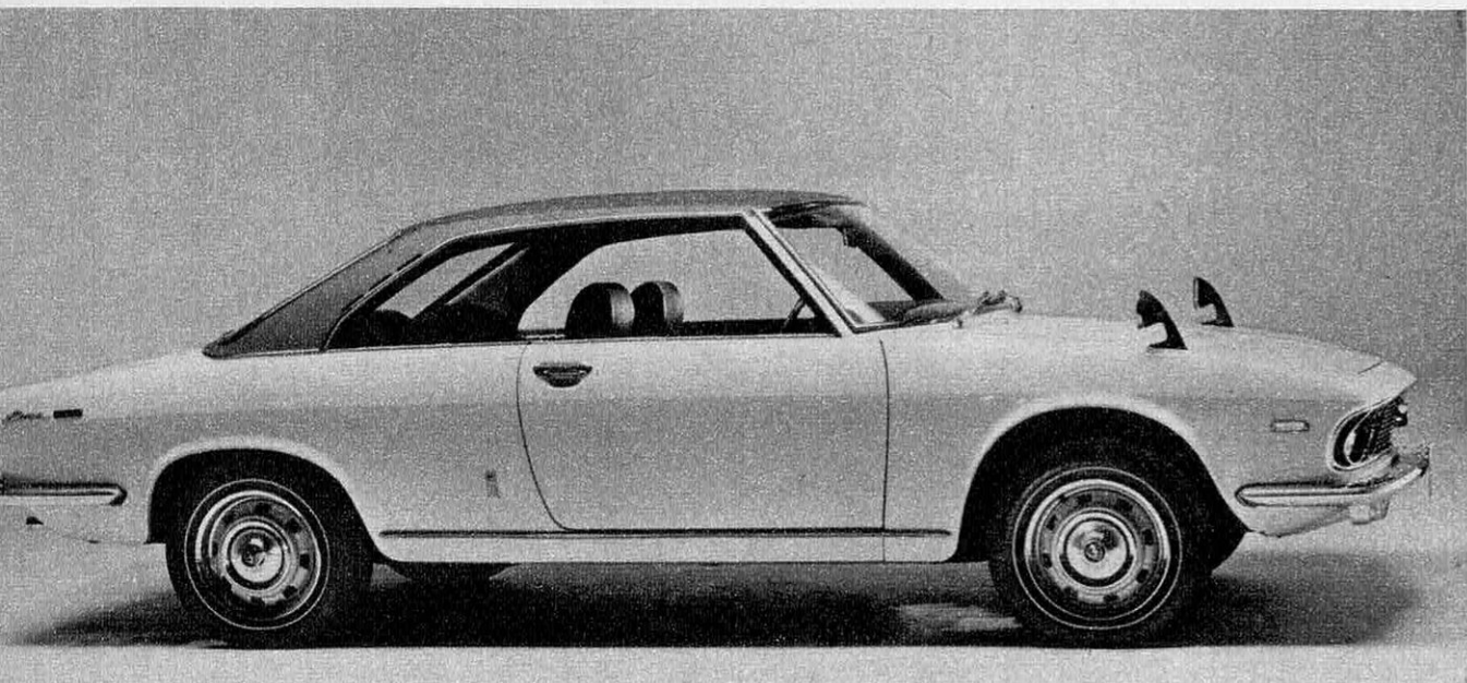
Les Japonais poursuivent activement le développement du moteur rotatif licence Wankel. Traction avant, ce coupé Mazda R 130 dispose de 115 ch DIN pour une cylindrée équivalant à 1 300 cm 3 . Vitesse : 190 km/h.
