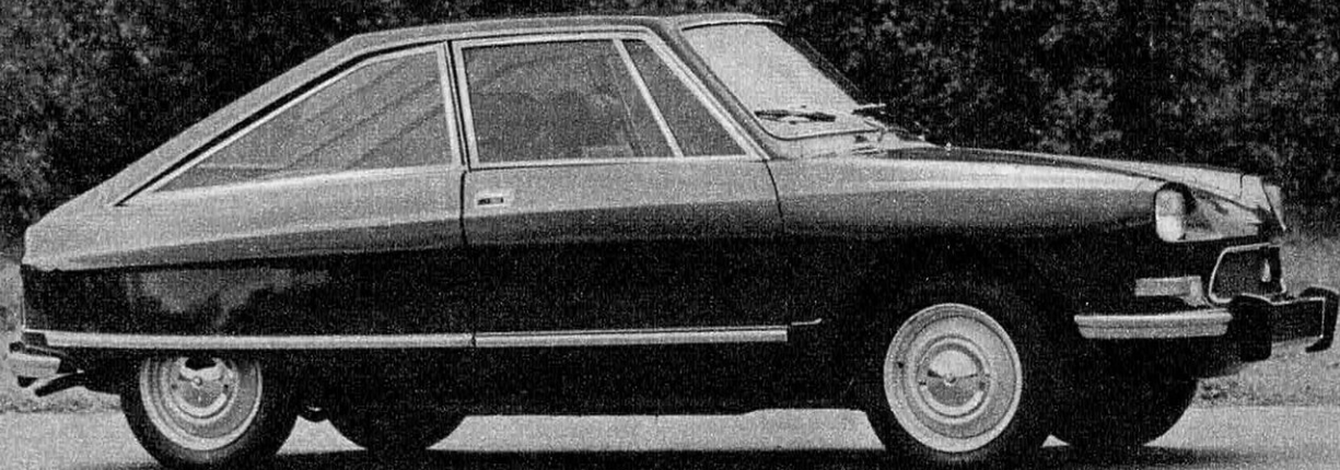
Le coupé Citroën M 35, dérivé de la berline Ami 8, mais doté d'une suspension inédite hydraulique est propulsé par le moteur rotatif Wankel. La commercialisation de cette technique n'est pas pour demain.
