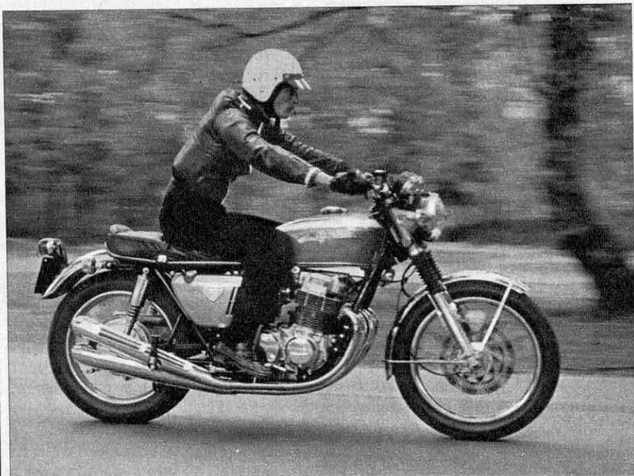
La 750 Honda est la machine de grand tourisme type: quatre-cylindres en ligne avec arbre à cames en tête, et, avantage à ne pas négliger, elle est la seule jusqu'ici à être équipée d'origine d'un frein à disques.
