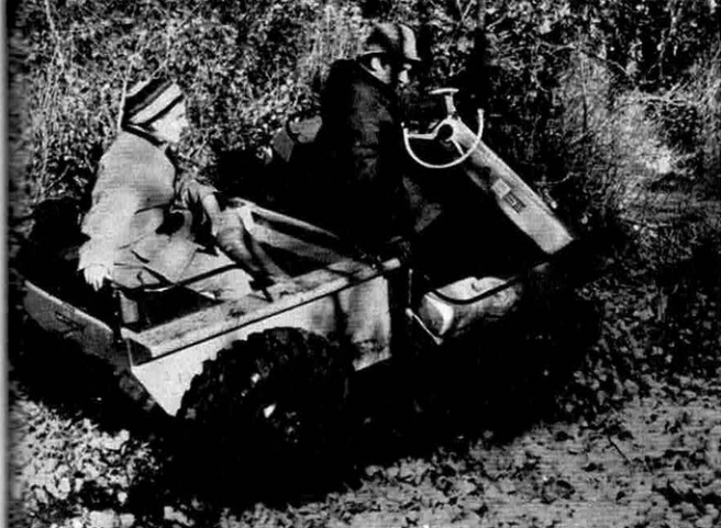
Le « Coot », ATV américain importé en France par Multimaco . L'articulation des parties avant et arrière tient lieu de suspension et améliore la stabilité sur terrains mouvementés.
