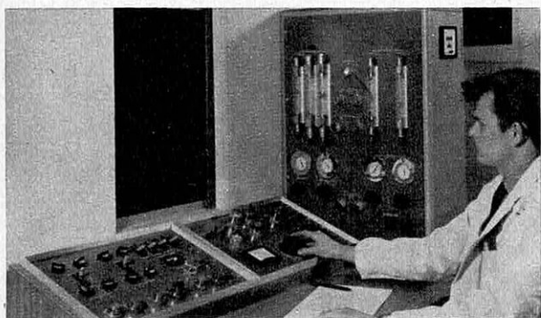
De sa cabine, le manipulateur dirige le travail d'un chalumeau à plasma qui, à très haute température, effectue un dépôt sur un cylindre en rotation.
