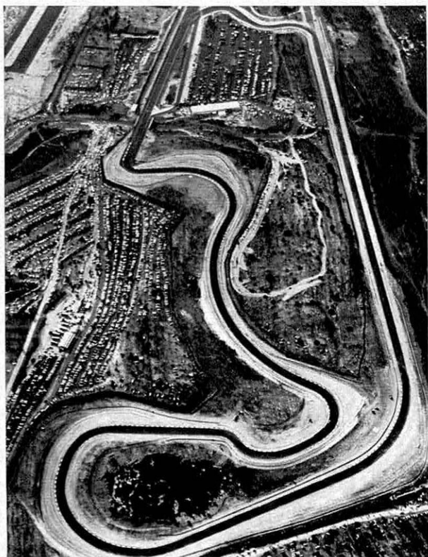
Un circuit moderne : sur le nouveau tracé Paul Ricard, au Castellet, les abords de la piste sont très dégagés dans chaque virage. Rails et grillages complètent la protection.
