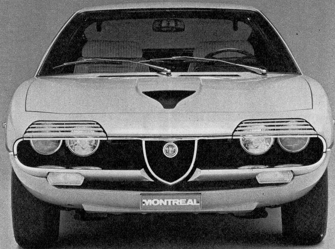
Voiture de rêve à l'Exposition Universelle canadienne, l'Alfa Romeo Montréal est descendue de son podium pour être fabriquée en série avec un superbe moteur V8 à 4 arbres à cames en tête de 2,6 litres et 230 ch.
