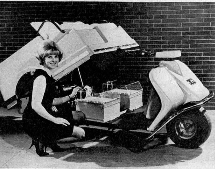
En rapport avec les problèmes de pollution, le choix des modes de propulsion futurs est l'objet d'études approfondies. General Motors a ainsi présenté un cart de golf équipé de batteries zinc-air. Ces batteries autorisent une économie de poids de près des 2/3 par rapport à des batteries classiques au plomb.
