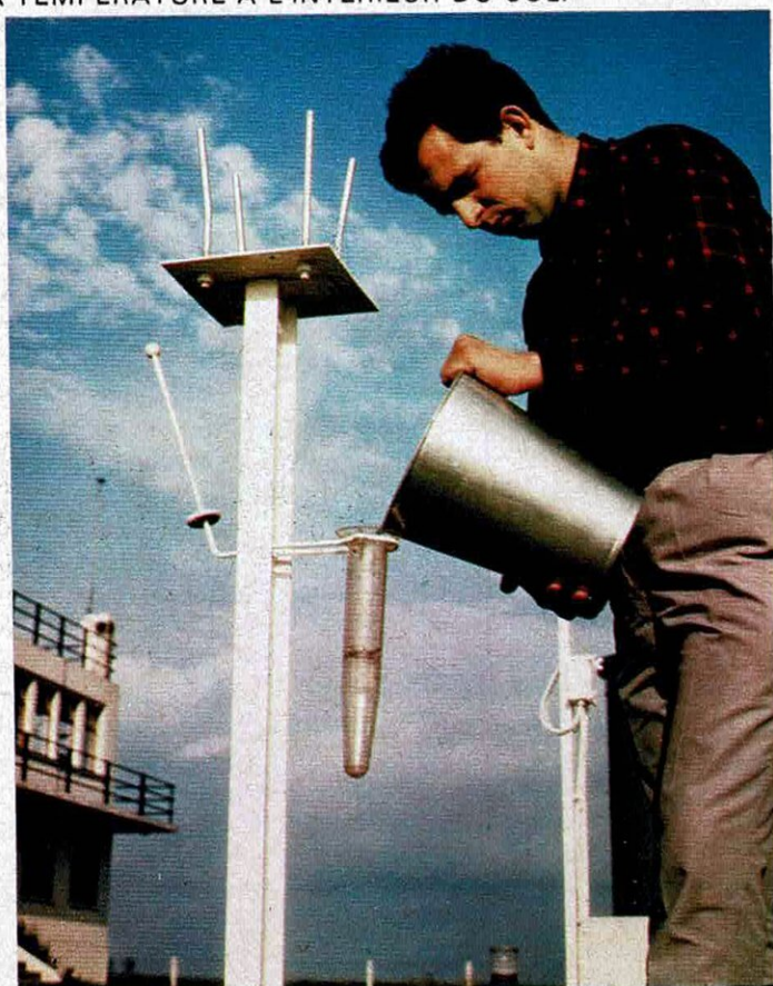
RELEVES DE TEMPERATURE ET D'HUMIDITE (D'APRES LES INDICATIONS DES APPAREILS SOUS ABRI) ET MESURE DES PRECIPITATIONS AU PLUVIOMETRE.
