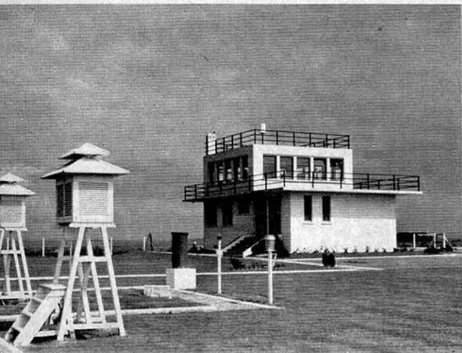
Une station d'observation et son parc à instruments. Les normes d'agencement sont assez précises. On remarque ici deux abris, l'un pour essais de matériels. A droite, des appareils de mesure de la pluie.
