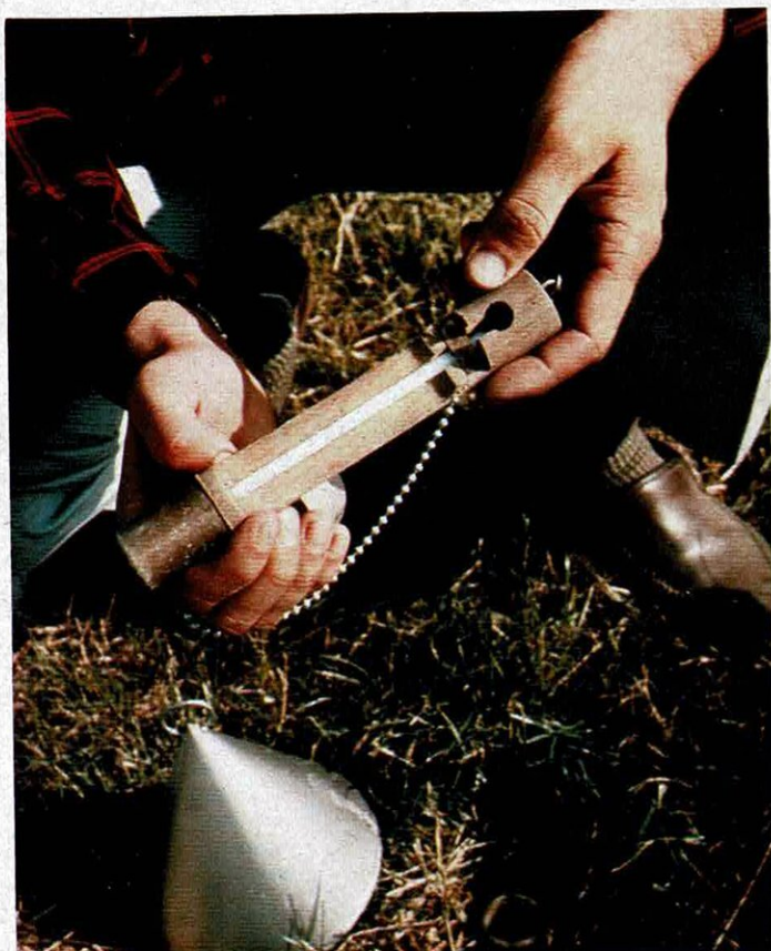
DEUX EXEMPLES D'OBSERVATIONS AU SOL : LA MESURE PRECISE DE LA DIRECTION DU VENT ET LA MESURE DE LA TEMPERATURE A L'INTERIEUR DU SOL.
