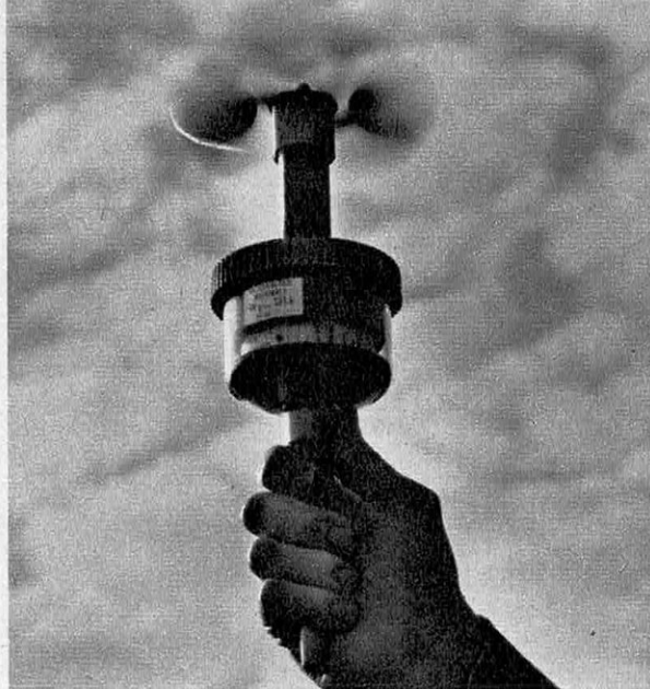
Un anémomètre à main. Le moulinet fixé à l'extrémité de l'axe vertical de l'appareil est constitué d'un jeu de coupelles hémisphériques. Sa vitesse de rotation est proportionnelle à la vitesse du vent.
