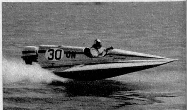
La coque « catamaran », qui effleure à peine l'eau, est actuellement la plus rapide. Elle est associée ici à un hors-bord Evinrude de 115 ch.
