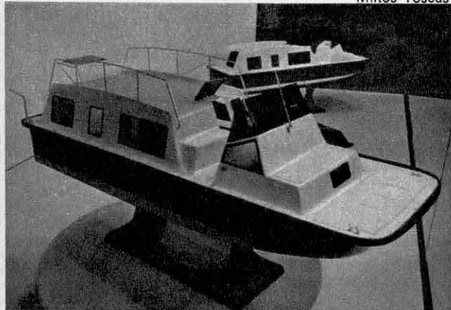
« Coche d'eau » de Bélin : 9 m, trois cabines, cuisine et toilettes. Sa propulsion peut se faire par des moteurs hors-bord ou Z-drive développant 40 ch.
