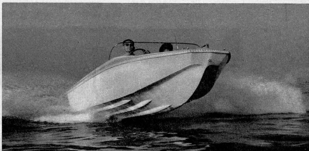
Coque « aile de mouette » du « Fury » de Cormorant.
