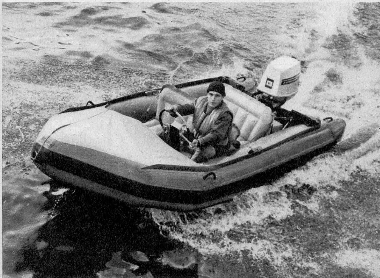
Le nouvel « Attaque-Major » d'Aerazur peut supporter un moteur hors-bord de 80 ch.
