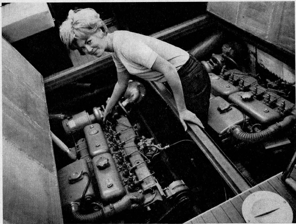
Les diesels, ici deux Volvo Penta 160 ch, sont maintenant moins gros, sans odeur et plus propres.
