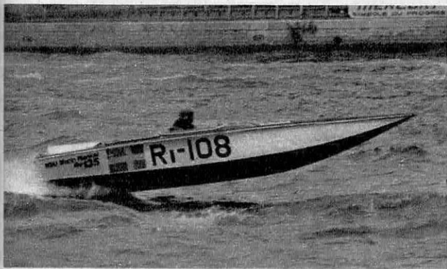
Coque de « runabout » classique. Elle est propulsée ici par le nouveau moteur rotatif N.S.U. de 135 ch, modèle dérivé du Ro 80 automobile.
