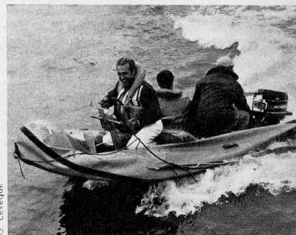
Les pneumatiques, engins de sauvetage par excellence, sont astreints, comme ce modèle de Tropic, à pouvoir naviguer même dégonflés.
