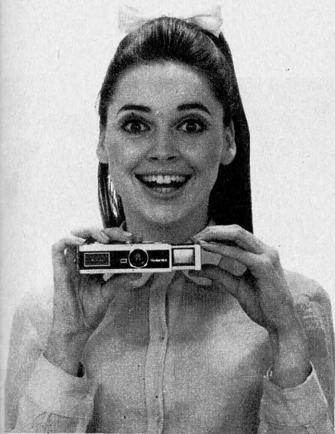
Le Rollei 16 S convient aux amateurs même inexpérimentés. Un signal vert dans le viseur apparaît si la lumière est suffisante ; une cellule règle alors l'exposition selon un programme, du 1/30 au 1/500 s.
