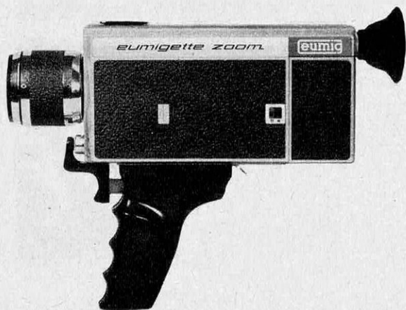
Caméra de prix modéré, l'Eumigette Zoom n'en possède pas moins un objectif à focale variable (1:1,8/10 à 20 mm). Viseur reflex et cellule CdS.
