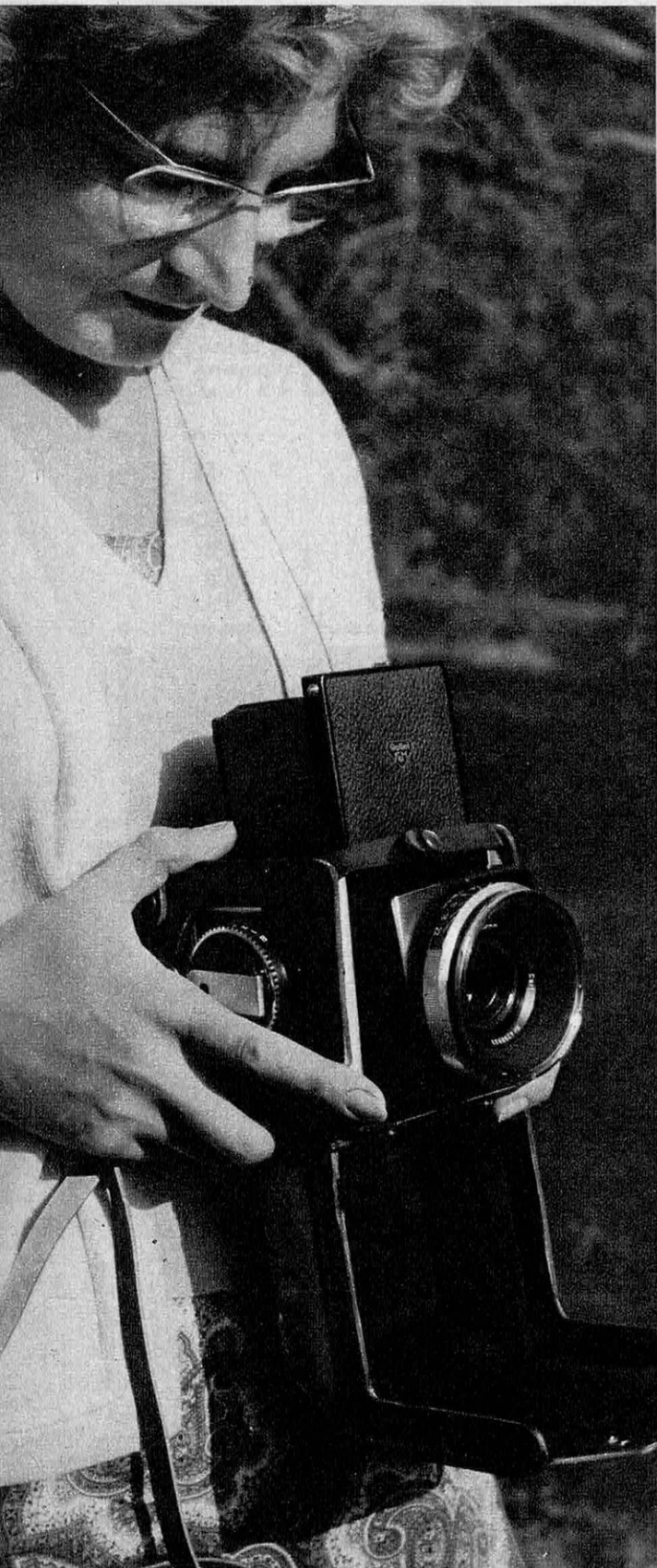
Le Rolleiflex SL 66 est l'un des reflex 6 \times 6 les plus perfectionnés, comportant notamment un soufflet à tirage allongé et dispositif de bascule de l'objectif.
