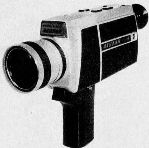
L'Alstar PZ 803, à zoom électrique 1:1,7 de 8 à 64 mm, est alimentée par piles. Elle comporte 3 vitesses (12, 18, 32 images/s). Cellule couplée.
