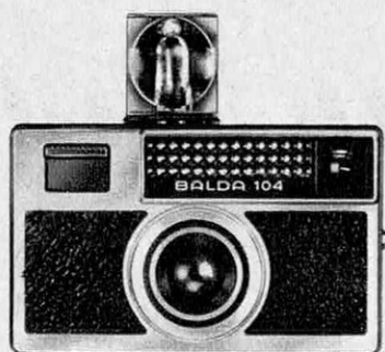
Balda 104. Un appareil très simple, sans mise au point ni réglage de l'obturateur et du diaphragme. Le chargement est facilité par la cassette 126. Une prise spéciale pour l'emploi du flashcube.
