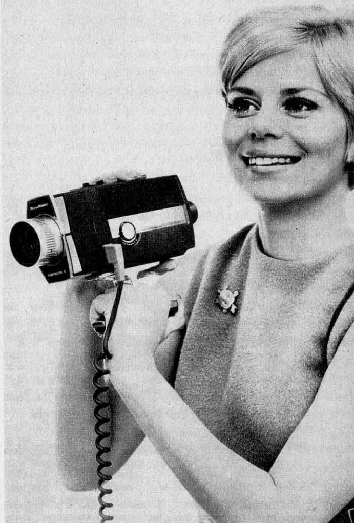
La Bell et Howell Filmosound à mise au point automatique par balancier comporte une prise de synchronisation - magnétophone pour prise de vues sonore.
