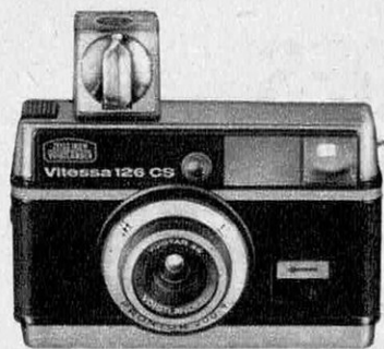
Vitessa 126 CS. Pour chargeur 126, cet appareil possède une cellule CdS indiquant dans le viseur la vitesse à employer entre 1/40 et 1/125 s. L'objectif est un 44 mm à 2 lentilles. Flashcubes.
