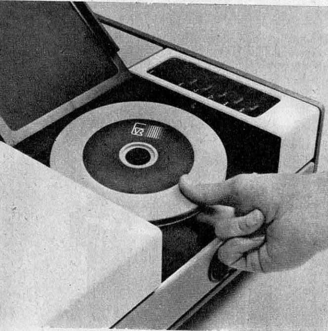
Pour la reproduction, la cassette EVR est simplement glissée dans le lecteur relié au téléviseur. Sur la droite de l'appareil apparaît le clavier de commandes.
