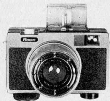
Ricoh 126. Appareil pour cassette 126, équipé d'un objectif Rikenon 1:2,8 de 95 mm, d'un flash incorporé et d'un viseur à cadre lumineux. Un moteur entraîne automatiquement le film après chaque prise de vue.
