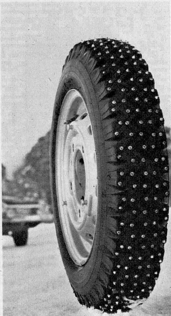
Un BF Goodrich «neige» avec environ 400 clous pointe pyramidale pour l'usage en compétition. Ce type de pneu assure la meilleure prise sur sol couvert de glace.
