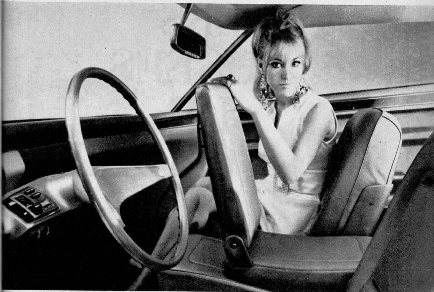
Ce montage proposé par Chrysler combine les avantages d'un accoudoir central avant et d'un dossier banquette évitant aux jeunes enfants d'être projetés dans le compartiment avant en cas de choc frontal assez violent.
