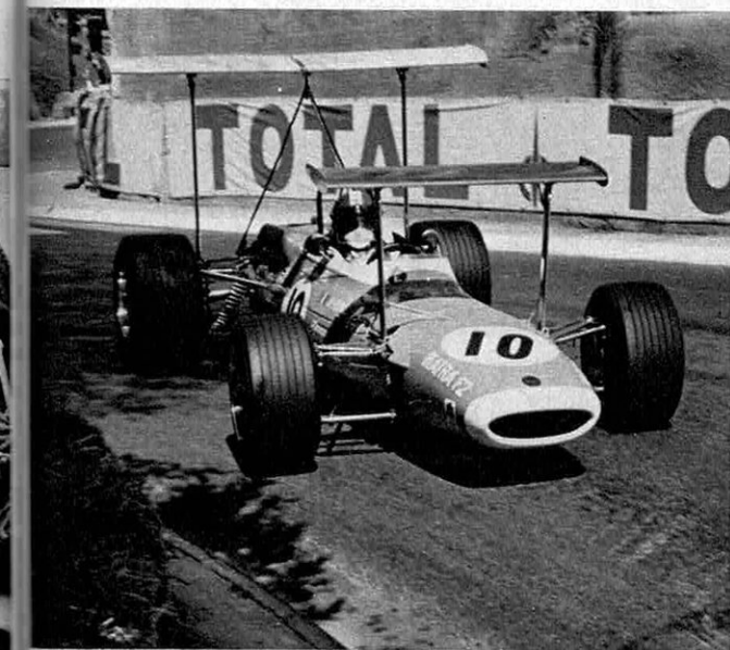
Voici, sur une Matra F2, les ailerons à l'ancienne mode, interdits depuis : dégagés de la perturbation aérodynamique de la voiture, ils prennent appui sur la suspen-
