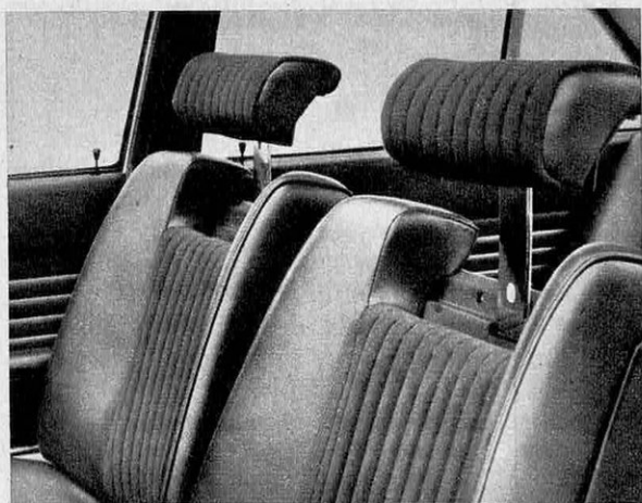
Les repose-tête doivent résister à certains efforts longitudinaux. Le mieux est de les intégrer avec leurs dossiers. La solution a été adoptée pour les sièges de la Peugeot 504.
