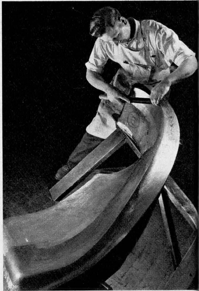
A côté de techniques très évoluées, les opérations précédant la mise en fabrication d'un nouveau modèle font appel aussi au savoir-faire de l'artisan. Les matrices d'emboutissage sont en partie usinées à la main.
