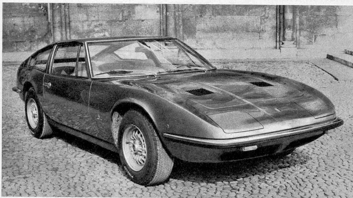
Une carrosserie signée Vignale, 260 ch sous le capot, environ 100 000 francs : c'est la nouvelle Maserati, l'Indy. Le moteur est un huit-cylindres en V de 4 136 cm 3 avec distribution à quatre arbres à cames en tête.
