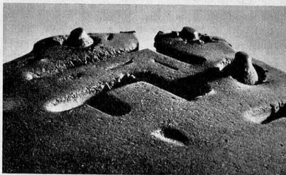
Un pneu « hiver » après 24 000 km d'usage dont 15 000 sur route asphaltée. Malgré ce traitement sévère, dont on voit les effets, les clous assurent encore la prise.
