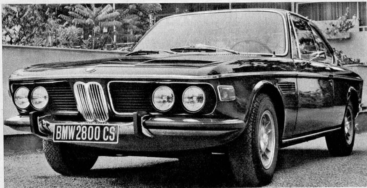
Le coupé BMW 2 800 CS dérive de la berline 2 800. Il conserve le moteur six-cylindres en ligne de 2 788 cm 3 développant 192 ch SAE à 6 000 tr/mn ; la finition est encore améliorée : La vitesse est de quelque 200 km/h.
