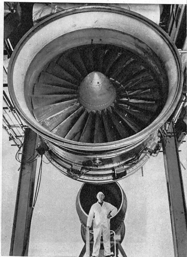
Un composite résine époxy-fibres de carbone à hautes caractéristiques mécaniques a été préféré au titane pour la construction des pales de la soufflante du réacteur Rolls-Royce RB-211. Baptisé « Hyfil », ce matériau de faible densité serait capable, au même titre que le titane, de supporter les énormes forces centrifuges engendrées sur des pales d'un mètre de long.
