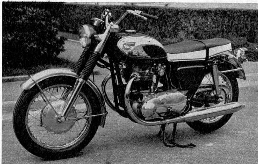
Cette 650 Kawasaki emprunte beaucoup à la technique britannique et rappelle les débuts de l'industrie nippone qui a su depuis trouver son caractère personnel. Le bicylindre à culbuteurs de 624 cm 3 fournit 50 ch à 6 500 tr/mn. Vitesse maximale: 185 km/h.
