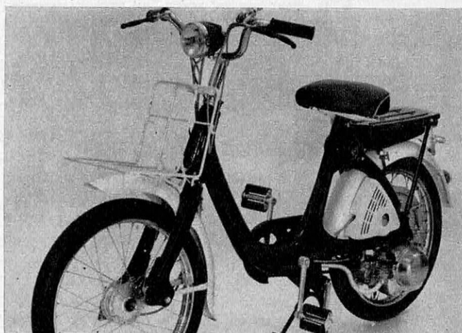
Un délicat moteur à arbre à cames en tête et sa position latérale à la roue sont caractéristiques du Honda P 50, cyclomoteur japonais de grande diffusion.
