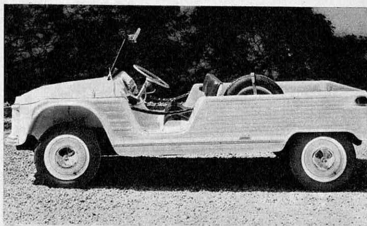
La Méhari de Citroën : le plastique au service de l'automobile. Une œuvre originale dotée d'un moteur 3 CV.
