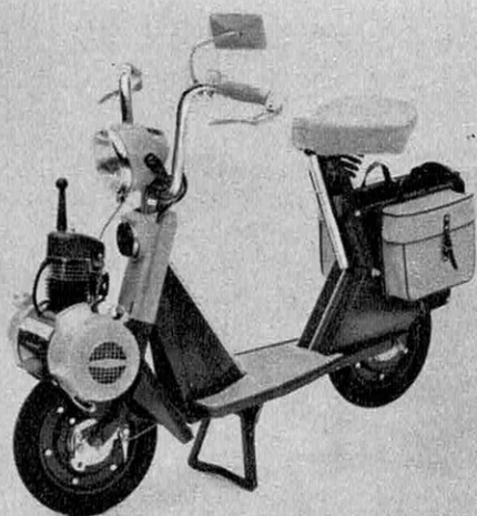
Le Micron est un curieux mini-scooter dont la partie motrice n'est autre que celle qui anime le Vélosolex classique. Aucun organe de démarrage n'a été prévu.
