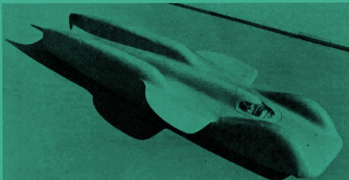
Le professeur Porsche lorsqu'il réalisa pour Mercedes en 1939 la voiture qui devait battre le record mondial de vitesse, l'équipa d'emblée de deux ailerons amovibles mais à incidence fixe.
