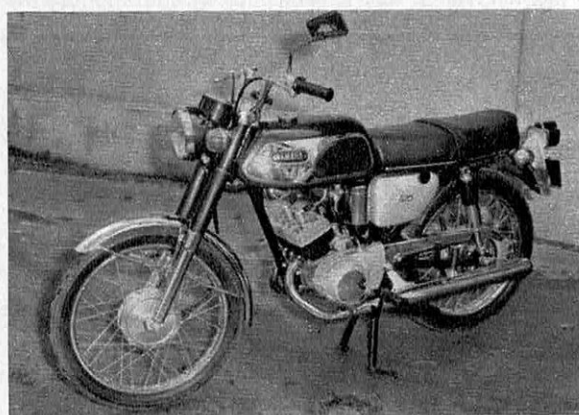
Le Yamaha 125 YAS-I, vélomoteur de performance, très caractéristique de l'école japonaise: moteur deux-temps à lubrification autonome; cinq vitesses.
