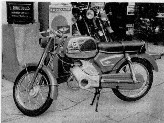
Ce Zündapp, comme tous les cyclomoteurs allemands, s'apparente à la moto, comme l'attestent ses gros moyeux-freins, ses suspensions et son architecture.
