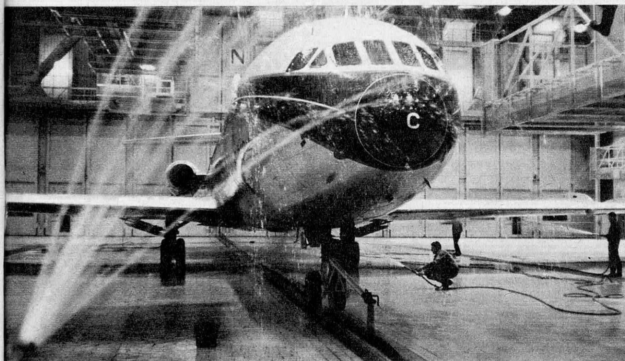
Le nettoyage des avions est une nécessité technique : les trainées parasites engendrées par l'encrassement peuvent représenter plusieurs centaines de kilogrammes de carburant.
