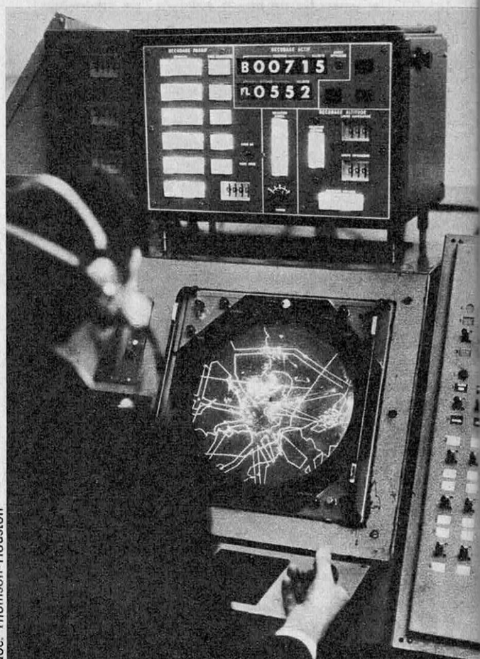
L'écran du SECAR superpose le parcours des avions à la projection des cheminements aériens. En haut, affichage des données.
