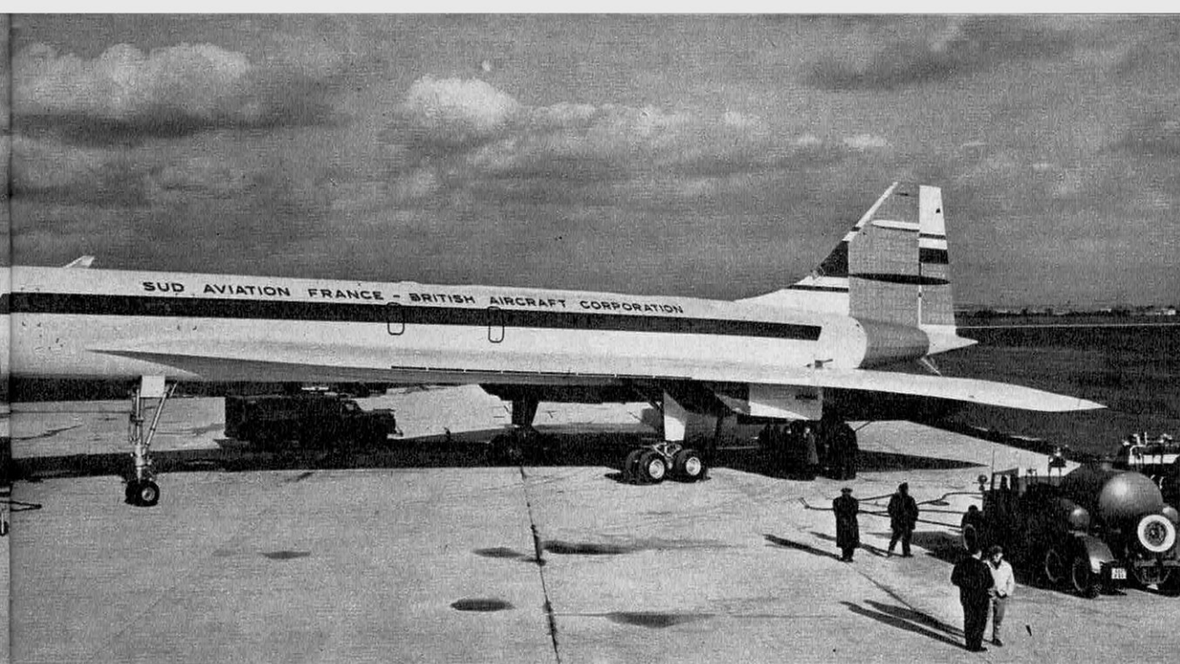
« Concorde » possède un nez à géométrie variable dont l'abaissement doit améliorer la visibilité de l'équipage. Il n'en donne pas moins à l'avion un air inquiétant que les passagers, heureusement, ne verront pas, confortablement installés (photo ci-dessous) dans la cabine.
