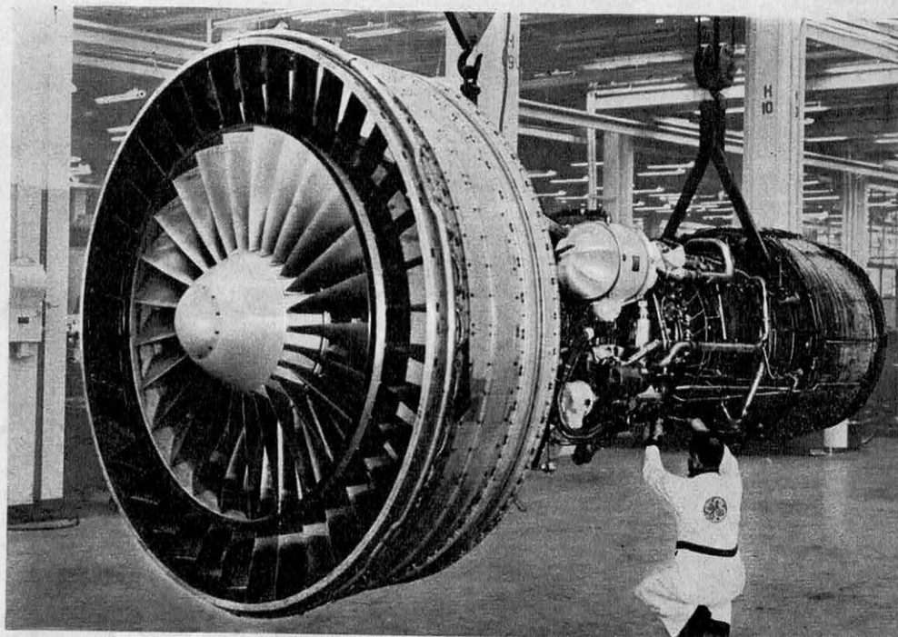
Quatre réacteurs General-Electric TF-39 de plus de 18 tonnes de poussée unitaire équipent le Lockheed C-5 de l'US Air Force.
