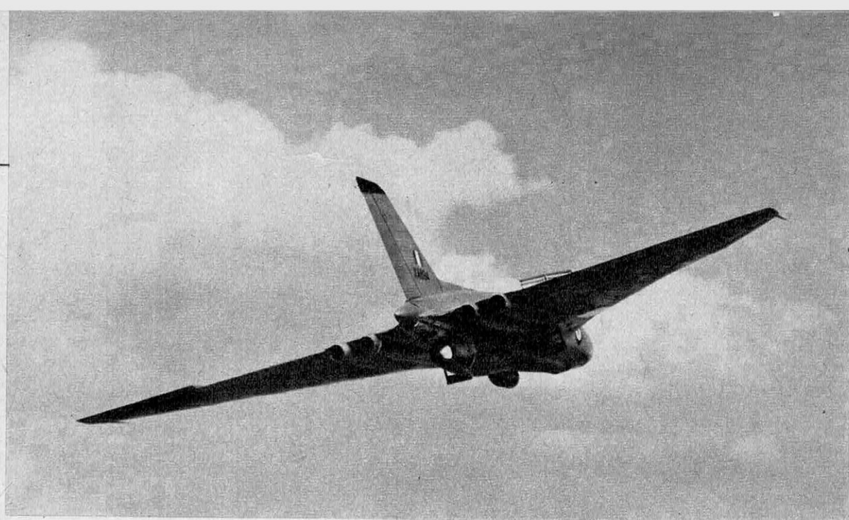
En attendant les premiers vols de « Concorde », le réacteur Olympus a été essayé en vol subsonique sur un bombardier « Vulcan ». Le comportement en vol supersonique, simulé au banc seulement, devra attendre le premier vol de « Concorde » pour pouvoir être vérifié.
