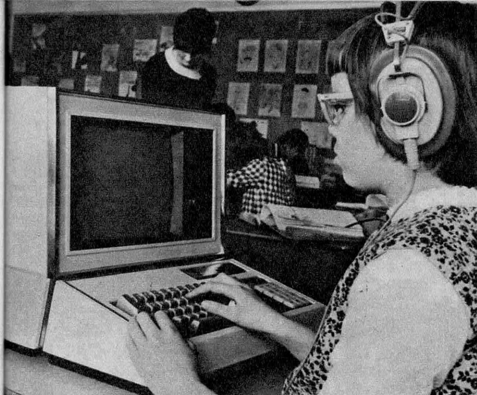
Une unité d'enseignement individuel programmé par ordinateur développé par R.C.A., aux États-Unis. La leçon et les questions de contrôle apparaissent sur l'écran de visualisation. L'élève utilise le clavier pour ses réponses.
