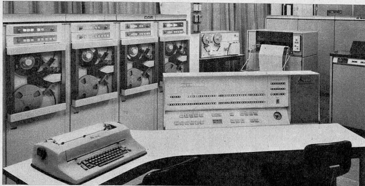
Le calculateur C-90-80 pour calculs scientifiques et applications en temps réel : automatisme industriel, simulation d'essais en vol, commutation de messages, etc.
