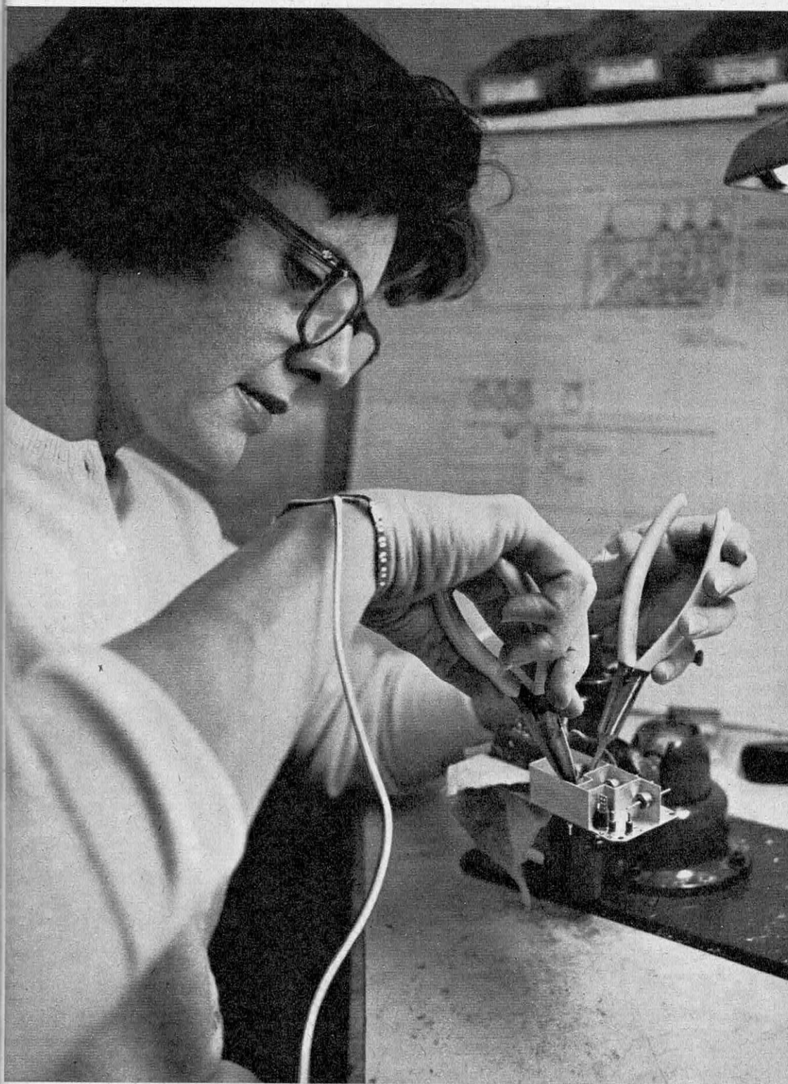
Sensibilité et délicatesse: cette ouvrière de la Western Electric travaille sur des diodes miniatures si sensibles qu'il a fallu lui mettre au poignet un bracelet métallique relié à la terre afin d'écouler les charges d'électricité statique engendrées par le frottement de ses vêtements.
