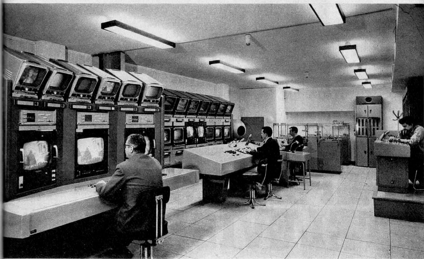
La régie son (en haut) réalise le mixage des sources sonores dont une partie est fournie par la table pick-up-magnétophones visible au premier plan à gauche. Ci-dessus, la régie copieur, où s'opère la sélection des images provenant de plusieurs caméras opérant simultanément.
