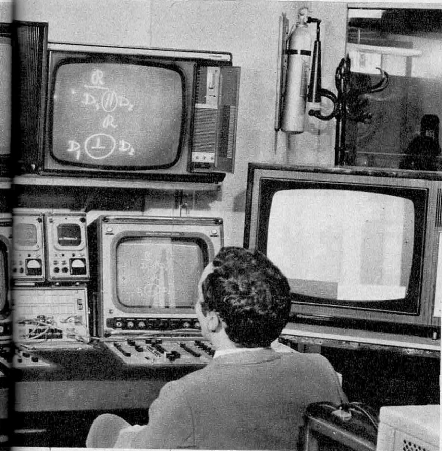
Depuis son pupitre, le chef d'équipement peut contrôler à chaque instant toutes les images transistant par la régie finale et celles qui sont reçues par le téléspectateur : A récepteur couleur professionnel ; B, C récepteurs professionnels noir et blanc ; D récepteur commercial couleur ; E, F oscilloscopes ; G, H récepteurs commerciaux noir et blanc et couleur pour contrôle de l'émetteur de la Tour Eiffel ; I interphone.
