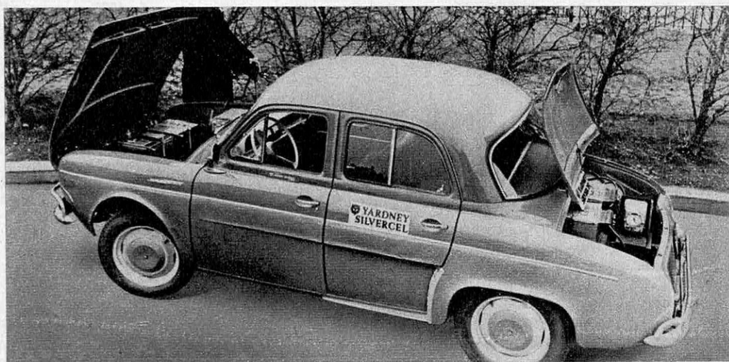
Équipée par Yardney de batteries argent-zinc (90 kg), cette Dauphine à moteur 5 kW dépassait 90 km/h, rayon d'action 130 km, accélération de 0 à 50 km/h en 5 s. La vitesse fut ensuite portée à 100 km/h et le rayon d'action à plus de 240 kilomètres.
