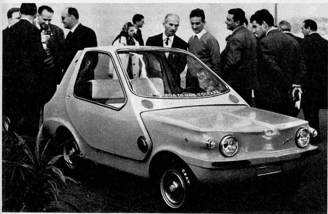
En 1964, Sibona et Basano avaient exposé à Turin un prototype de voiture urbaine deux-places doté d'un cockpit basculable vers l'avant Toute la carrosserie est en plastique.
