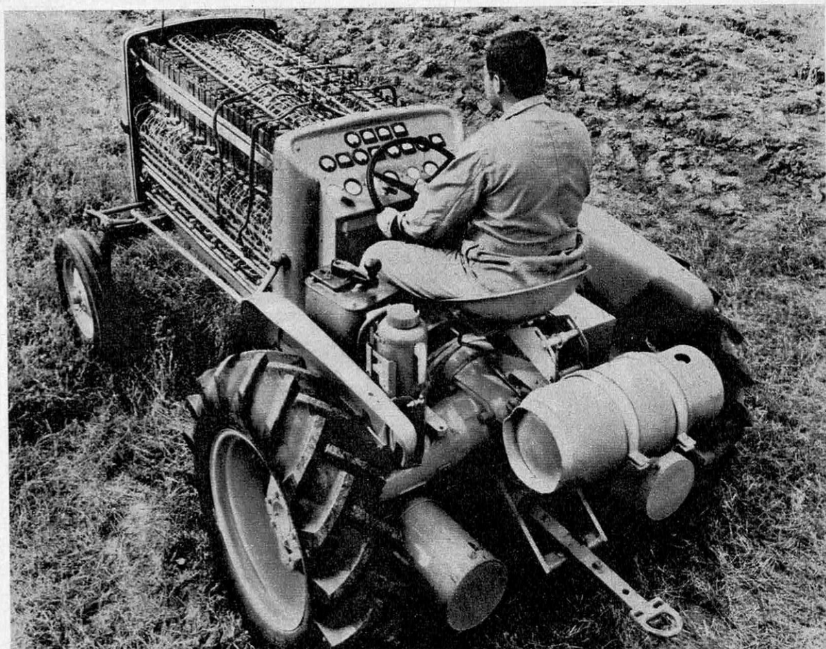
Allis-Chalmers a réalisé divers engins équipés de piles à combustible : d'abord, son célèbre tracteur présenté dès 1959, puis, en 1963, deux véhicules à hydrazine-oxygène : une voiturette pour terrain de golf équipée d'un générateur de 3 kW, et un chariot élévateur de manutention.
