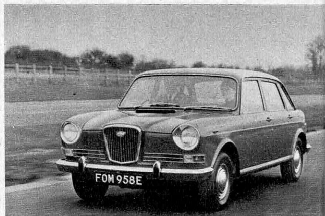
La Wolseley 18/85 est l'une des versions de la série des voitures traction-avant, avec moteur transversal 1 800 cm 3 , sorties par la B.M.C.
