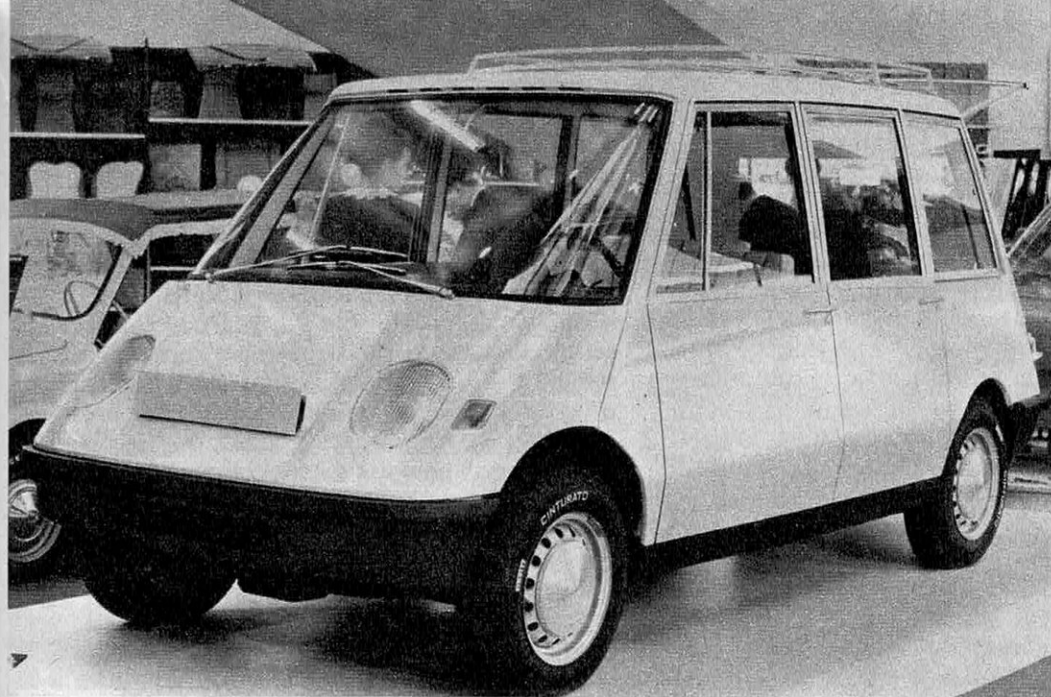
Présentée en 1965 par les carrossiers italiens Sibona et Basano, l'Autonova Fam, ci-contre, était une berline prototype offrant quatre places. Le châssis est celui de la Glas 1304.
