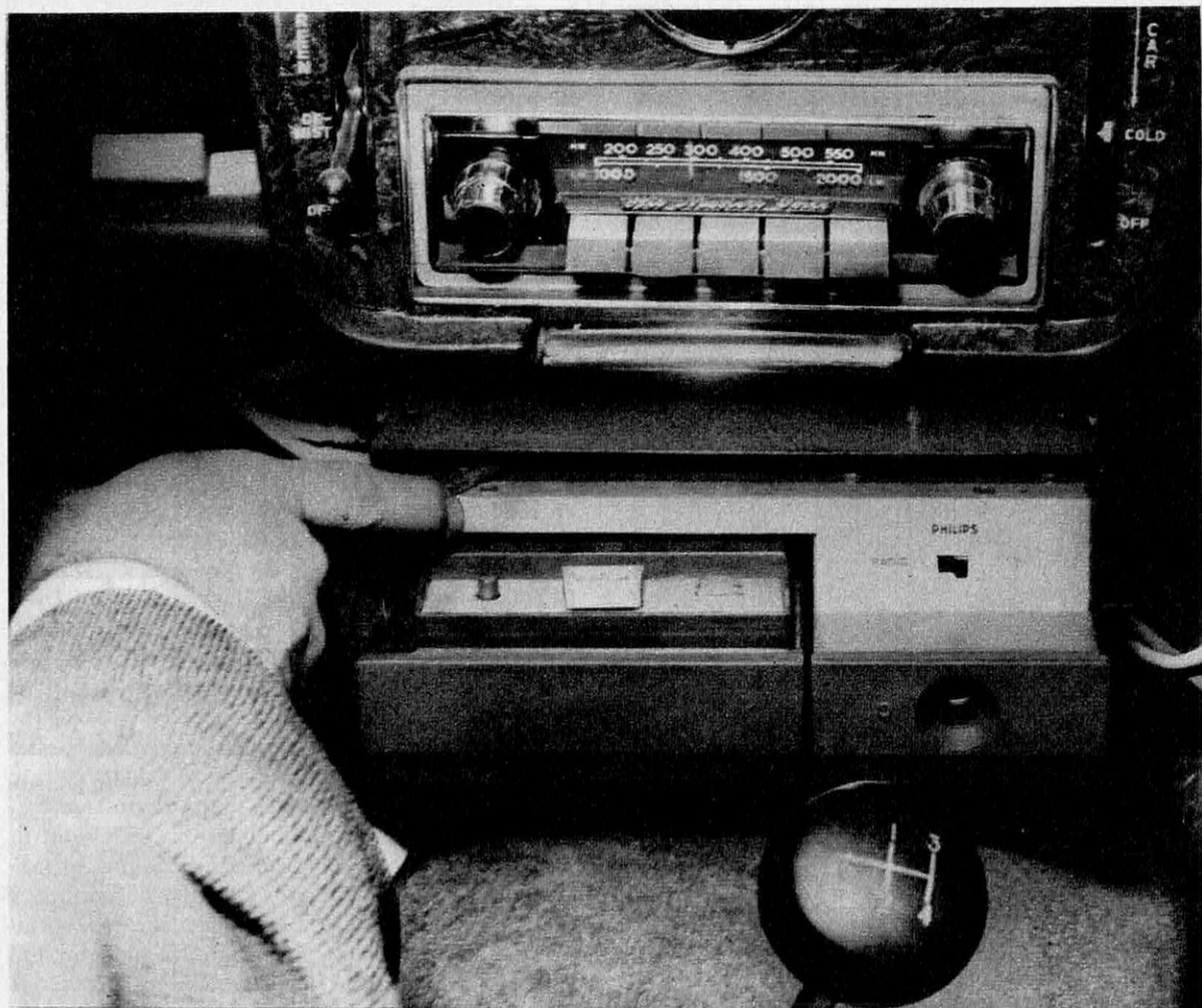
Ensemble de sonorisation incorporé au tableau de bord : magnétophone à cassettes et récepteur de radio.
