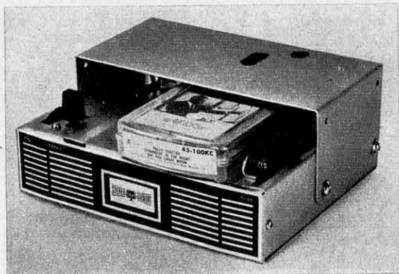
Lecteur de faible encombrement pour cassettes stéréo, pouvant être monté à bord d'un grand nombre de modèles (Stéréo-Jaubert).
