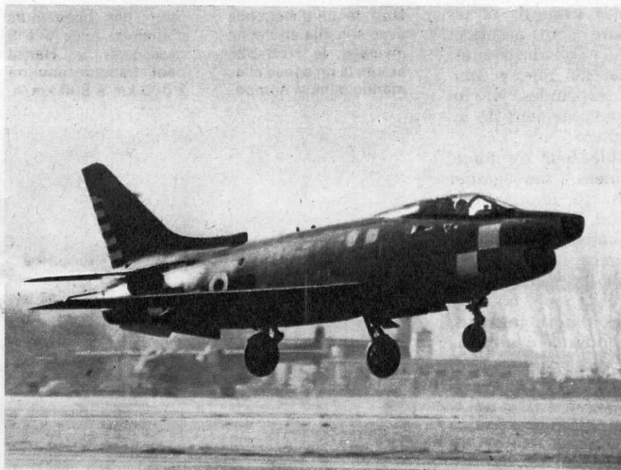
Dérivé biréacteur du Fiat G-91, le G-91 Y est un chasseur-bombardier dont la production de série va être lancée pour l'Aeronautica Militare. Équipé de deux réacteurs General Electric J-85, cet appareil peut décoller d'une piste en herbe à son poids maximum de 8 700 kg.
