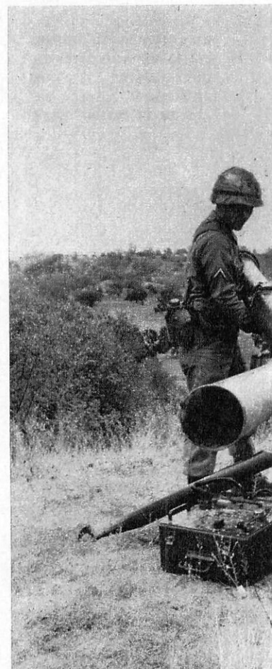
Le missile antichars Tow est tiré d'un tube et guidé par fils. L'ensemble peut être installé sur un véhicule blindé ou sur un hélicoptère.
