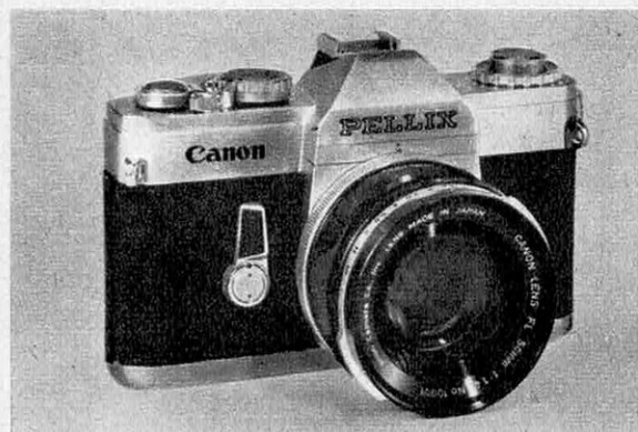
Canon Pellix — Premier 24 × 36 reflex sans miroir mobile; celui-ci est remplacé par une lame fixe semi-transparente. Une cellule CdS couvrant 1/3 du champ de l'objectif permet un réglage semi-automatique de l'exposition. Optiques interchangeables; obturateur à rideau pour des vitesses de 1 s au 1/1 000 et pose.
