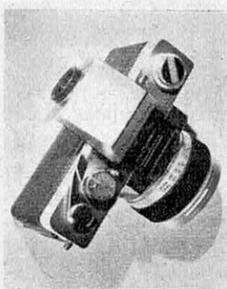
Asahi Pentax Spotmatic — Reflex 24 × 36 semi-automatique à cellule incorporée dans le viseur-prisme. Objectifs interchangeables à présélection du diaphragme; obturateur à rideau de 1 s au 1/1 000. Prises flash électronique et magnétique.
