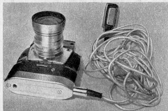
◀ Instamatic 800 — Le moteur arme et fait avancer le film en moins d'une seconde.
