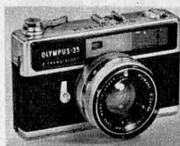
Olympus 35 LE — 24 × 36 à obturateur électronique (6 transistors et 3 diodes); 1/15 au 1/500 de s. Viseur collimaté; Zuiko 1,7/45 mm; cellule CdS de 25 à 400 ASA.
