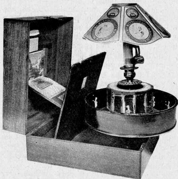
Praxinoscope-théâtre d'Ernest Reynaud. Les 16 images de la bande dessinée étaient vues dans les 16 miroirs qui se présentaient successivement devant l'œil du spectateur. L'invention de ce système remonte à 1877.
