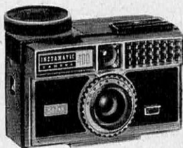
Instamatic 400 — Appareil perfectionné, totalement automatique : une cellule au sélénium règle le diaphragme et un moteur assure l'entraînement du film après chaque prise de vue (10 s suffisent pour prendre 12 photos) ; flash incorporé ; 1/60 et 1/40 de seconde.
