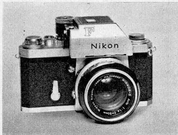
Nikon Photomic T — Reflex 24 × 36 à cellule CdS incorporée au viseur-prisme Photomic T. Objectifs et dispositifs de visée interchangeables; mise au point télémétrique; obturateur à rideau pour des vitesses entre 1 s et 1/1 000 de s. Prise pour le synchro-flash.
