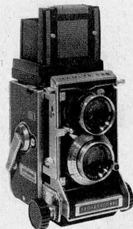
Mamiyaflex C 33 — Reflex 6 x 6 à objectifs interchangeables; couples d'optiques de 65, 80, 105, 135 et 180 mm montés sur obturateurs assurant des vitesses d'une seconde au 1/500 et la pose B; visée à verre dépoli ou prisme.
