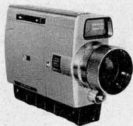
Sankyo Super 5 X — Caméra Super 8 équipée d'un zoom 1,9 de 8,5 à 42,5 mm à commande électrique; cellule couplée pour des sensibilités allant de 25 à 250 ASA.
