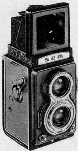
Semflex Otomatic — 6 x 6 reflex, objectif SOM Berthiot 3,5/75 mm, objectif de visée 2,8/75 mm, vitesses de 1 s au 1/400 de seconde, synchronisation flash X et F, entraînement du film et armement au moyen d'une manivelle.
