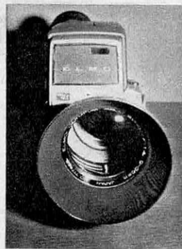
Elmo 4 S. — Caméra reflex à moteur électrique et zoom 1,4 de 9 à 36 mm; réglage automatique de l'exposition par cellule CdS reflex; vitesses de 16 à 64 images/s; marche arrière; mise au point téléométrique; avec télécommande.
