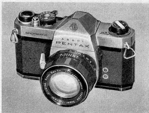
Asahi Pentax Spotmatic — Reflex 24 × 36 semi-automatique à cellule incorporée dans le viseur-prisme. Objectifs interchangeables à présélection du diaphragme; obturateur à rideau de 1 s au 1/1 000. Prises flash électronique et magnétique.
