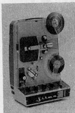
◀ Silma Sonik 8 — Appareil sonore magnétique 8 mm ; Trois moteurs pour l'entraînement du film, pour la régulation du son et pour refroidissement ; 18 et 24 im/s ; lampe 21,5 V, 150 W ; objectif 20 mm ou zoom ; enregistrement-lecture magnétiques ; comporte un mélangeur sonore incorporé.
