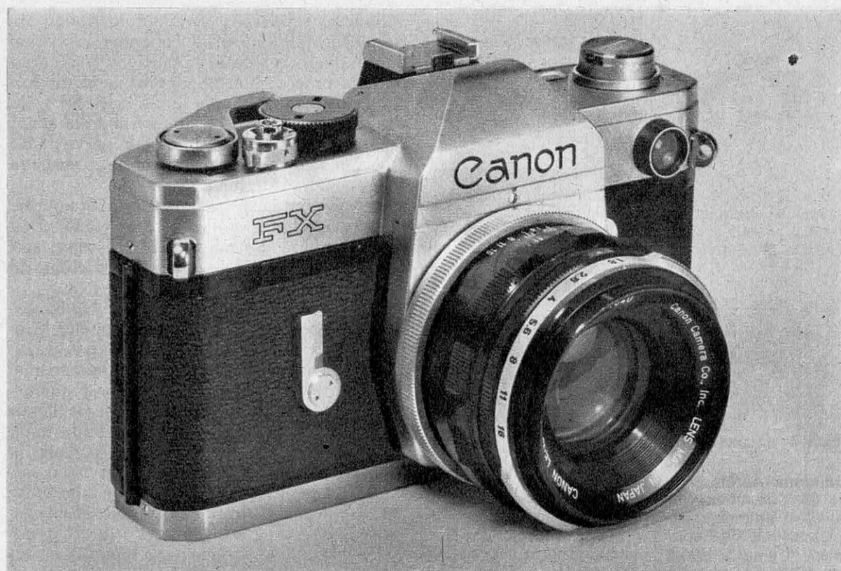
Canon FX — Reflex 24 × 36 à objectifs interchangeables, viseur prisme, télémètre, cellule CdS couplée et vitesses de 1 seconde au 1/1 000 de s.
