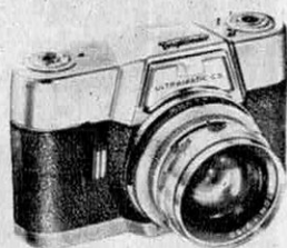
Ultramatic CS — 24 × 36 à cellule CdS dans la visée reflex; réglage automatique de l'exposition; objectifs interchangeables à présélection; obturateur Synchro-compur de 1 s au 1/500 de s et pose B; prise de flash.
