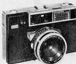
▶ Focasport II C — 24 × 36 à cellule couplée, viseur collimaté, objectif 2,8/45 mm; vitesses de 1 s à 1/500 de s.
