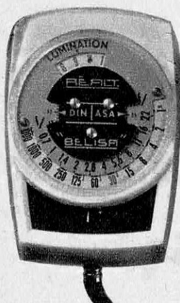
Norwood — Posemètre pour lecture en lumière réfléchie et incidente; sphère intégrant la lumière sur 180°; sensibilités de 10 à 2 000 ASA.
