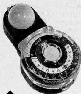
Norwood — Posemètre pour lecture en lumière réfléchie et incidente; sphère intégrant la lumière sur 180°; sensibilités de 10 à 2 000 ASA.
