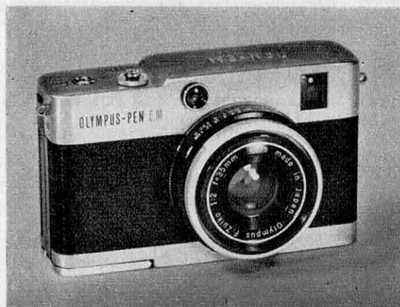
Olympus Pen EM — Appareil 18 × 24 à obturateur électronique, pour des vitesses de 30 s au 1/500; 4 transistors; cellule CdS de 10 à 400 ASA; Zuiko
