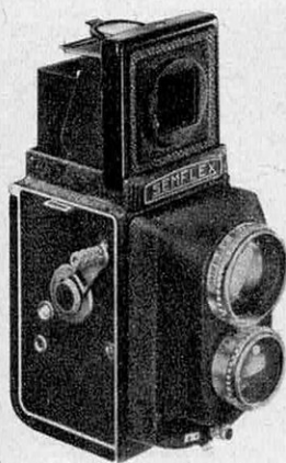
◀ Semflex Studio — Reflex 6 × 6 particulièrement destiné au portrait; objectif Berthiot 5,4/150 mm; objectif de visée 3,9/150 mm; vitesses de 1 s au 1/400; synchroflash X et F; entraînement par manivelle.
