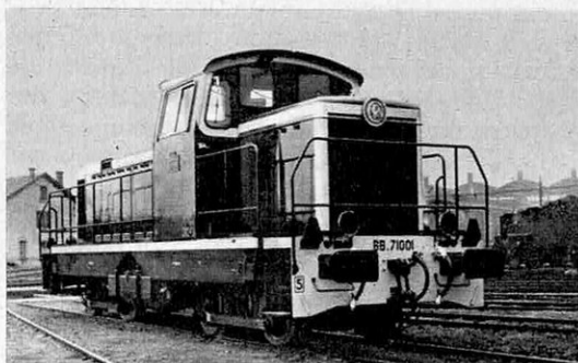
Les BB 71000, 470 kW, transmission mécanique, ont été commandées à 30 exemplaires.
