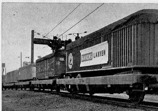
Le pont-levis du wagon « kangourou » réalise un abaissement maximal du chargement.
