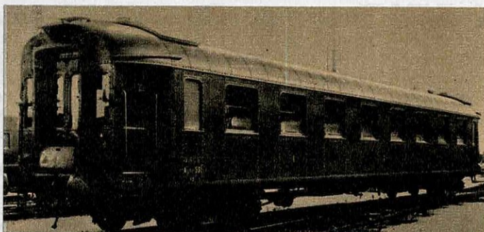
Les premières voitures métalliques réalisées en France vers 1925 comportaient une caisse formée de multiples panneaux assemblés par rivetage (ci-contre). Plus tard, des modèles beaucoup plus légers, avec caisse emboutie et soudée (ci-dessus), furent mis en service sur le réseau de l'État.
