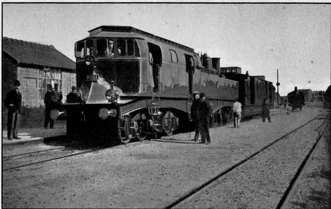
Le second type de locomotive électrique autonome de Jean-Jacques Heilmann avec son fourgon tender. Cette photographie fut prise lors des essais sur les voies de l'Ouest en 1896.
