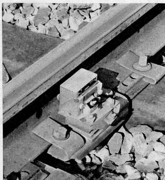
Un détecteur électronique; il utilise les courants induits dans le bandage d'une roue passant au voisinage d'un circuit oscillant.
