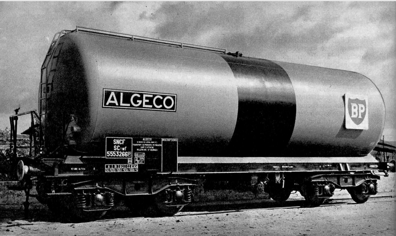
Un wagon-citerne à bogies, d'une capacité de 665 hl, pour produits pétroliers noirs.
