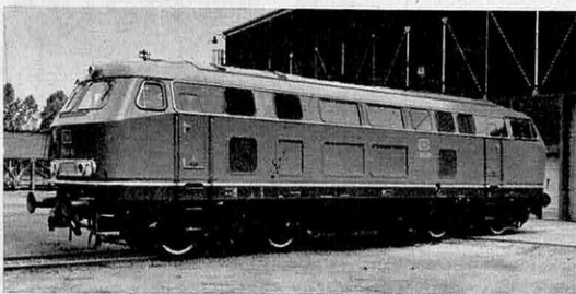
La locomotive expérimentale à diesel et turbine à gaz des chemins de fer allemands.
