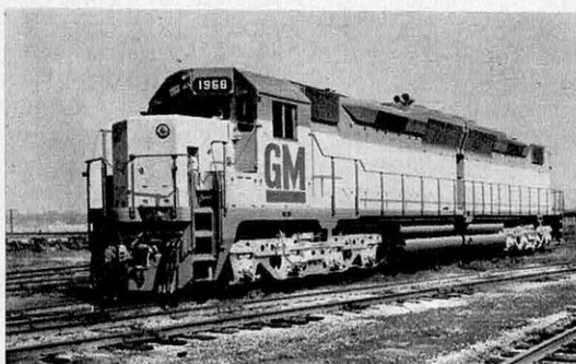
La nouvelle diesel électrique General Motors de 6 000 ch, deux diesel 16 cylindres.
