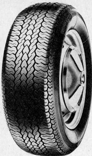
Le V 10 GT de Kléber-Colombes, pneu à carcasse en arceaux droits, ceinture renforcée inextensible, bande de roulement large et épaulement de sécurité avec nervure longitudinale.
