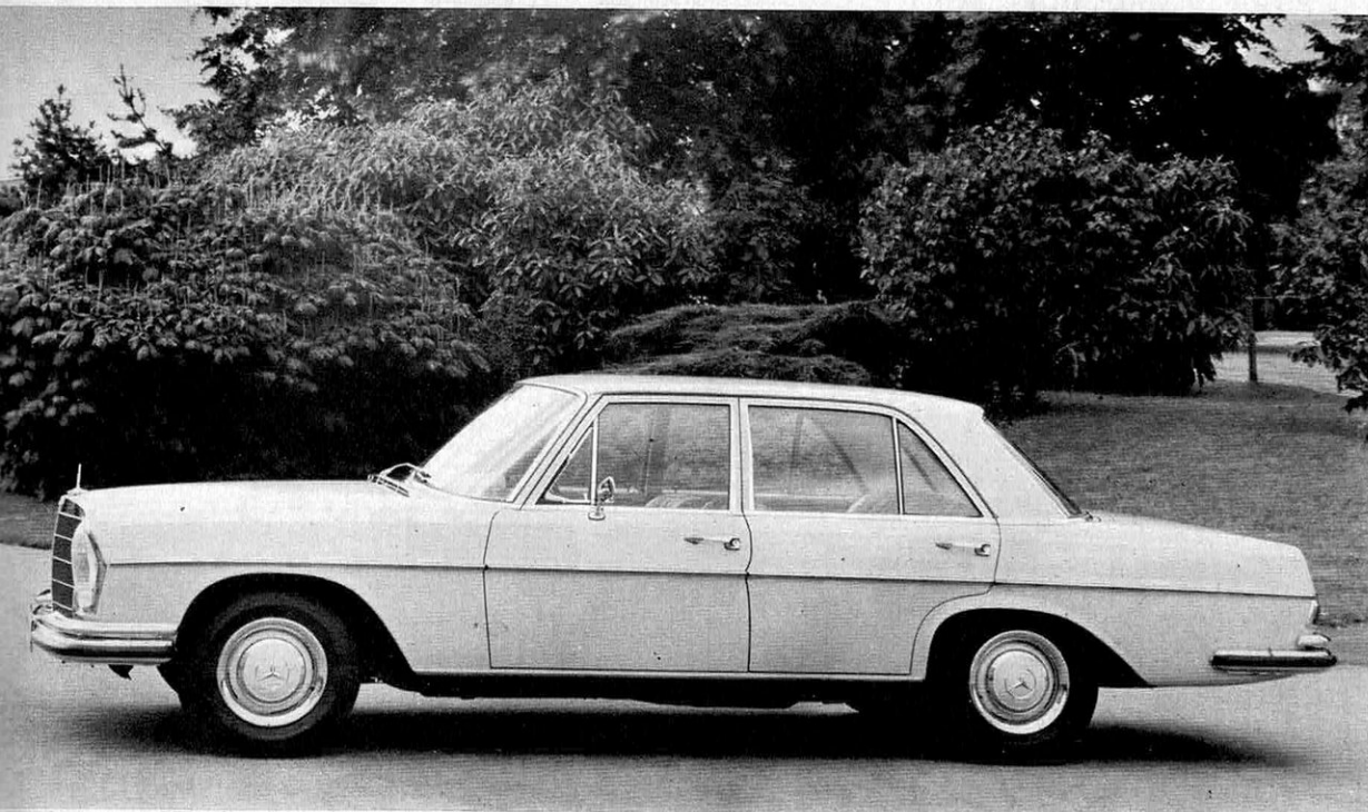
En haut, le moteur 6 cylindres à deux carburateurs de la nouvelle 230 S Mercedes sur lequel on remarquera l'alternateur. En bas, la ligne affinée de la gamme des modèles de « classe moyenne supérieure » (ici la 250 SE 2,5 litres, 170 ch SAE, 190 km/h.)
