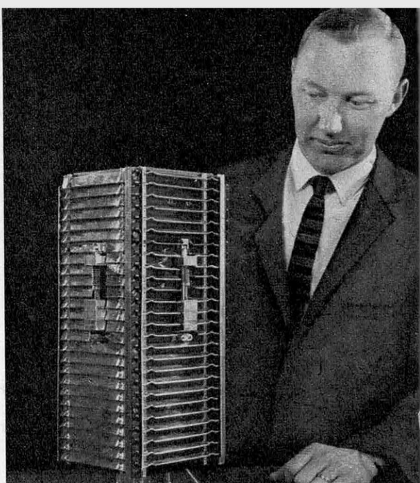
Une pile à combustible hydrogène-oxygène pour engins spatiaux, fournissant 200 watts sous 28 volts, réalisée par Allis-Chalmers.
