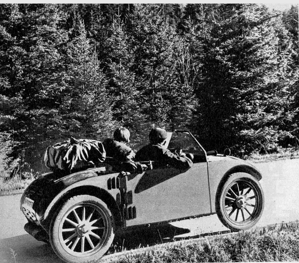
En Allemagne, Hanomag réalisa en 1923, une voiture légère monocylindre à moteur arrière dont l'esthétique était fort nouvelle.
