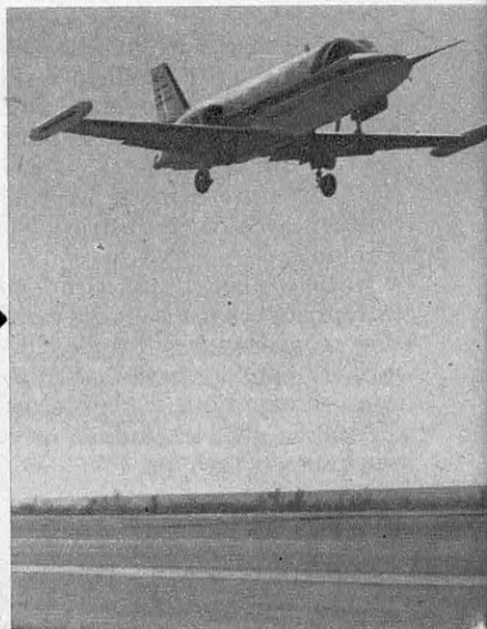
Biréacteur de transport léger pour 6 à 10 passagers, le Piaggio-Douglas PD-808 vole à 850 km/heure.
