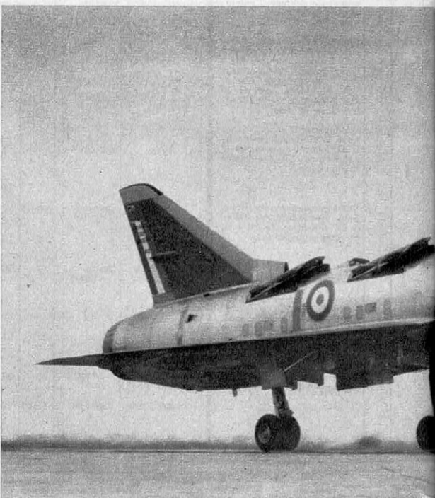
Le Kestrel, avion tactique dont le réacteur Pegasus assure le décollage vertical et la propulsion.
