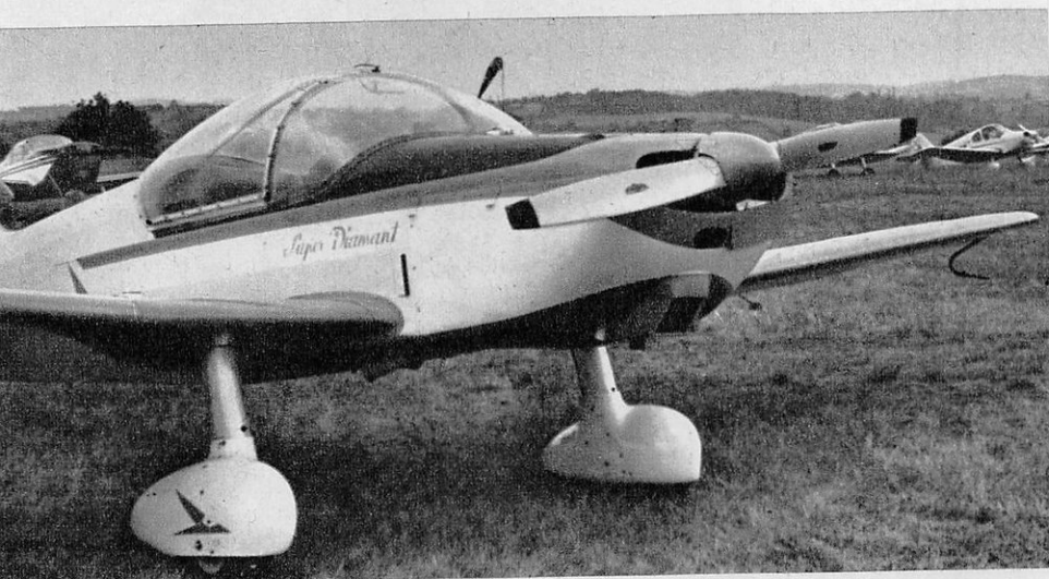
Très belle réalisation d'amateur, ce triplace Super Diamant construit par M. Moncey est une extrapolation du Piel Emeraude qui fait l'objet de plusieurs fabrications de série. Moteur de 145 ch.
