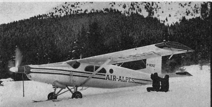
Le Turbo-Porter est la version à turbopropulseur Astazou du Pilatus PC-6 suisse, transport léger mixte, passagers (8 à 10) et fret, à décollage court.
