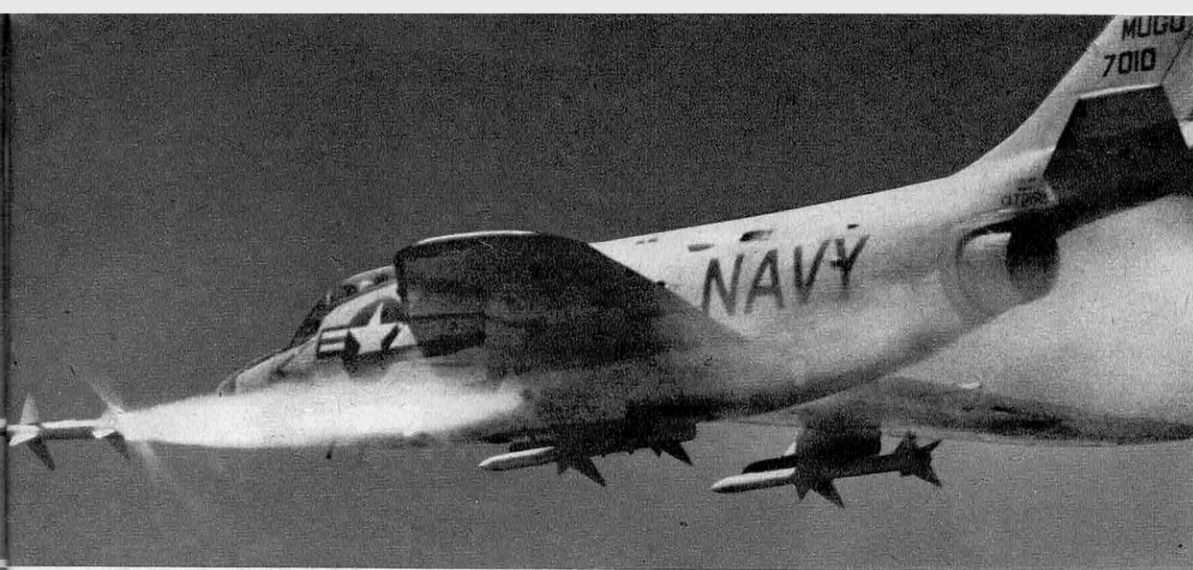
Le Sparrow III à autoguidage radar vole à Mach 2,5 et porte à 15 km. Il emporte une charge
