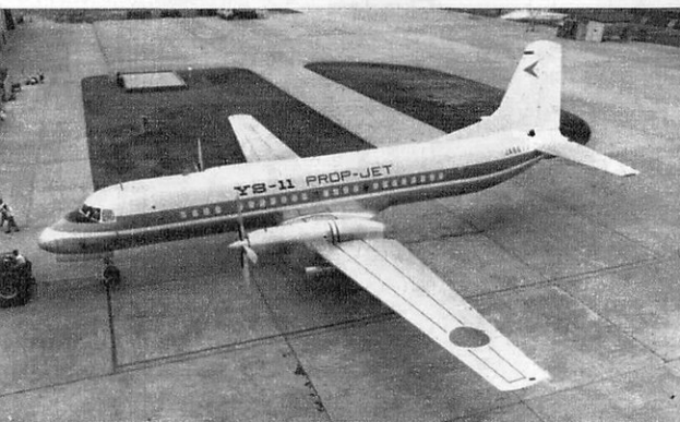
L'industrie aéronautique japonaise ne se contente pas de produire des avions légers. Le YS-11 peut transporter quelque 60 passagers à 475 km/h.
