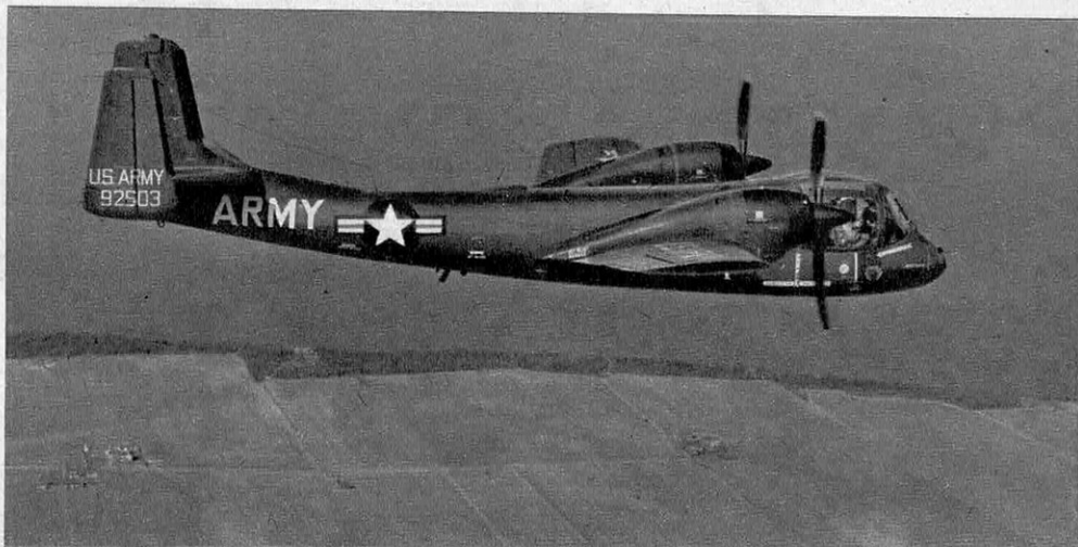
Le Grumman Mohawk OV-1A à turbopropulseur, biplace de reconnaissance photographique radar de l'US Army.
