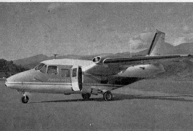
Transport léger pour 13 passagers, le Piaggio P-166 C vole en croisière à 360 km/heure avec 1 000 km de rayon d'action à pleine charge.
