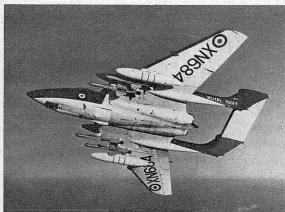
Sur un chasseur naval Hawker-Siddeley Sea Vixen Mk. 2, quatre missiles Red Top à guidage infrarouge. Volant à Mach 3, et portant à 11 km, ils ont une charge explosive de 31 kg.
