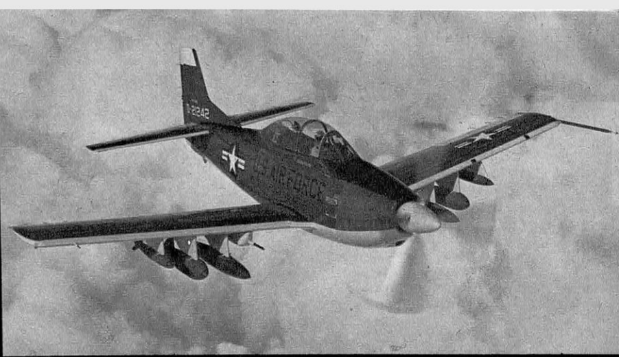
Destiné aux mêmes missions que le précédent et plus classique, le North-American YAT - 28 E adapté d'un appareil d'entraînement.
