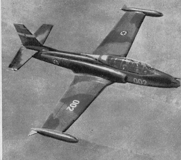
Biplace d'entraînement à réaction, le Soko Galeb de l'Armée de l'air yougoslave peut également recevoir des mitrailleuses, bombes et roquettes.
