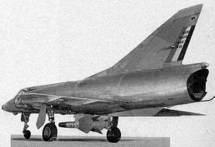
Un Mirage III est ici armé d'un missile Matra R-530 qui, propulsé par fusée à deux étages, atteint Mach 2,7 et porte à 18 km. Le missile peut être à autoguidage radar ou infrarouge.
