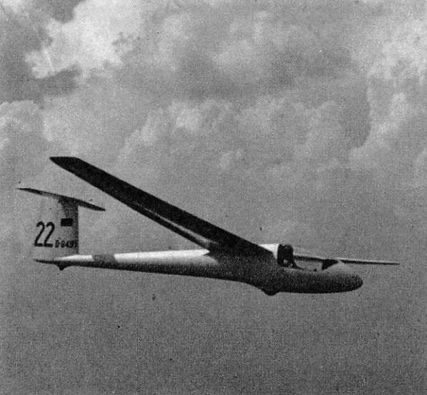
Le planeur Bolkow Phoebe, dont la structure monocoque est faite entièrement de sandwich balsa et fibre de verre, pèse quelque 350 kg.
