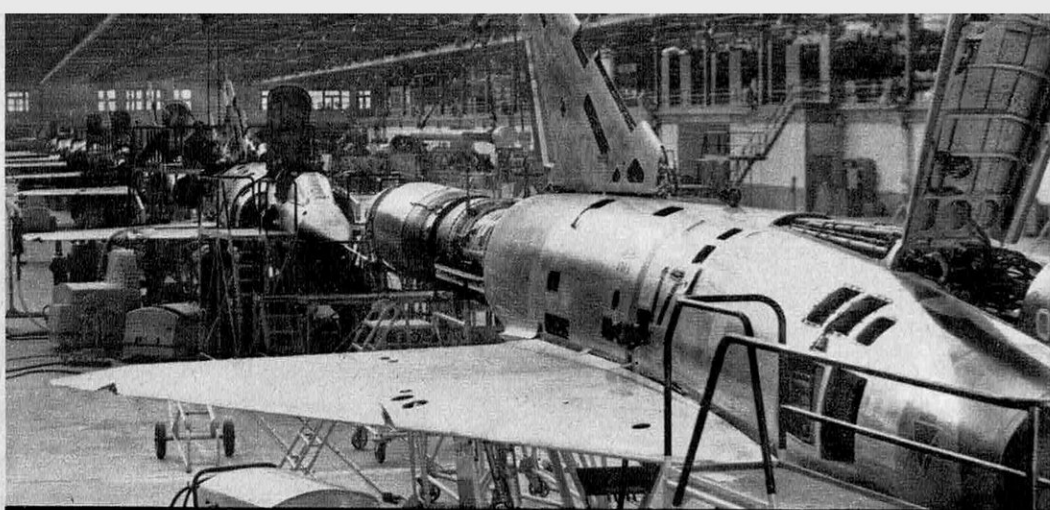
Chaîne de montage des intercepteurs Mirage III dans les ateliers de la G.A. Marcel Dassault.
