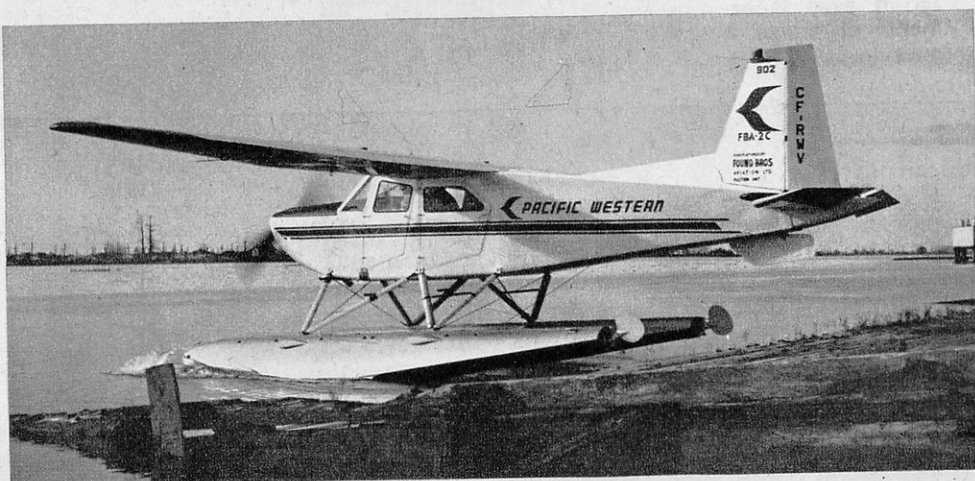
De construction entièrement métallique et de structure simple, le Found Brothers FBA-2C est un robuste quadriplace de 250 ch, conçu dans l'optique du travail aérien dans le Grand Nord.
