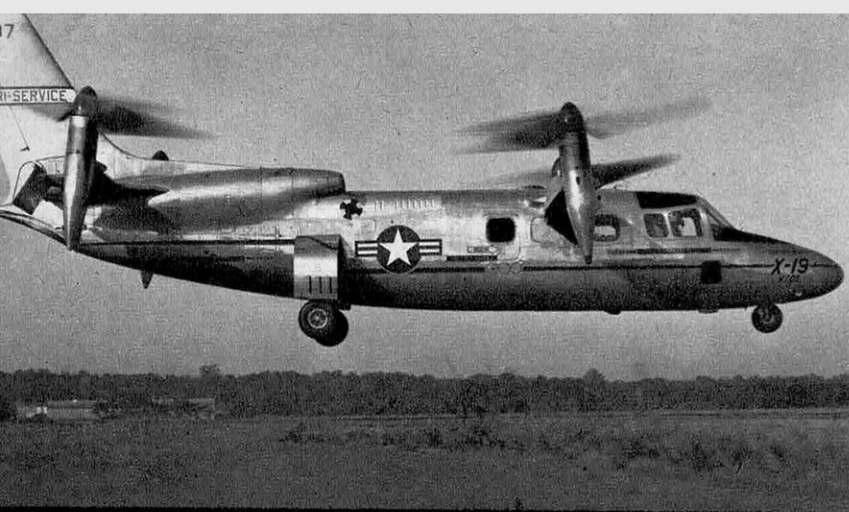
Equippé de turbopropulseurs basculants, le Curtiss-Wright X-19 décolle et atterrit verticalement. En vol horizontal, il dépasse 650 km/h.
