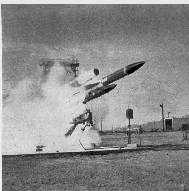
Le Redhead/Roadrunner est un engin-cible à statoréacteur capable de voler entre 90 et près de 20 000 m d'altitude avec des vitesses subsoniques ou supersoniques dépassant Mach 2.
