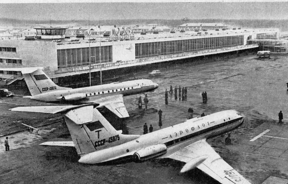
Le Tupolev 134, biréacteur moyen-courrier pour 70 passagers entrera prochainement en service sur les lignes de l'Aéroflot. Photo APN
