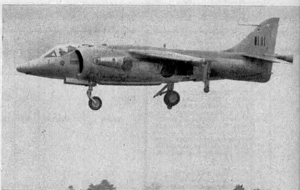
Le Kestrel, avion tactique dont le réacteur Pegasus assure le décollage vertical et la propulsion.
