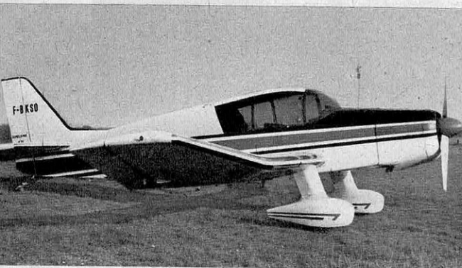
Construit par la Société Aéronautique Normande, le Jodel D-140 C Mousquetaire à moteur de 180 ch, quadriplace volant à 240 km/h.
