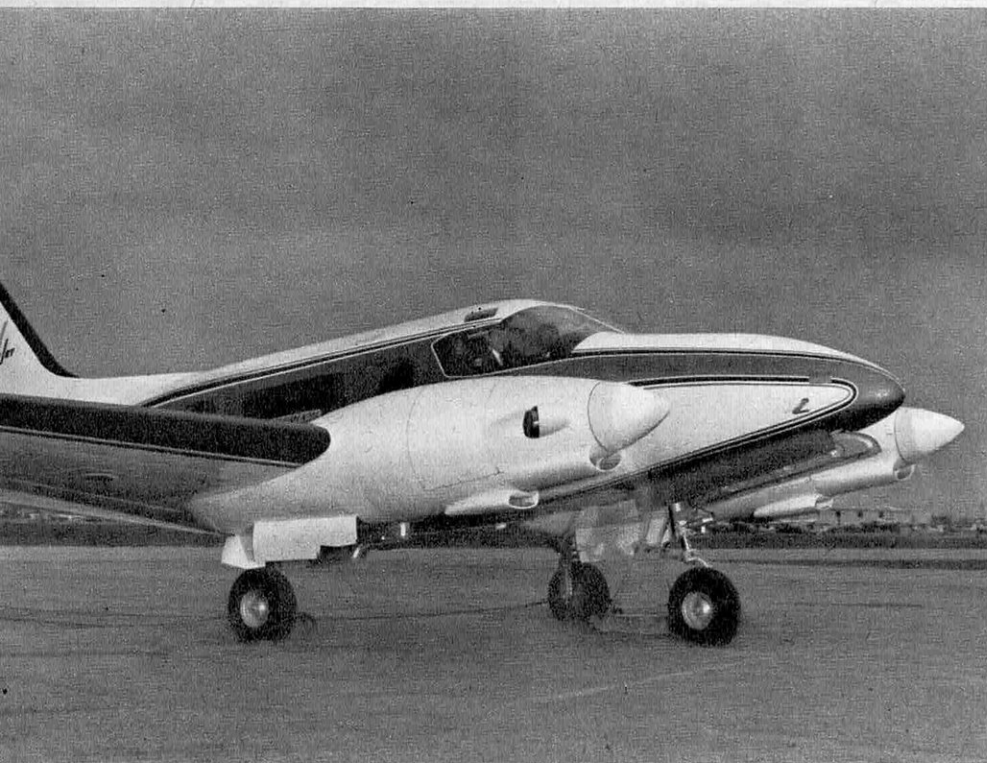
Le Beechcraft Model 18 est en production continue depuis plus de 25 ans, ce qui constitue un record. Pacific Air-motive lui a donné une nouvelle jeunesse en l'équipant de turbopropulseurs, d'un train tricycle et d'un nouvel empennage.
