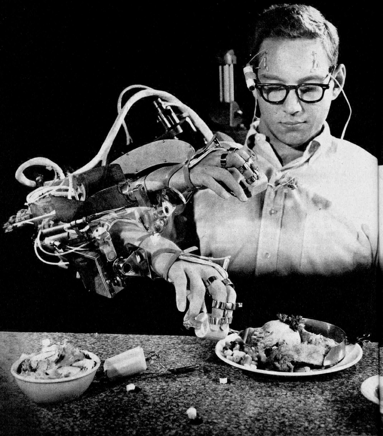
Une prothèse automatisée pour l'utilisation d'un bras paralysé, vue en double exposition. Plusieurs programmes de mouvements des éclisses mécanisées sont préenregistrés dans un calculateur, le choix étant fait par le sujet à l'aide d'une source infrarouge montée sur ses lunettes, et l'opération contrôlée par des contacteurs actionnés par ses sourcils. Des électrodes recueillent les tensions bioélectriques à l'épaule pour exciter les muscles des doigts.
