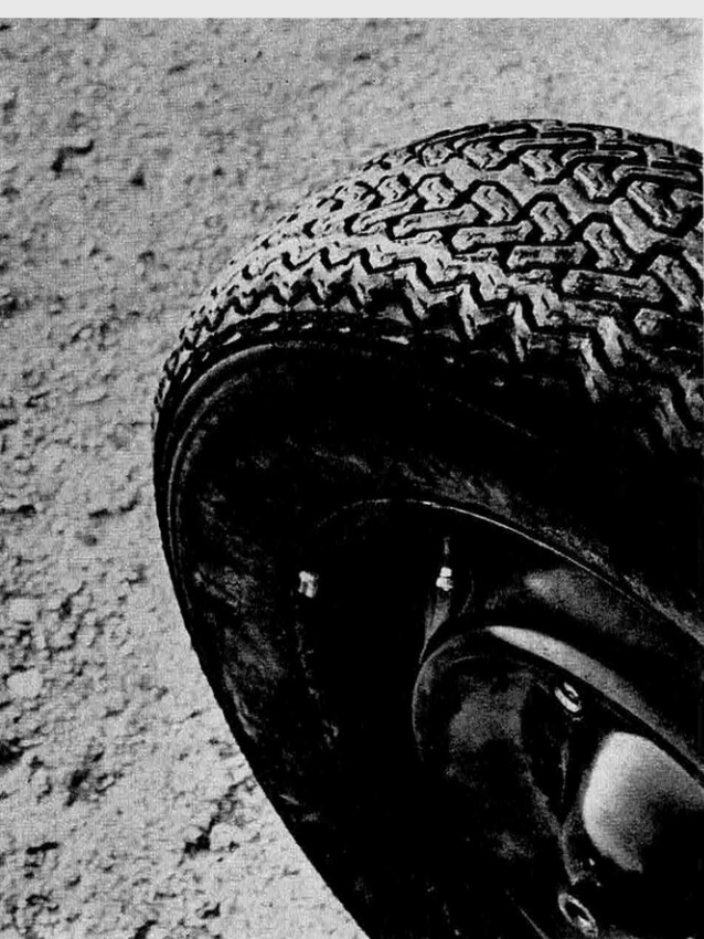
Offensive généralisée des pneus à carcasse radiale à large bande de roulement et bords arrondis : Dunlop (ici), Kléber-Colombes, Englebert, Firestone, Goodyear, Pirelli, Continental, Michelin.
