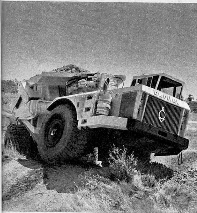
— La suspension s'ajoute à l'action du diablo pour permettre un effet important de « vrillage ».
