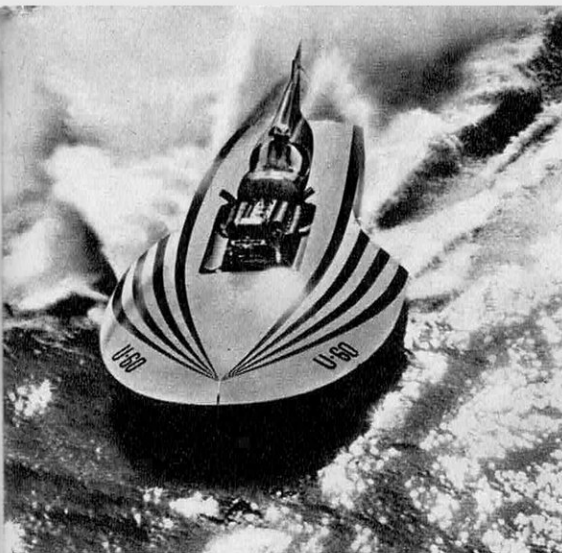
Une coque américaine de record type trois-points, avec moteur interne et dérive stabilisatrice.
