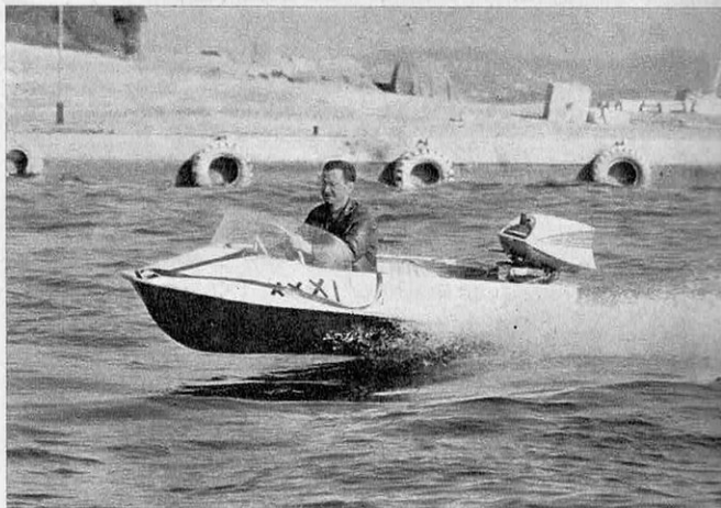
« Mobilo » de Adam, en duralinox. Sa légèreté lui permet d'être transporté sur les galeries de voitures. Avec 15 ch il se prête à l'initiation au ski nautique
