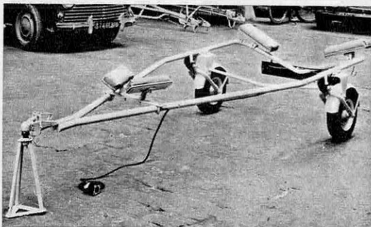
Remorque Portafлот type RP-S de 100 kg de charge utile, idéale pour les bateaux tels Vaurien, Mousse, etc.
