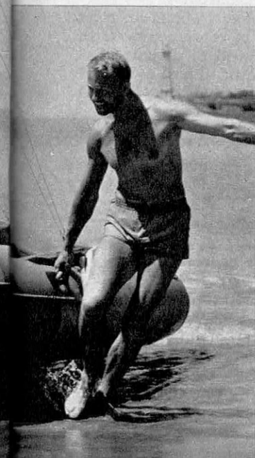
Le « Fan » de Meissonnier est un excellent dériveur d'initiation en plastique stratifié possédant un volume de flottabilité de 250 l. Sa voilure de 9,75 m 2 le rend assez rapide.
