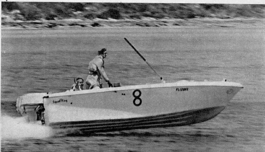
Coque « Bertram » type Ray Hunt, en V avec nervures qui s'est distinguée dans les courses Miami-Nassau.
