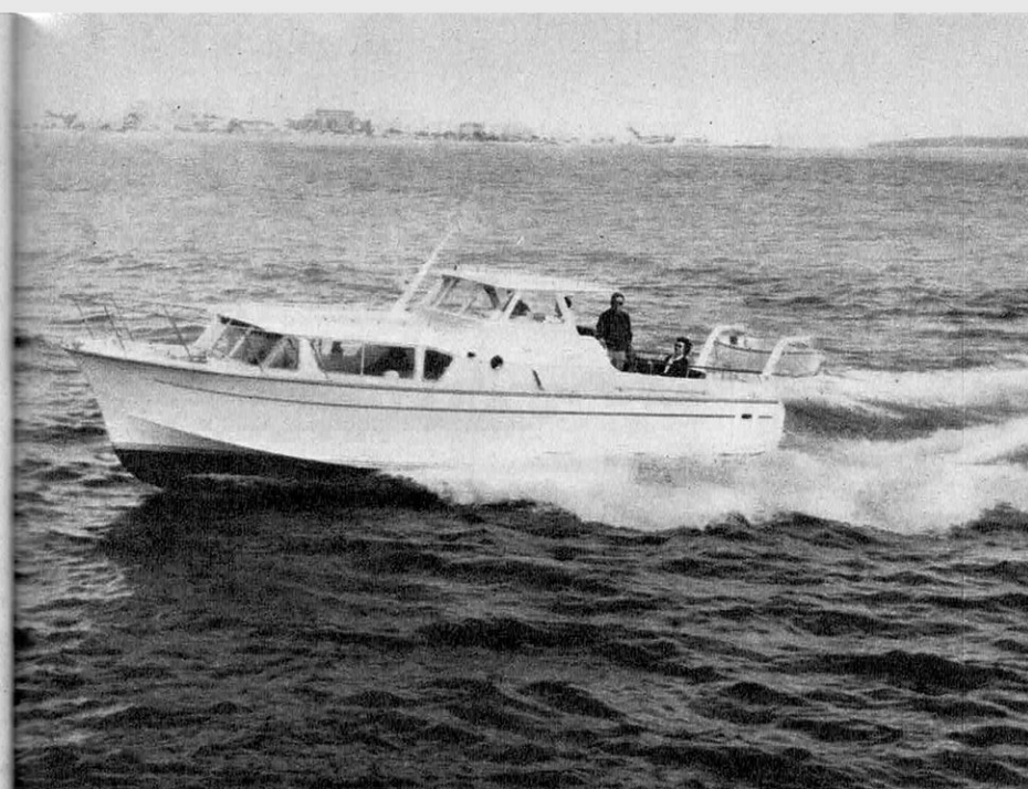
Le cruiser « Bora III » des Chantiers de l'Adriatique, importé par Liuzzi, bateau de haute mer de 9,10 m en plastique. Son installation comprend cuisine - dinette, douche, W.C., et des couchettes pour 4 à 5 passagers. Le tableau de bord ci-dessus commande 2 B.P.M. de 135 ch.
