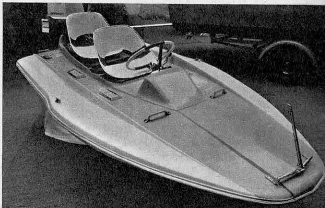
Kart bi-place de « Seb-Marine » présenté au dernier Salon Nautique de la Porte de Versailles. Construit en plastique stratifié, il existe aussi en version mono.
