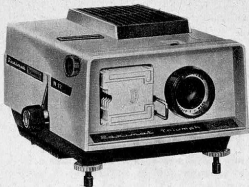
Paximat Triumph de Braun équipé d'une lampe 12 V, 100 W, objectifs interchangeables ouverts à 2,8, de 85 ou 100 mm. Paniers de 36 ou 50 diapositives, un dispositif est prévu pour le passage isolé des vues.
