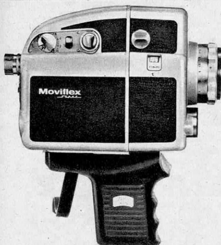
Moviflex Super, la plus perfectionnée des caméras Zeiss, automatique par cellule au sulfure de cadmium, zooming automatique, entraînement du film par moteur électrique, 16 et 48 images / seconde.
