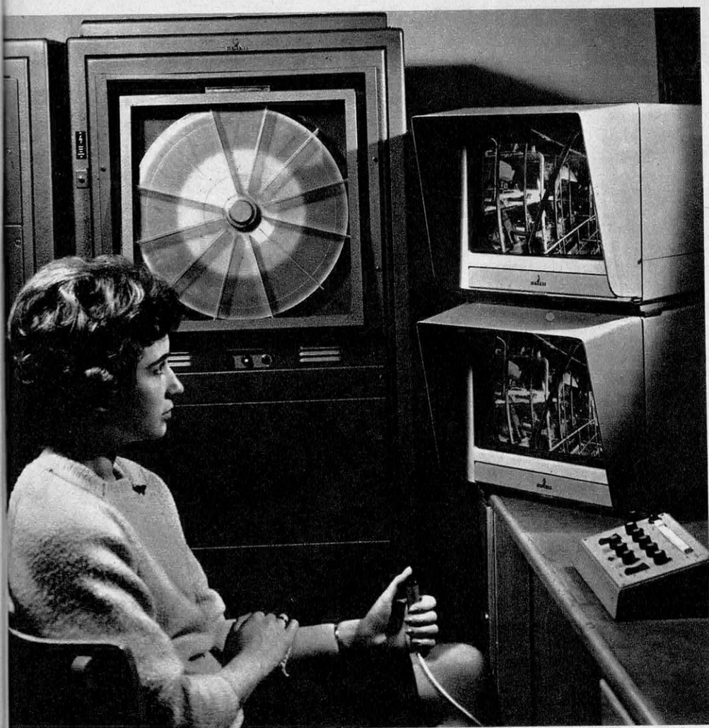
Une machine magnétique à disque de 40 cm de diamètre et qui tourne à 3 000 t/m n pour enregistrer et reproduire des scènes animées.
