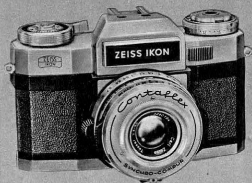
Contaflex Super B , réglage automatique du diaphragme après choix d'une vitesse de 1 à 1/500 s, réglage réalisé lisible dans le viseur; automatisme au flash après affichage du nombre guide sur l'appareil.
