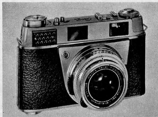
Retina III S Kodak à objectifs interchangeables; télémètre et cellule couplée visibles dans le viseur. L'obturateur Compur assure des vitesses allant de 1 seconde au 1/500 ainsi que la pose en un temps.
