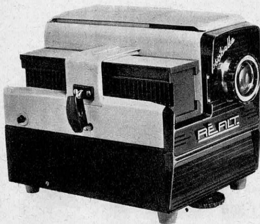
Le Réalt Isabelle reçoit les paniers Clasfix possédant un dispositif pour retenir les 36 vues, même lorsqu'on les retourne. Lampe 300 W; modèle à lampe 12 V, 150 W; objectif 3,5 de 100 mm; verre anticalorique.
