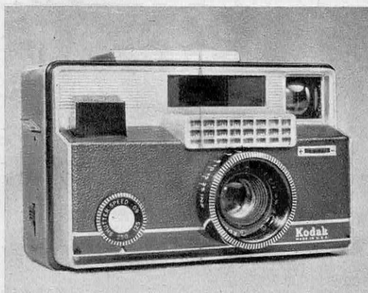
L'Instamatic Kodak 700 reçoit les chargeurs Kodapak. Une cellule règle les diaphragmes en fonction de la vitesse choisie, 1/30 à 1/250 de seconde. Pour obtenir des effets spéciaux, un compensateur est prévu.
