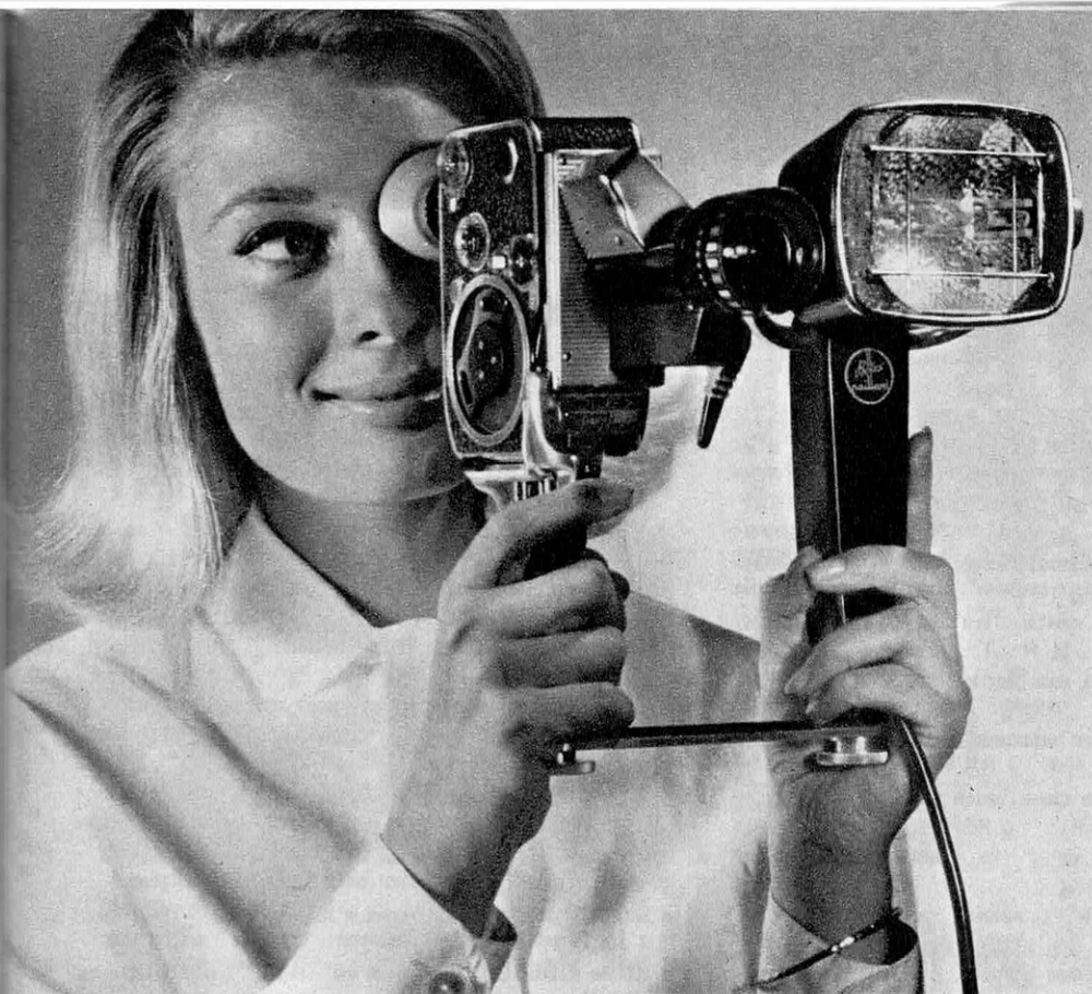
Lampe quartz-iode pour prises de vues d'intérieur, donnant une lumière d'intensité égale à celle de 3 lampes flood de 500 W, vie moyenne 12 heures, température de couleur 3 400° K et poids 600 g.
