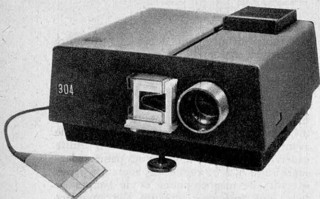
L'Automalik 304 comporte la télécommande pour passage des diapositives et mise au point. Il est monté avec lampe de 500 W, un zoom de 85 à 135 mm et peut recevoir des paniers contenant 30 à 60 vues.
