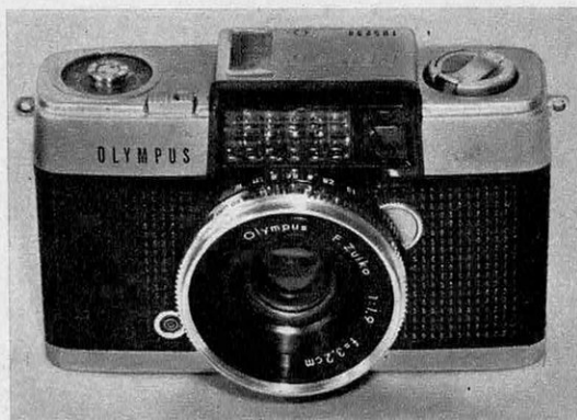
Appareil à cellule au sélénium incorporée pour des sensibilités de 10 à 400 ASA, l'Olympus Pen D est équipé d'un obturateur Copal X assurant des vitesses de 1/8 à 1/500 de seconde, et la pose en un temps.
