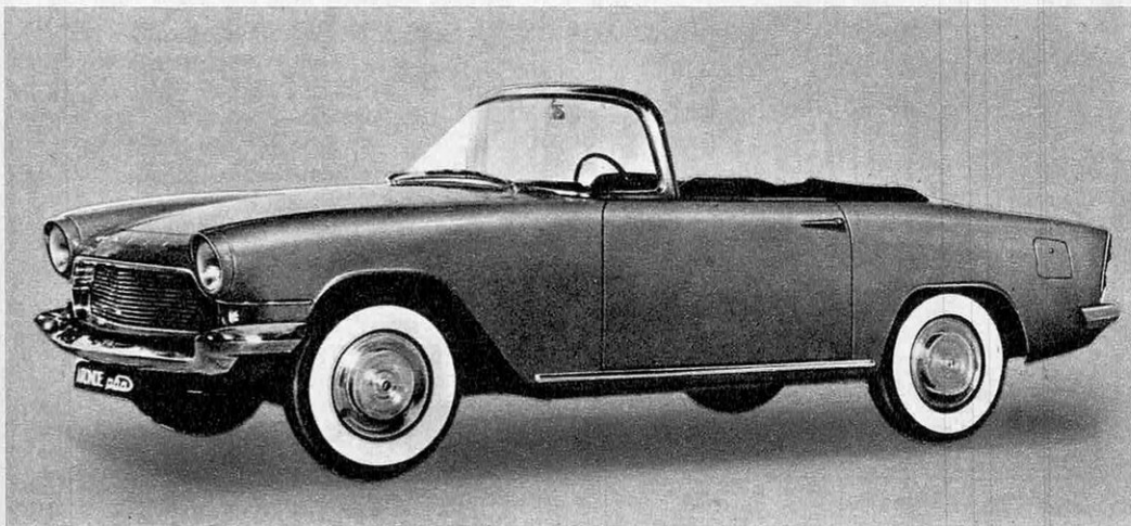
Sur les Simca « Plein Ciel » et « Océane », le pare-brise panoramique comportait des retours latéraux importants.
