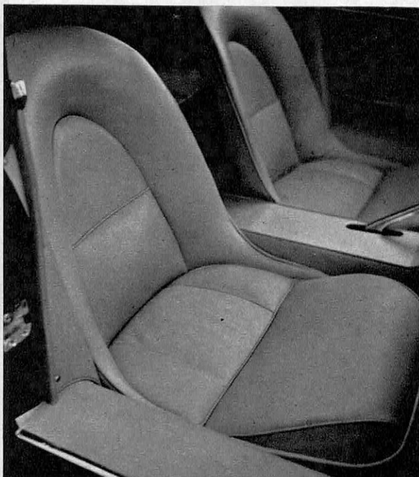
Sur la 1500 de Simca, deux sièges séparés, bien galbés, réglables en inclinaison comme en distance. Le revêtement est en drap et les flancs inférieurs (assez salissants) en plastique.
