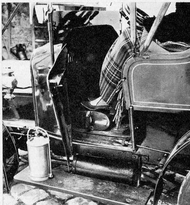
Sur cette Darracq de 1907, on utilisait une bouillote en cuivre rivé pour se chauffer en hiver.
