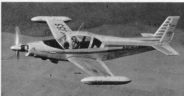
C'est un 5-places confortable dont insonorisation permet conversation et écoute radio par haut-parleur, chauffage, ventilation individuelle, sièges et pédales réglables, soute à bagages de 0,6 m 3 accessible de l'extérieur et en vol. Turbopropulseur Turboméca Astazon II. Poids total 1 800 kg. Vitesse max. palier : 500 km/h; de croisière 450 km/h; rayon d'action à 3 500 m : 2 020 km; décol. en 210 m; passage des 15 mètres : 410 m.
