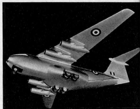
La maquette de l'appareil de transport militaire lourd actuellement à l'étude AW-681 en version S.T.O.L. (ci-dessous) avec quatre réacteurs Pegasus, et en version V.T.O.L. (à gauche) avec réacteurs de sustentation accrochés à l'aile.
