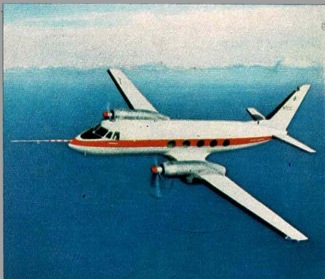
Le Grumman Gulfstream, équipé de 2 turbines Dart de 2 200 ch.
