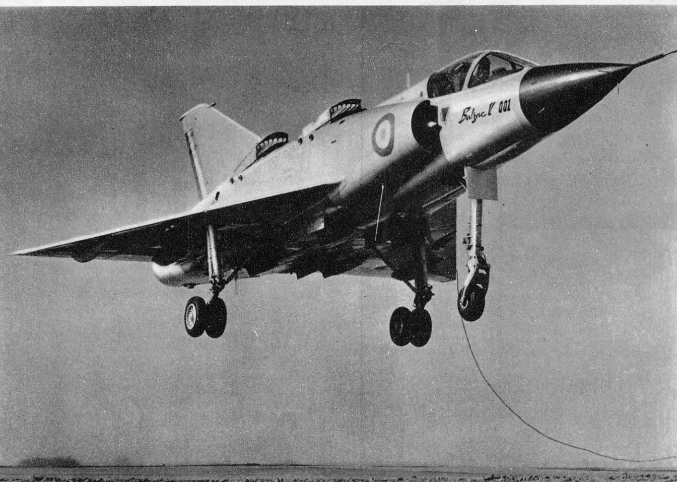
LE BALZAC, MONOPLACE EXPÉRIMENTAL, OUVRE LA ROUTE AU FUTUR MIRAGE III V.
