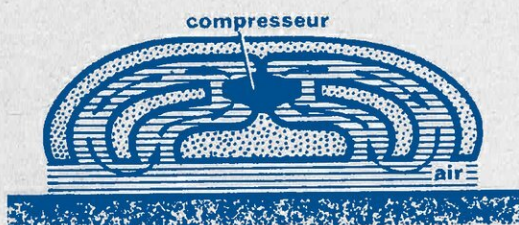
2. Appareil à jet périphérique avec recirculation d'air
