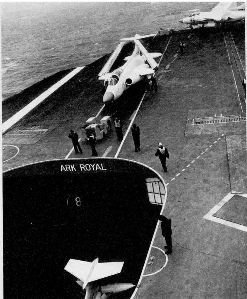
Le Blackburn Buccaneer que l'on voit ici, ailes repliées, sur le pont du porte-avions britannique Ark Royal est un chasseur-bombardier biréacteur capable de soutenir, au niveau de la mer, une vitesse voisine de celle du son. Il peut emporter un armement varié de bombes et d'engins y compris des engins à charge nucléaire.
