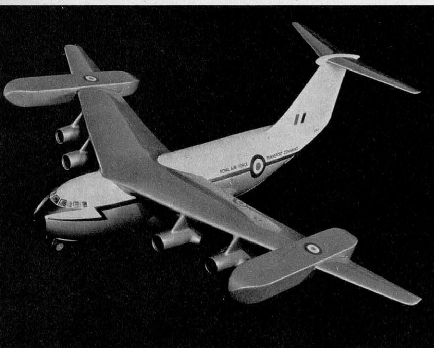
La maquette de l'appareil de transport militaire lourd actuellement à l'étude AW-681 en version S.T.O.L. (ci-dessous) avec quatre réacteurs Pegasus, et en version V.T.O.L. (à gauche) avec réacteurs de sustentation accrochés à l'aile.
