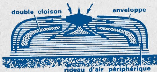
4. Appareil à rideau d'air (à double effet)
