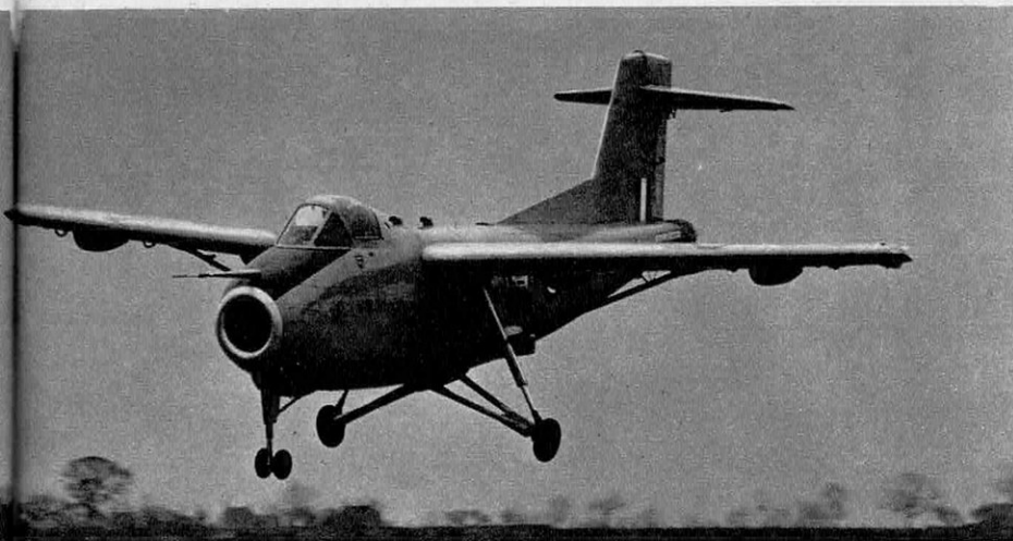
Le Hunting 126 expérimente une nouvelle formule de S.T.O.L. avec éjection des gaz au bord de fuite de l'aile.
