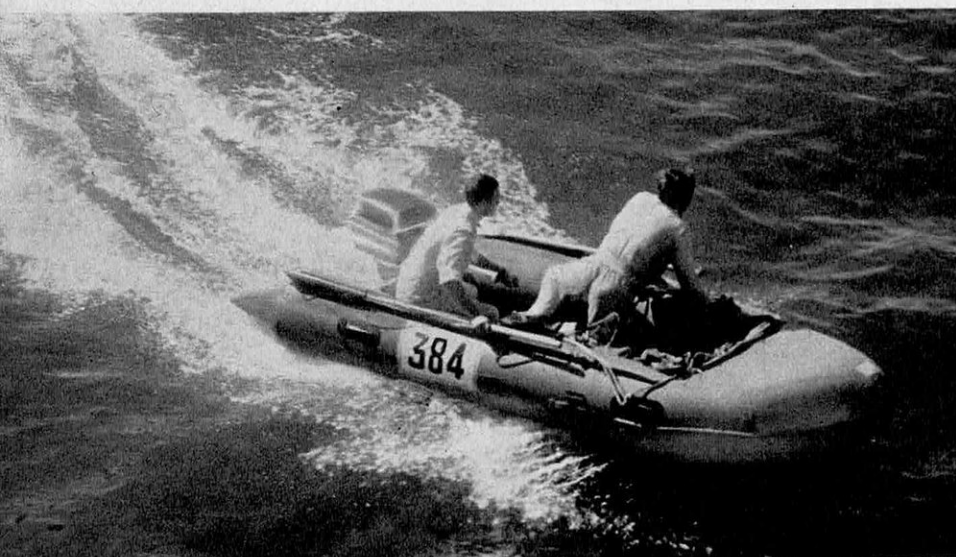
L'embarcation pneumatique supporte, selon sa taille, des moteurs hors-bord jusqu'à 75 ch. Elle peut s'agrémenter d'une voile et être utilisée comme bateau de sauvetage à l'occasion.
