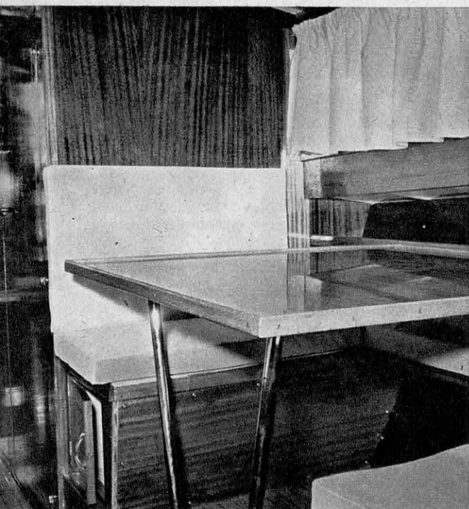
▲ Dans la vedette de 10,40 m BPL, le coin-repas se transforme en couchette double par abaissement de la table. La banquette se transforme pour sa part en une couchette. Matelas en caoutchouc mousse.
