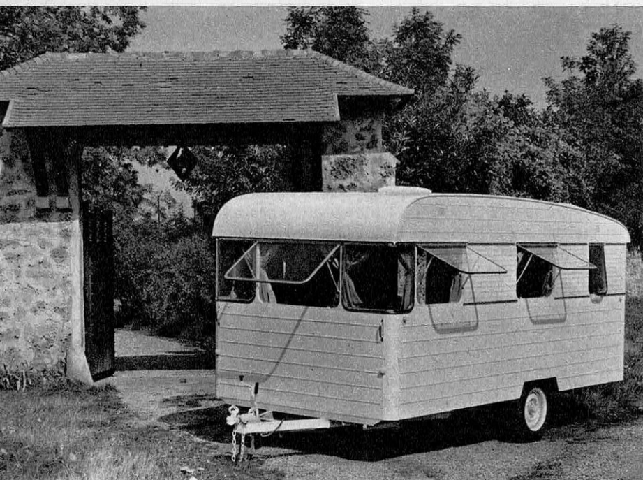
La « SUPER-CASTELAMIC », conçue pour le grand tourisme et l'habitation permanente comprend trois pièces indépendantes calorifugées avec cuisine en bout. Construction acier. Dimensions : 4,47 m \times 2,20 m. Poids à vide : 980 kg.
