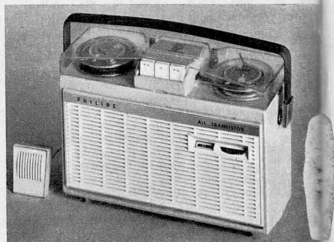
PHILIPS E L 3585. Magnétophone tout transistors, à piles, pour enregistrement et reproduction monophoniques avec bande magnétique à deux pistes. La bande passante va de 120 à 5 500 Hz pour une vitesse de défilement de la bande de 4,75 cm/seconde.
