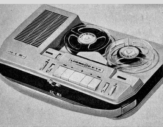
OPTACORD 412. Magnétophone portatif entièrement transistorisé alimenté par 5 piles sèches de 1,5 V avec possibilité de fonctionnement sur courant 110 ou 220 V. Enregistrement, quelle que soit la position, sur double piste au standard international.
