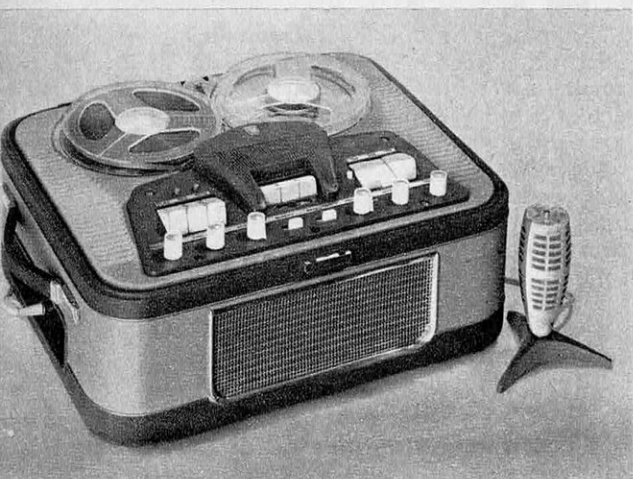
PHILIPS E L 3536. Magnétophone haute fidélité stéréo intégral, permet l'enregistrement et la reproduction monophonique ou stéréophonique avec bande magnétique à 4 pistes. L'un des haut-parleurs est incorporé au poste, l'autre est dans le couvercle.
