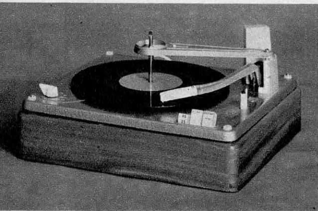
← TOURNE-DISQUES PHILIPS NG 2185/10 , à changeur à quatre vitesses. Automatique ou manuel, il est livré avec une tête stéréophonique AG 3063 ce qui lui permet aussi de servir pour les disques monophoniques; la tête est magnétodynamique.
