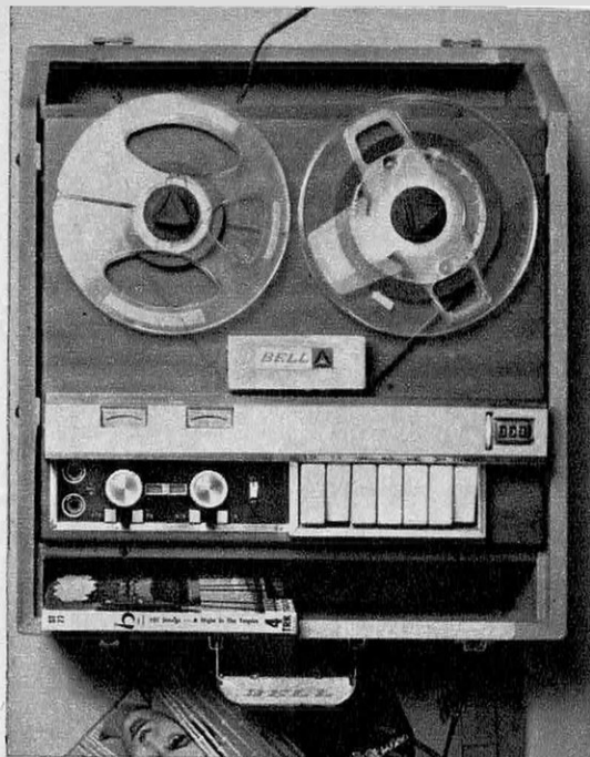
BELL STÉRÉO T337. Magnétophone transportable avec bande magnétique à 4 pistes. Il comprend un pré-ampli stéréo et la possibilité de régler indépendamment le niveau d'enregistrement sur chaque canal; cet appareil peut aussi fonctionner en monophonie.
