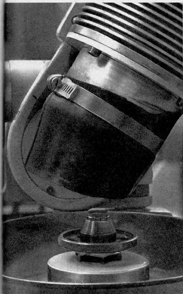
Ébauchage d'un verre avec meule diamantée.
