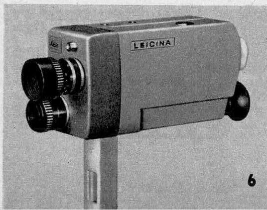
6 LEICINA 8 S. Visée reflex directe par déviation d'une faible partie des rayons lumineux vers le viseur; grossissement 15 de l'image; objectif Dygon F : 2 de 15 mm et compléments grand angle et téléobjectif; graduation photométrique du diaphragme pour tenir compte de la part de lumière prélevée par le viseur. Exposition du film automatique par cellule photorésistante couplée au diaphragme; piles à oxyde de mercure (2 ans); sensibilité de 6 à 400 ASA; possibilité de fondus. Prix avec optiques de 15 et 9 mm : 1 327 NF.
