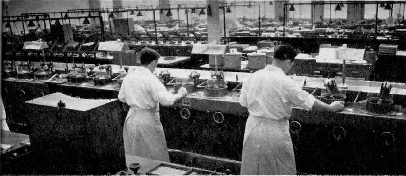
L'atelier polissage à la machine sur verres optiques.
