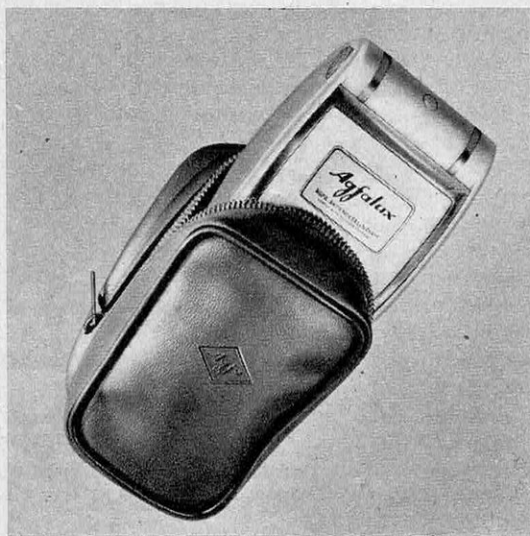
← AGFALUX : petit flash entièrement repliable, avec condensateurs et pile de 22,5 volts. Une fois replié et placé dans son étui de matière plastique, il est de la taille d'un porte-monnaie. Prix : 56 NF.
