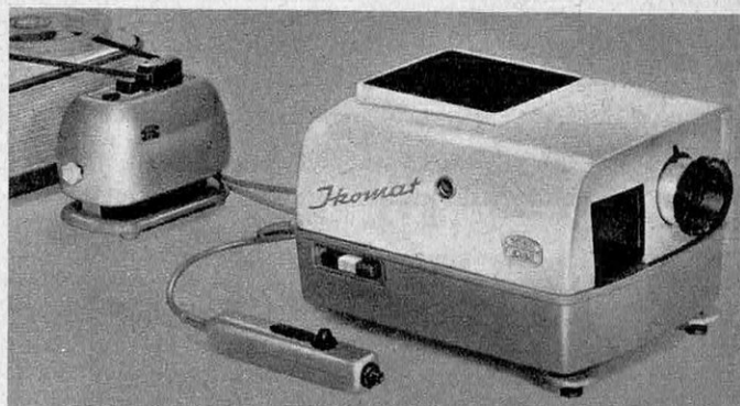
IKOMAT ZEISS ET DIATAKT. Projecteur automatique pour vues 24 \times 36 ou 4 \times 4 ; lampe de 300 ou 500 W ; objectif Diatar F : 2,5 de 100 mm. Le Diatakt permet la synchronisation des vues avec une bande magnétique. Prix de l'Ikomat : 1 093 NF.
