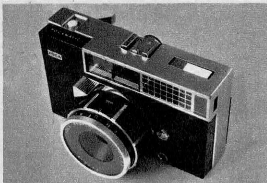
LE FOCAMATIC. Appareil 24 × 36 automatique ; objectif Néoplar F : 2,8 de 45 mm. La mise au point se fait par échelles métriques ou symboles. Une cellule détermine la combinaison correcte diaphragme-vitesse (du 1/250 à F : 22 au 1/30 sec. à F : 2,8). Viseur collimaté ; prise de flash. Prix 460 NF.
