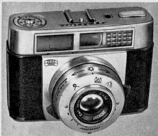
LE SYMBOLICA. Appareil Zeiss-Ikon muni d'un objectif Tessar F : 2,8 de 45 mm et d'un obturateur Prontomat. Le semi-automatisme est obtenu en amenant dans le viseur l'aiguille au milieu du champ. Le viseur est collimaté et le réglage des distances se fait sur 3 symboles : portrait, groupe ou paysage. Il est muni d'une synchronisation pour flash. De nombreux accessoires sont possibles. Prix : 645 NF.
