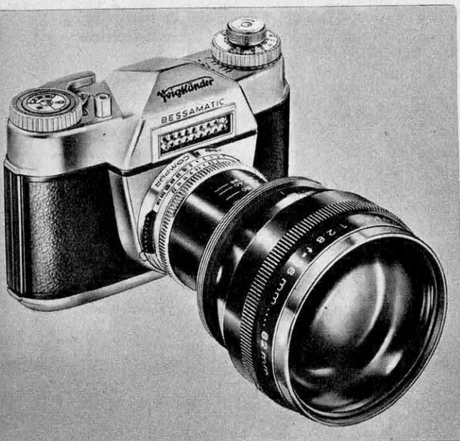
← LE ZOOMAR VOIGTLANDER. Premier objectif à focale variable destiné à la photo 24 × 36. Monté ici sur le Bessamatic, il peut équiper d'autres appareils. F : 2,8 de 36 à 82 mm avec diaphragme à présélection automatique ; de 1,30 m à l'infini.
