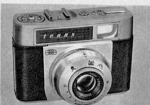
LE TENAX AUTOMATIC. Appareil Zeiss à objectif Tessar F : 2,8 de 50 mm et automatisme intégral : il suffit de presser un bouton pour obtenir une photographie correctement posée. Mise au point des distances par symboles : portrait, groupe, paysage. Prise de flash sans câble. Prix : 765 NF.
