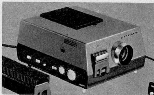
DIAMATOR M. Projecteur automatique pour vues 24 \times 36 ou 4 \times 4 . Commande possible par ultrasons avec dispositif télépiff T 40. Objectif Agomar F : 2,5 de 85 mm, 2,5 de 100 mm et 2,8 de 150 mm ; possibilité de synchronisation avec magnétophone.
