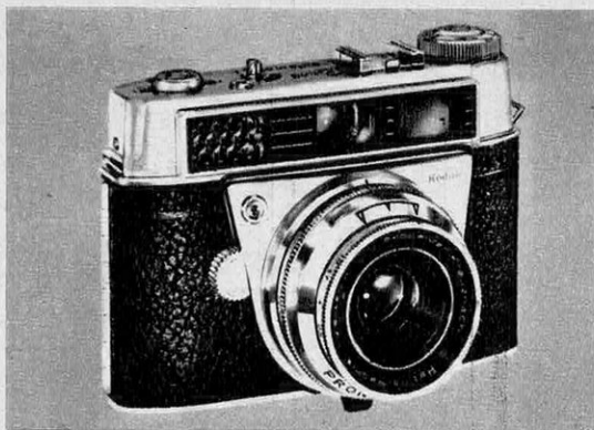
LE RETINA AUTOMATIC I. Appareil Kodak à objectif Reomar F : 2,8 de 45 mm ; obturateur Pronormat S avec pose B ; prise de flash ; viseur collimaté et à correction de parallaxe ; automatisme total ; blocage du déclencheur et signal stop en cas de lumière insuffisante ; armement rapide. Prix : 595 NF.
