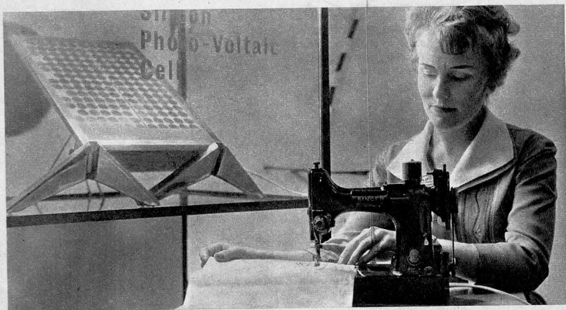
CETTE MACHINE A COUDRE électrique exposée par Singer à Londres, reçoit l'énergie solaire sur une batterie de 144 cellules photovoltaïques au sélénium. Elle a effectivement fonctionné en Grèce et aux U.S.A.
