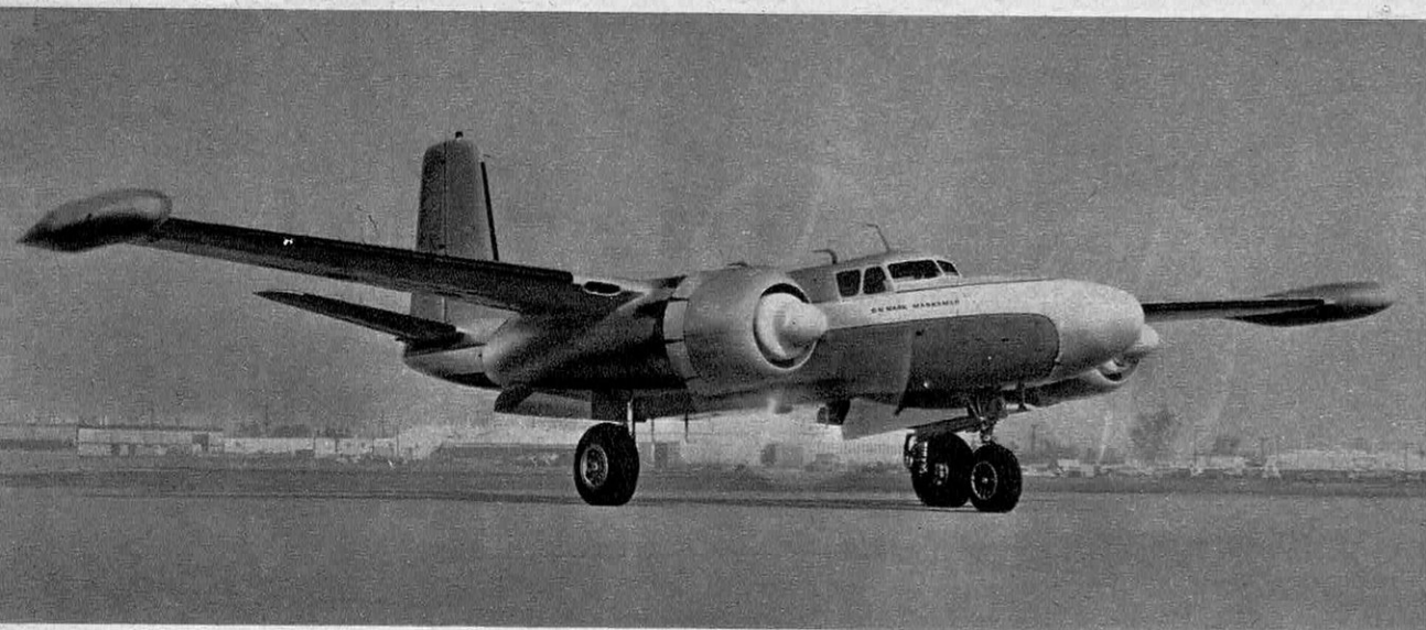
LE MARKSMAN DE ON MARK est un bombardier Douglas B-26 transformé en avion d'affaires avec l'équipement le plus perfectionné. Avec 2 hommes d'équipage, il loge 7 passagers en cabine pressurisée.
