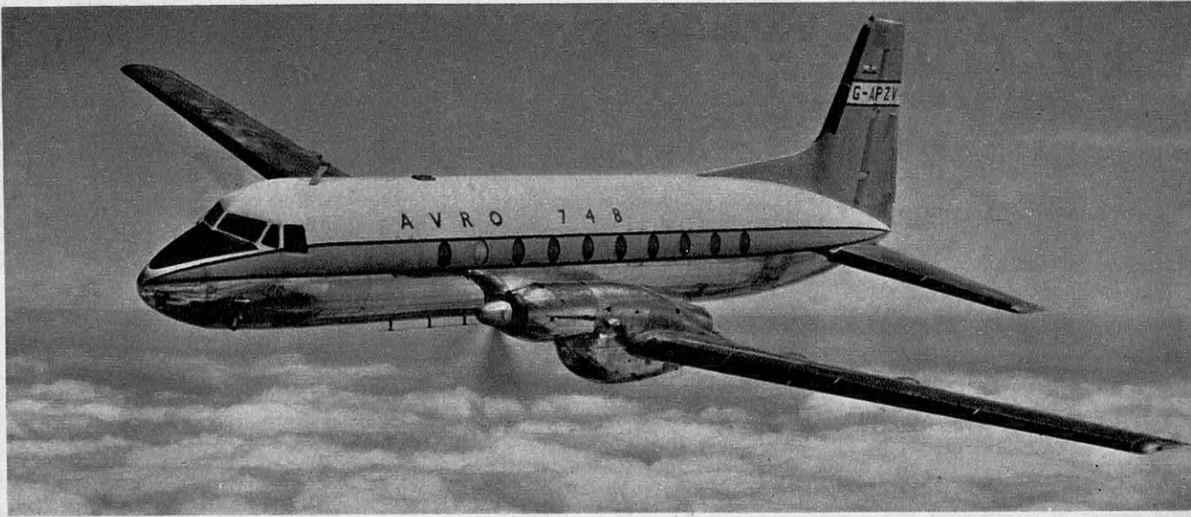
LE RÉCENT AVRO 748 A TURBOPROPULSEURS existe en version affaires pour 8 à 20 passagers en cabine conditionnée et pressurisée. Son rayon d'action est de 3 600 km et une cuisine y est aménagée.
