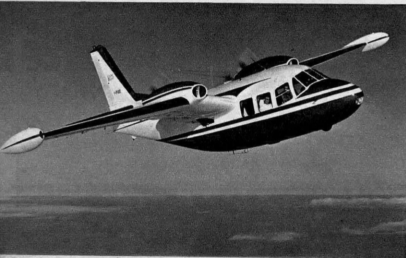
LE PIAGGIO P-166 , bimoteur d'affaires à 6 places avec bar, toilette et vaste soute à bagages, a une vitesse de 300 km/h. Autonomie 800 km.
