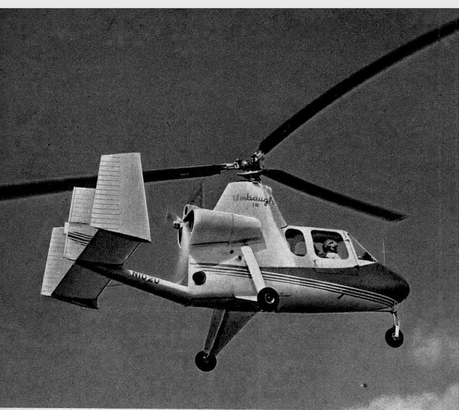
← LE UMBAUGH 18 est un autogire léger biplace en tandem avec double commande, qui peut recevoir des aménagements type affaires ou être équipé pour les traitements agricoles. Fairchild doit en construire 10 000 exemplaires d'ici fin 1962.
