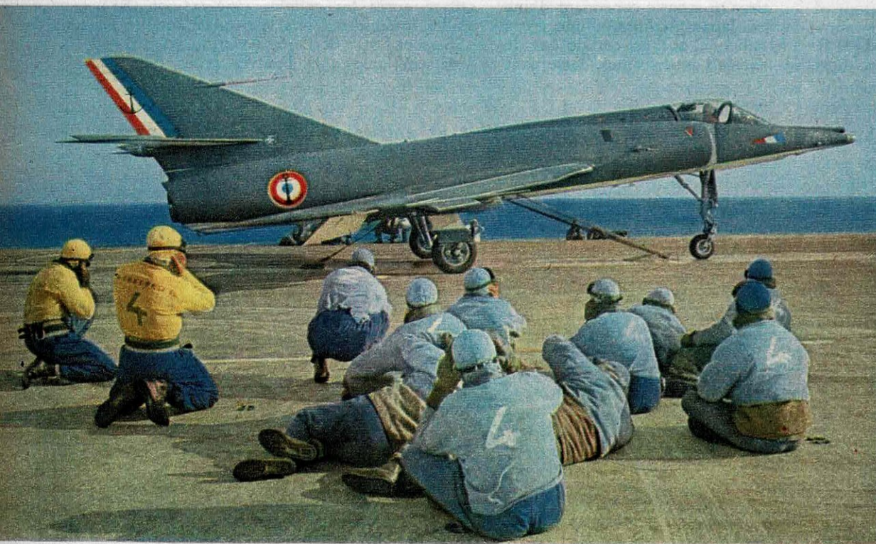
Le Dassault Étendard IV M, monoplace embarqué d'interception et d'attaque
