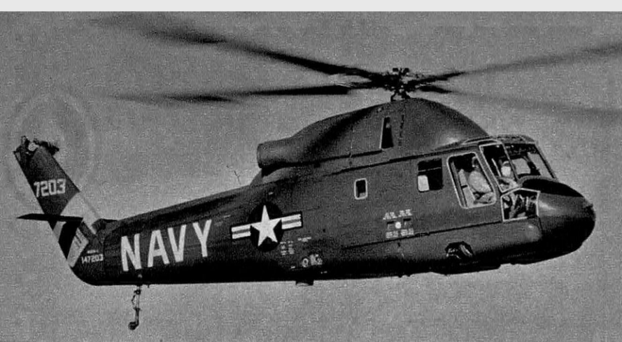
← LE HU-2 K SEASPRITE de Kaman est un hélicoptère rapide qui entrera en service dans l'U.S. Navy en 1961. Il est apte à remplir les missions les plus diverses : transport de personnel, (13 hommes), transport de fret accroché extérieurement à la cabine, ambulance, sauvetage, reconnaissance, détection et attaque des sous-marins.
