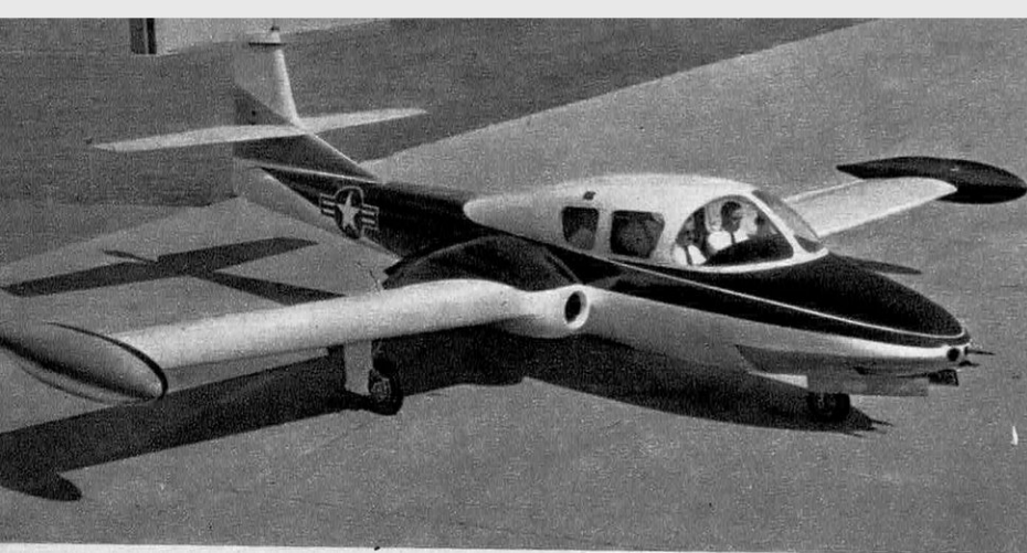
← LE CESSNA 407 , quadriplace à cabine pressurisée dérivé de l'appareil d'entraînement T-37, est équipé de deux turboréacteurs Continental J-69 de 635 kg de poussée. Il vole à 726 km/h.
