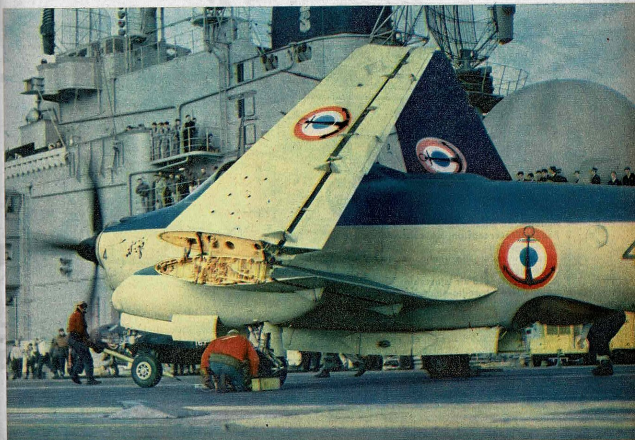
Le Breguet Alizé, ailes repliées pour le stockage sur porte-avions
